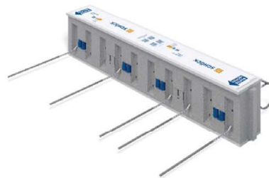
Abb. A.6: Schöck Isokorb® Typ Q für gestützte Balkone, beispielhaft Querkraftstab mit abgeogenem Stabende auf der Deckenseite (alternativ mit geradem Stabende auf der Deckenseite)
