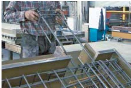
Abb. 1: Treppe schalen, Typ Z Part T einsetzen
