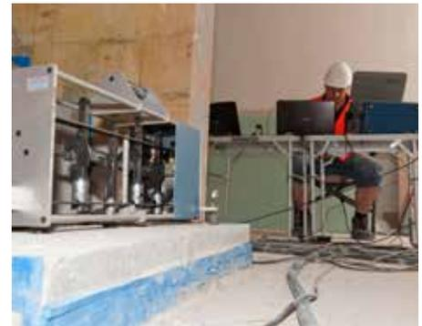
Eingebaute Treppe wird mit Norm-Hammerwerk angeregt.
