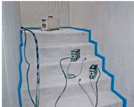
Eingebaute Treppe wird mit Norm-Hammerwerk angeregt.
