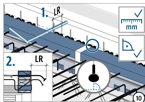
1. Krümmungsebene der Zugstäbe genau lotrecht einstellen, damit alle Ankerteller in ihrem Tiefpunkt liegen! 2. Einbindelänge LR gemäß Typenetikett prüfen!
