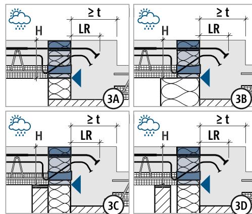
Innenkante Isokorb® direkt an Außenkante Überzug setzen.
