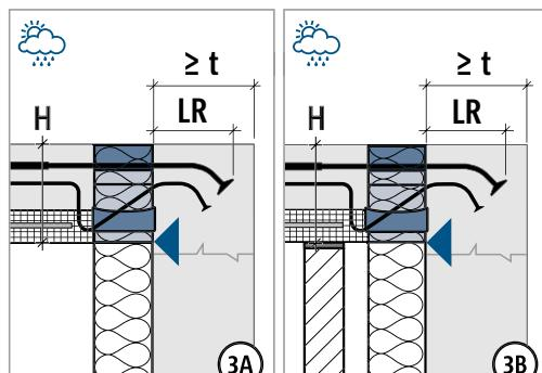
Innenkante Isokorb® direkt an Außenkante Wand setzen.
