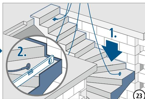
Nach dem Einbau des Wandelements Tronsole® Typ Q Part W ist die Höhenlage der Treppe durch druckfeste **Ausgleichplatten** (z. B. aus Stahl, Mindestgröße 160 × 110 mm) zu justieren.
