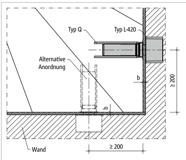
Abb. 88: Schöck Tronsole® Typ Q: Elementanordnung, Detail A, Fugenbreite  $b = 15 \text{ mm}$  bei Ortbeton, bei Fertigteiltreppenläufen ist die Notwendigkeit einer zusätzlichen Einbautoleranz durch den Planer zu prüfen
