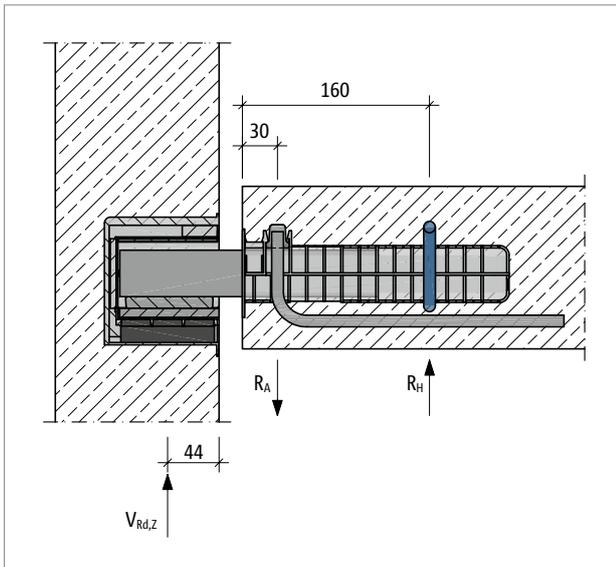
Abb. 100: Schöck Tronsole® Typ Q: Bauseitiger Hutbügel eingefärbt
