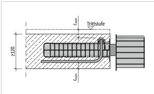
Abb. 81: Schöck Tronsole® Typ Q: Einbau bei Plattendicke  $h = 120$  mm erfordert die Einbeziehung des Betons der Trittsstufe zur Ermöglichung der Betondeckung  $c_{nom}$
