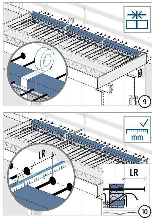
Einbindelänge LR gemäß Typenetikett prüfen!
