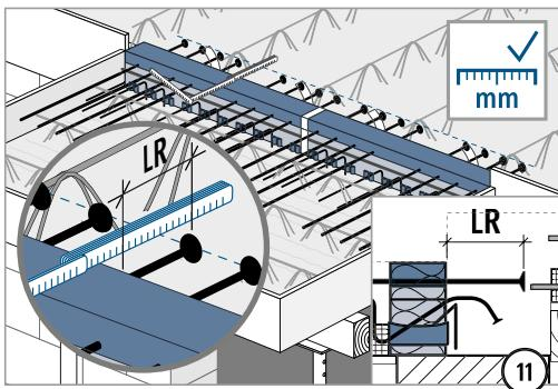
Einbindelänge LR gemäß Typenlabel prüfen!
