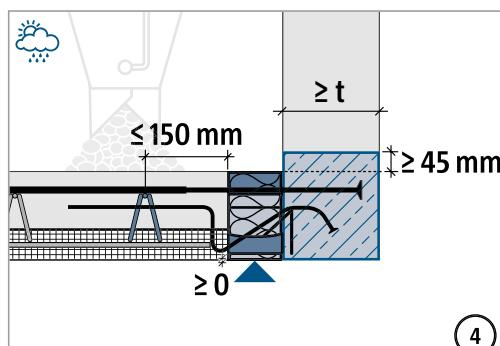
Im markierten Bereich keine Arbeitsfuge, weder horizontal noch vertikal. Den markierten Bereich in einem Guss betonieren!
