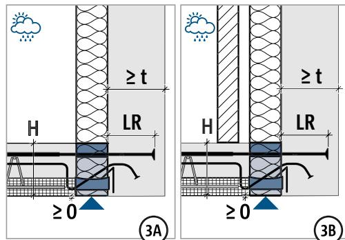
Unterkante Isokorb® gleich oder über Unterkante Wand setzen.
