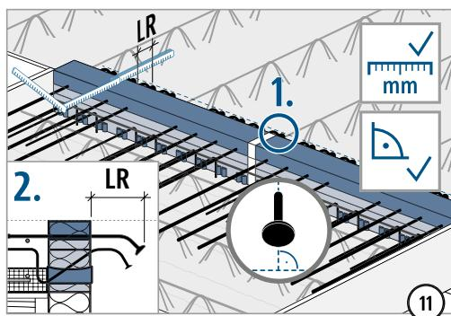
1. Krümmungsebene der Zugstäbe genau lotrecht einstellen, damit alle Ankerteller in ihrem Tiefpunkt liegen! 2. Einbindelänge LR gemäß Typenettikett prüfen!
