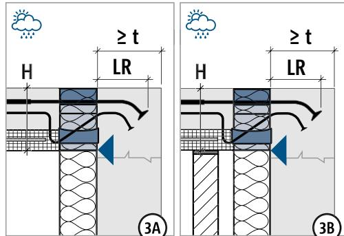
Innenkante Isokorb® direkt an Außenkante Wand setzen.
