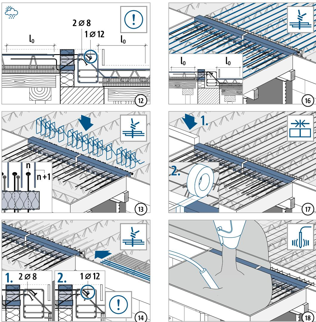
Zulagestäbe mit  $\varnothing \geq 8$  mm an Kreuzungspunkte anbinden. Zulagestab mit  $\varnothing \geq 12$  mm direkt an Zugstab mit Ankerkopf anbinden!
