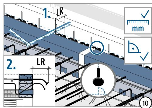
1. Krümmungsebene der Zugstäbe genau lotrecht einstellen, damit alle Ankerteller in ihrem Tiefpunkt liegen! 2. Einbindelänge LR gemäß Typenlabel prüfen!
