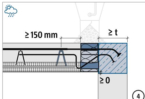
Im markierten Bereich keine Arbeitsfuge, weder horizontal noch vertikal. Den markierten Bereich in einem Guss betonieren!
