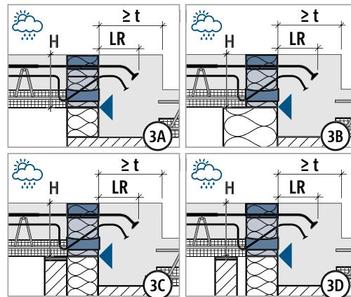
Innenkante Isokorb® direkt an Außenkante Überzug setzen.
