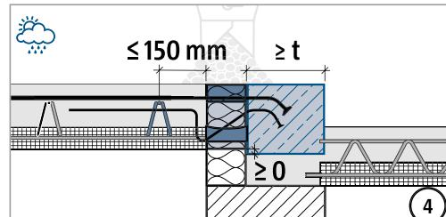
Im markierten Bereich keine Arbeitsfuge, weder horizontal noch vertikal. Den markierten Bereich in einem Guss betonieren!
