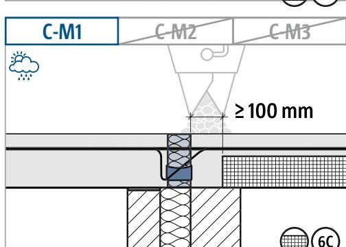
6A–6C: Druckfuge unbedingt mit Ortbeton verfüllen! Fugenbreite  $\geq 100$  mm.
