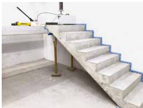
Realitätsnaher Prüfaufbau nach SN EN 17823
