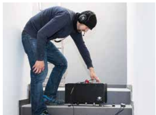
Trittschallmessung mittels Normhammerwerk
