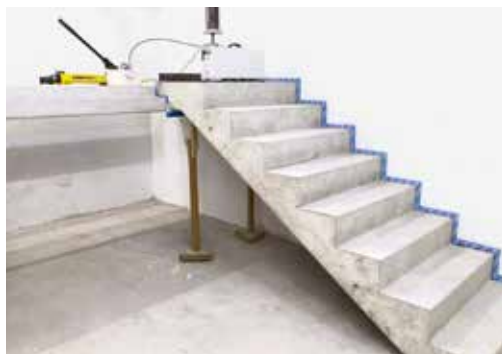
Configuration de test proche de la réalité et conforme selon la norme SN EN 17823.
