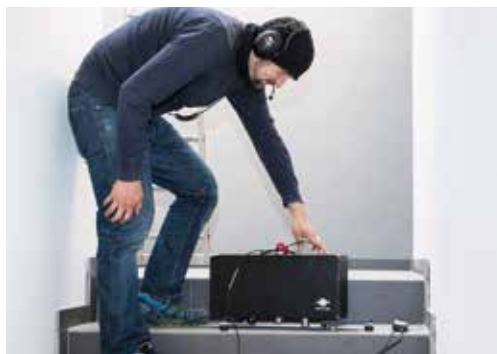
Mesure du bruit de choc au moyen d'un broyeur à marteaux standard.
