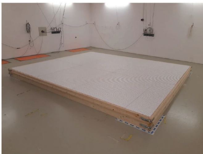
Abbildung 3 Prüfaufbau exemplarisch (Mithilfe der Markierungen wurde gewährleistet, dass der Rahmen über die Messreihe hinweg die gleiche Position behält)
