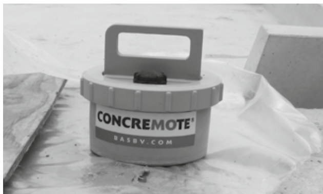
Geplaatst Concremote® systeem
