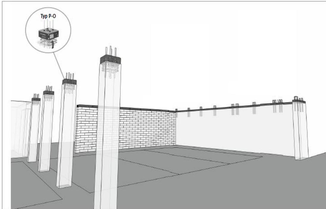
Sconnex® Typ P-O im Einsatz bei Unterdeckendämmung
