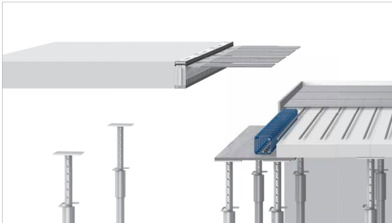
Фиг. 42: Schöck Isokorb® T тип KL: Подготовка на кофража и арматурката за поставянето на предварително изработени плочи с бетониран T тип KL
