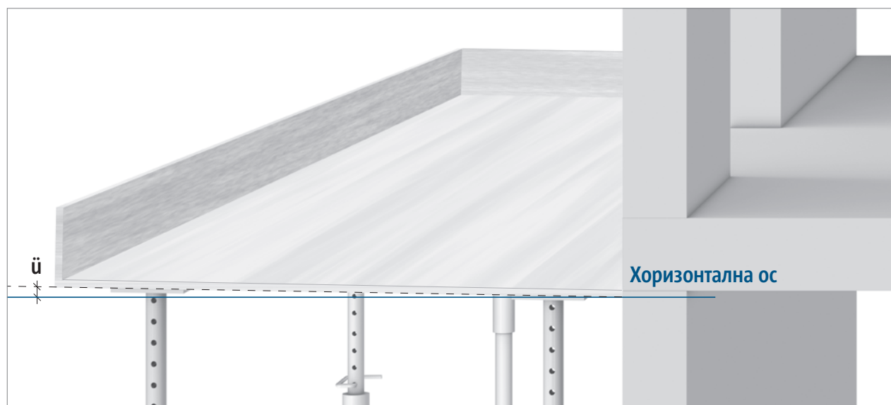
Фиг. 20: Надвишаване на кофража при бетониране
