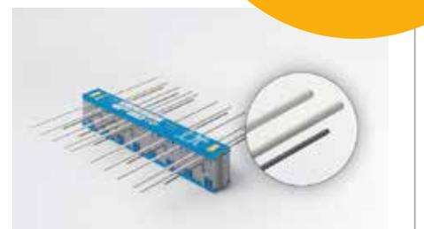
Die Zugstäbe aus Glasfasermaterial machen den Schöck Isokorb® XT-Combar zum besten Wärmedämmelement auf dem Markt. Im Ingenieurbau wird er wegen seiner chemischen Resistenz und Dauerhaftigkeit als Bewehrungsstab verwendet. Als Schöck Isolink® dient er der Fassadenbefestigung und ist die energieeffiziente Alternative bei der Verbindung der Betonschalen von kerngedämmten Sandwich- und Elementwänden.
