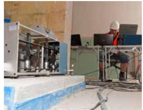
Eingebaute Treppe wird mit Norm-Hammerwerk angeregt.
