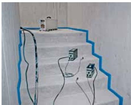
Eingebaute Treppe wird mit Norm-Hammerwerk angeregt.
