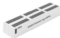
Tragendes, wasserabweisendes Wärmedämmelement zur Vermeidung von Wärmebrücken bei Mauerwerkswänden. Das Element überträgt vornehmlich Druckkräfte.
