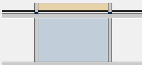
Ondergrondse garage/kelder: isolatie boven de plaat
