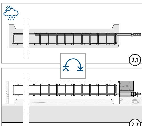
Vor dem Einlegen der Zugstäbe sicherstellen, dass alle Muttern vollständig bis zum inneren Gewindeende aufgedreht sind.
