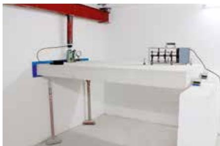
Expertise de Tronsole® type Z et type L pour la mesure du palier.
