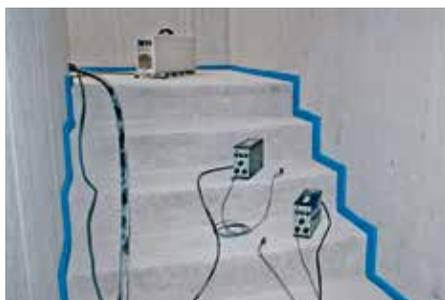
L'escalier monté est frappé au moyen d'une machine à chocs normalisée.
