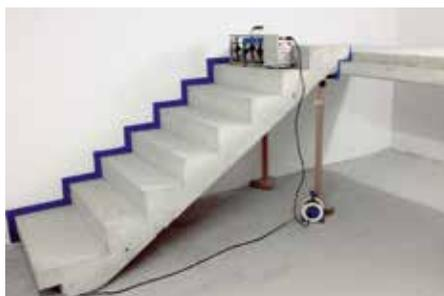
Expertise de Tronsole® type BZ et type L pour la mesure de la volée.
