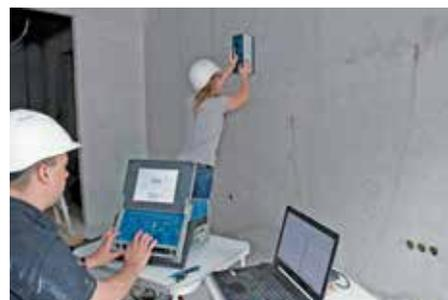
Mesure du temps de réverbération sonore du mur de la cage d'escalier.
