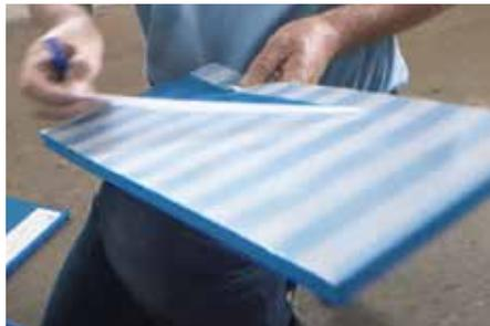
Fig. 7 : retirer le film adhésif du type L et coller
