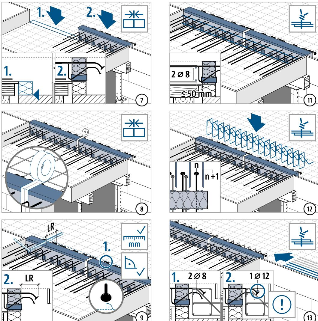
1. Krümmungsebene der Zugstäbe genau lotrecht einstellen, damit alle Ankerteller in ihrem Tiefpunkt liegen! 2. Einbindelänge LR gemäß Typenetikett prüfen!
