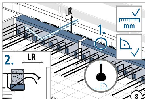
1. Krümmungsebene der Zugstäbe genau lotrecht einstellen, damit alle Ankerteller in ihrem Tiefpunkt liegen! 2. Einbindelänge LR gemäß Typenentikett prüfen!
