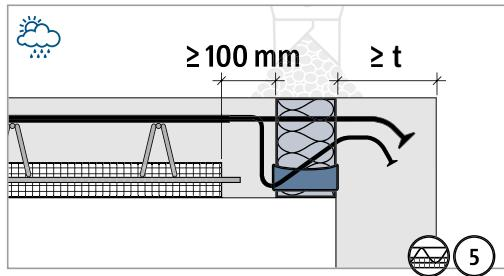
Druckfuge unbedingt mit Ortbeton verfüllen!
