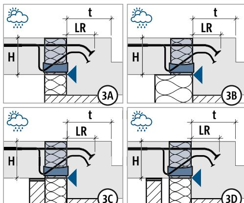
Innenkante Isokorb® direkt an Außenkante Überzug setzen.
