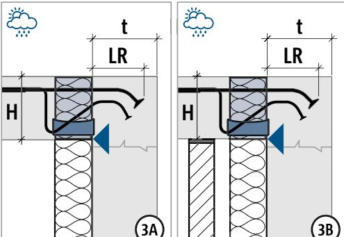
Innenkante Isokorb® direkt an Außenkante Wand setzen.
