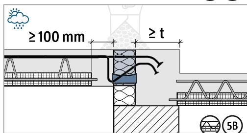
Druckfuge unbedingt mit Ortbeton verfüllen!
