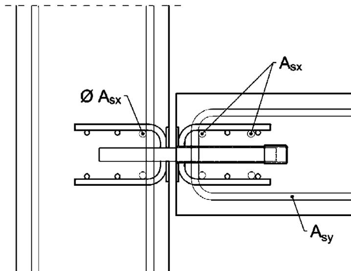
Abb. 8: Bewehrungsanordnung für den Anschluss Wand-Decke
