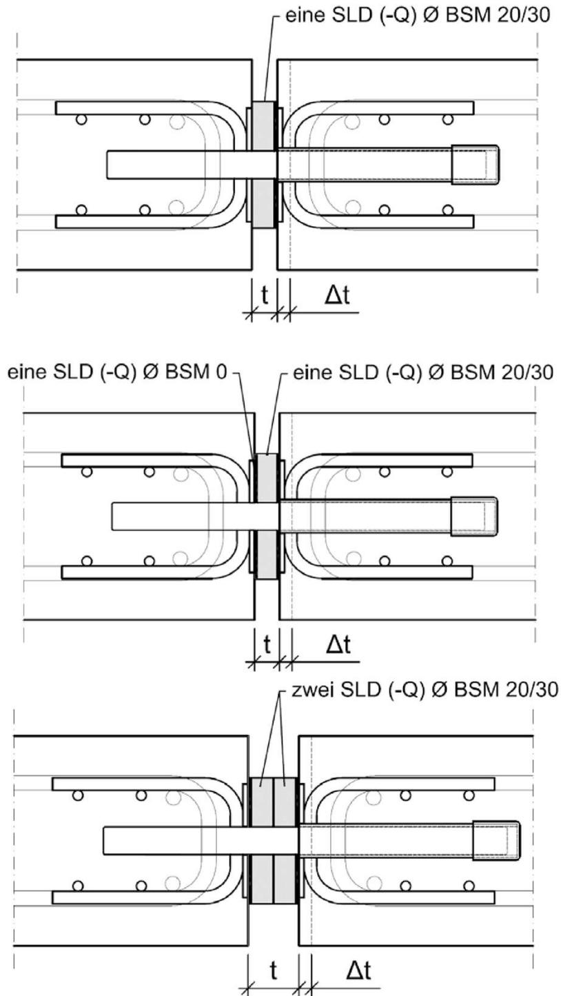
**Abb. 9: Anordnung der Brandschutzmanschetten für verschiedene Fugenbreiten**
