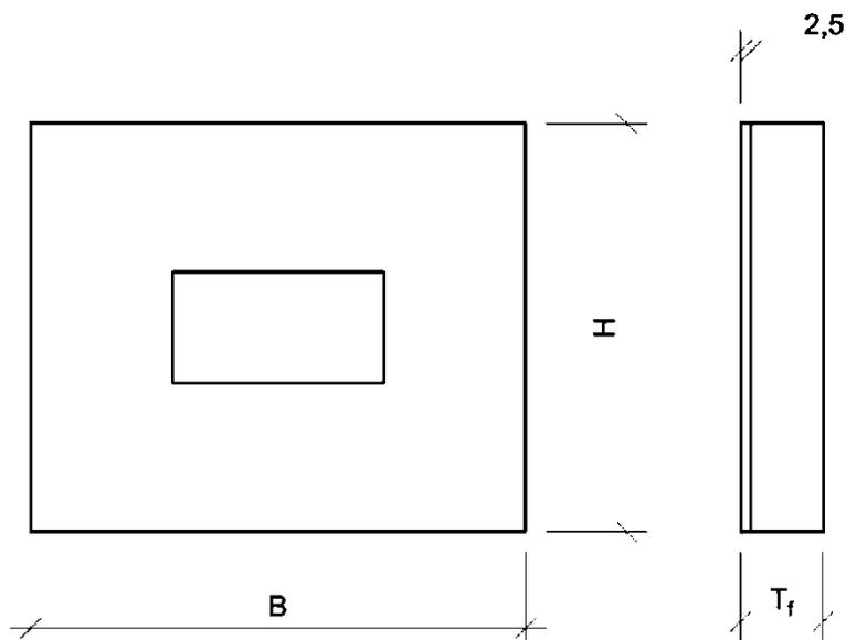
**Abb. 3: Abmessungen der Brandschutzmanschette SLD BSM / SLD-Q BSM**
