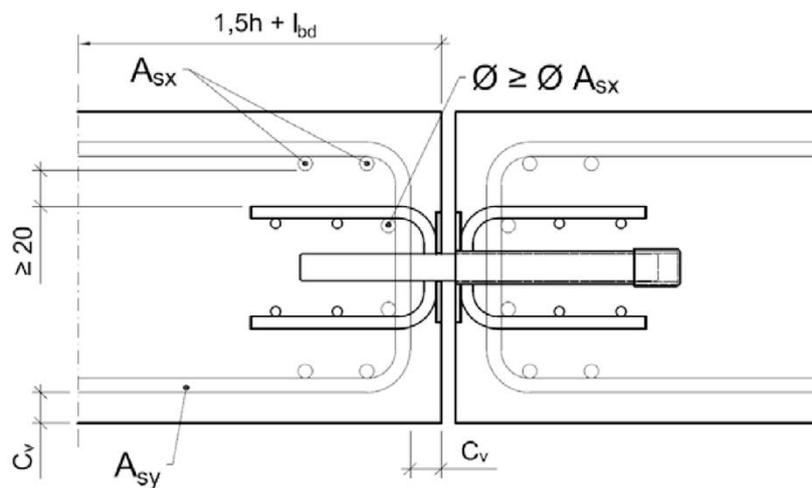
Abb. 6: Bewehrungsanordnung bei maximaler Plattendicke
