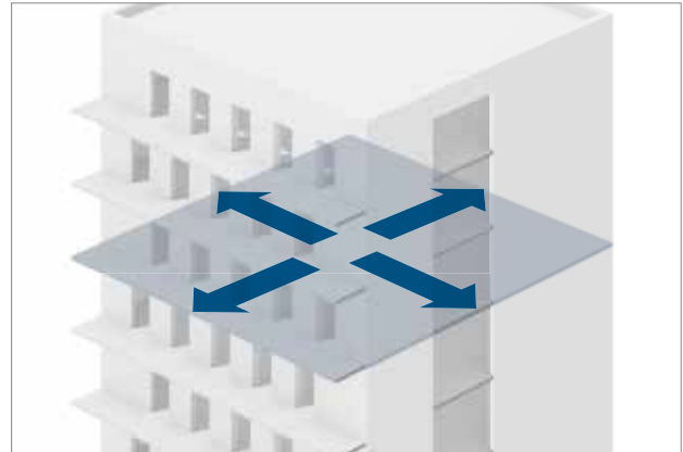
Abb. 7: Bewegungsrichtungen eines Gebäudes bei einem Erdbeben
