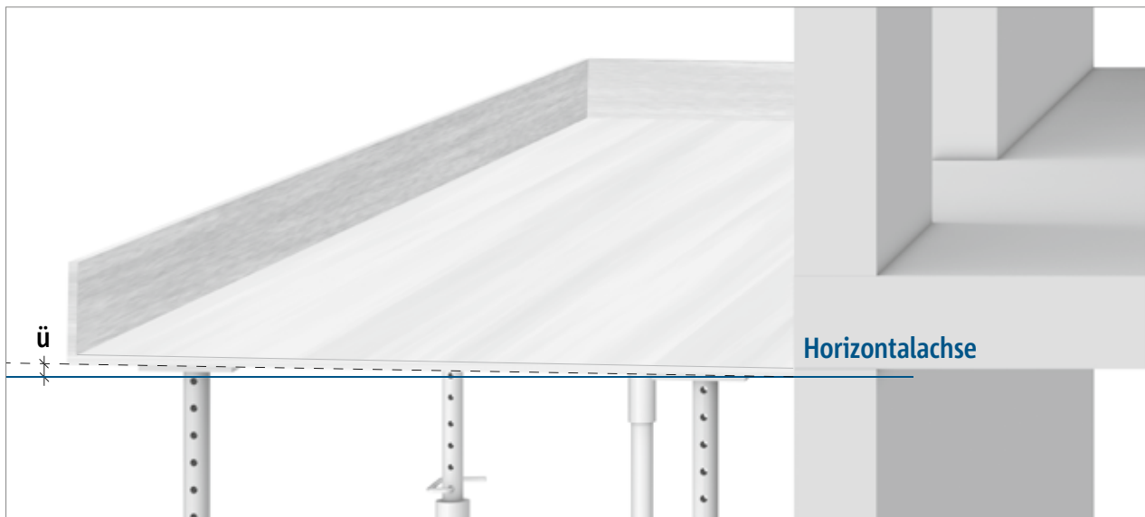
Abb. 4: Überhöhung der Schalung beim Betonieren
