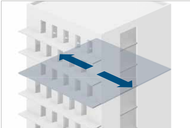
Abb. 9: Bewegungsrichtung parallel zur Dämmfuge
