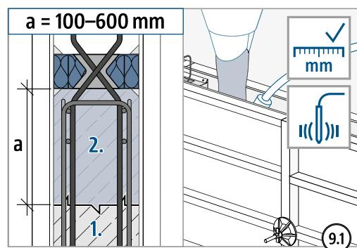
Ab Unterkante Dämmkörper Sconnex® Typ W ist ein 2. Betonierabschnitt von 100–600 mm vorzusehen.
