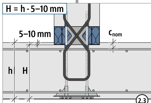
**H > 600 mm: Ab Unterkante Dämmkörper Sconnex® Typ W ist ein 2. Betonierabschnitt von 100–600 mm vorzusehen.**
