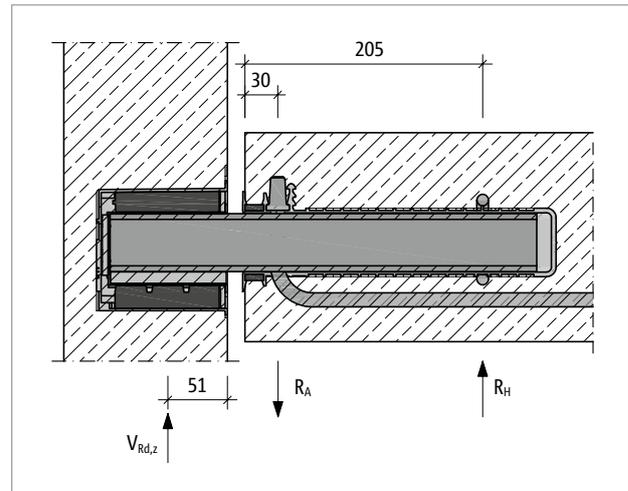
Abb. 23: Schöck Tronsole® Typ P: statisches System
