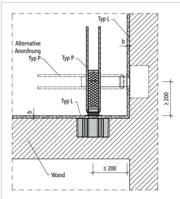
Abb. 15: Schöck Tronsole® Typ P: Elementanordnung, Detail A, Fugenbreite  $b = 15 \text{ mm}$  bei Ortbeton, bei Elementtreppenläufen ist die Notwendigkeit einer zusätzlichen Einbautoleranz durch den Planer zu prüfen
