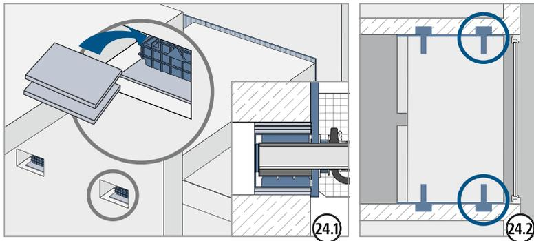
Einsatz von druckfesten **Ausgleichsplatten** (z. B. Stahl, Mindestgröße 180 × 120 mm) oben auf dem Wandelement Tronsole® Typ P Part W, zur Sicherung gegen Abheben des Podests.
