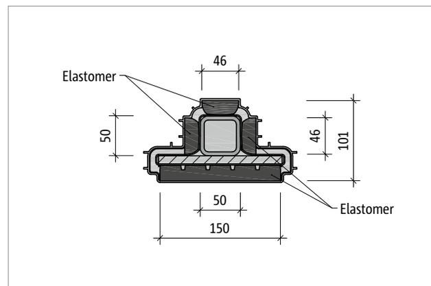
Abb. 21: Schöck Tronsole® Typ P-VH+VH: Produktquerschnitt B-B
