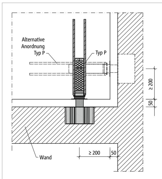
Abb. 16: Schöck Tronsole® Typ P: Elementanordnung, Detail B
