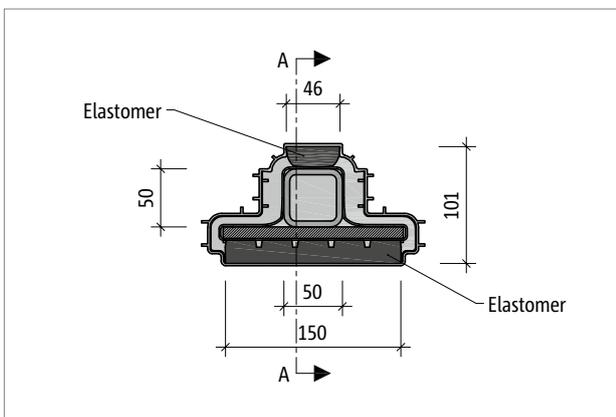
Abb. 20: Schöck Tronsole® Typ P-V+V: Produktquerschnitt B-B
