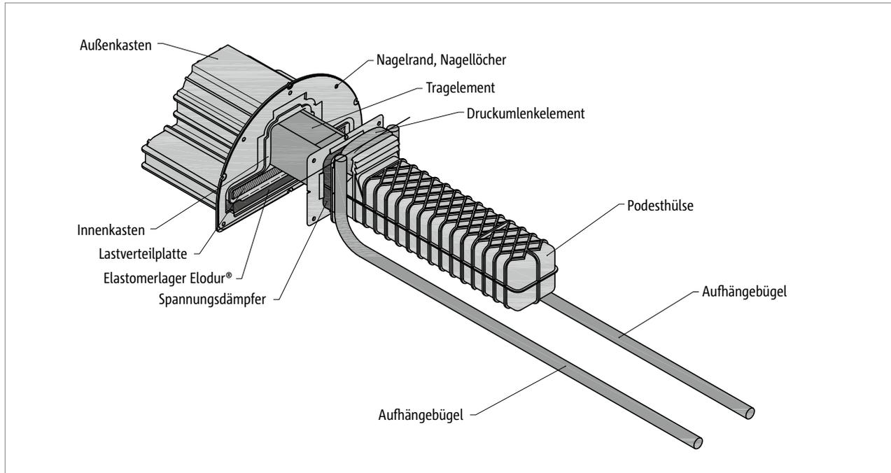
Abb. 8: Schöck Tronsole® Typ P: Wandelement, Tragelement und Podesthülse mit detaillierter Benennung wichtiger Bestandteile
