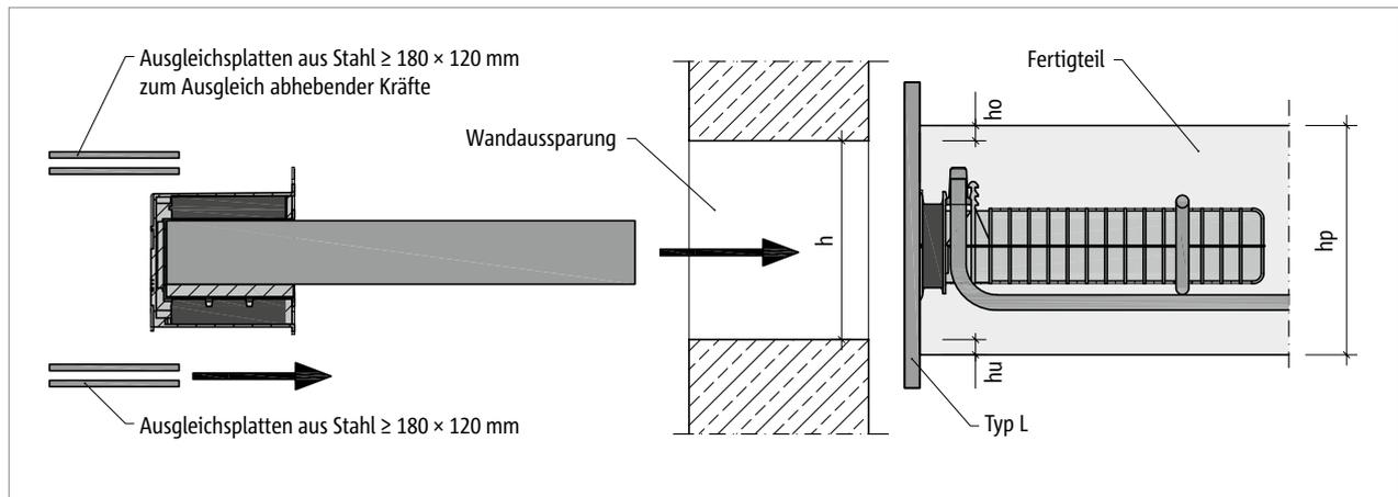
Abb. 36: Schöck Tronsole® Typ P: Wandaussparung bei Elementbauweise
