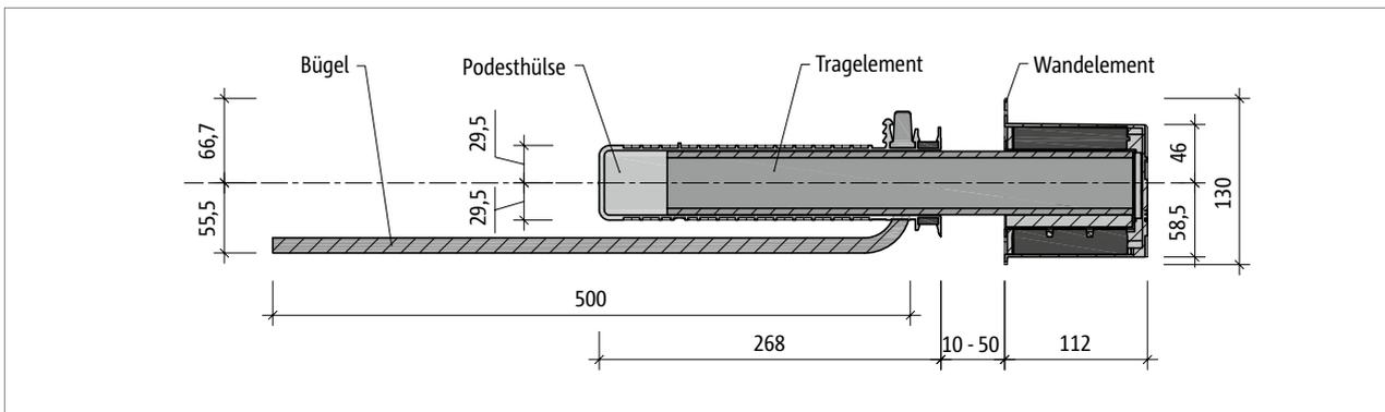
Abb. 19: Schöck Tronsole® Typ P: Produktschnitt A-A
