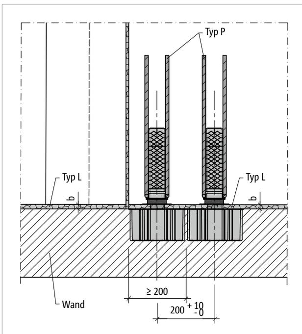
Abb. 17: Schöck Tronsole® Typ P (paarweise Anordnung): Elementanordnung, Detail C, Fugenbreite  $b = 15 \text{ mm}$  bei Ortbeton, bei Elementtreppentläufen ist die Notwendigkeit einer zusätzlichen Einbautoleranz durch den Planer zu prüfen
