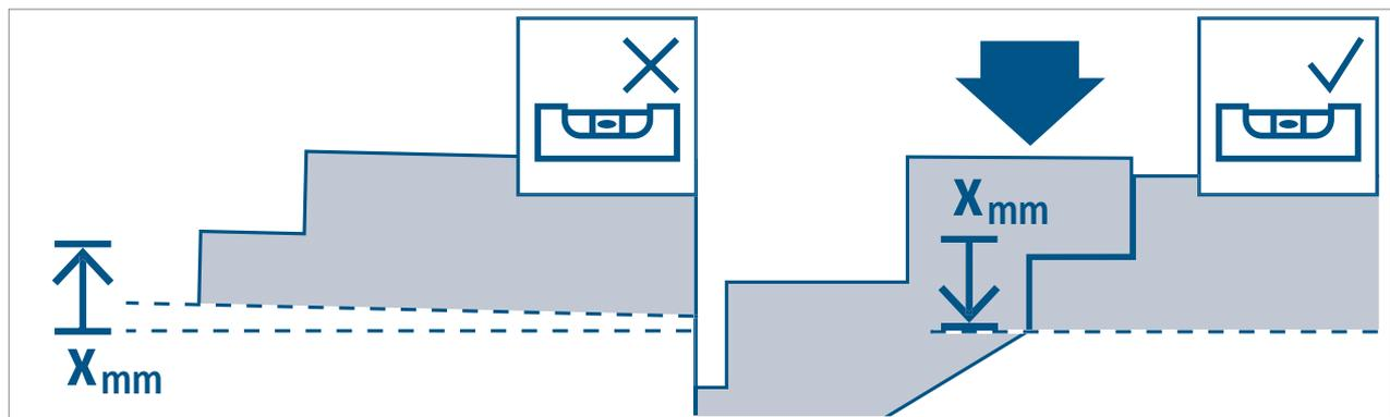
Abb. 30: Schöck Tronsole® Typ P: Überhöhung gemäss Werkplan
