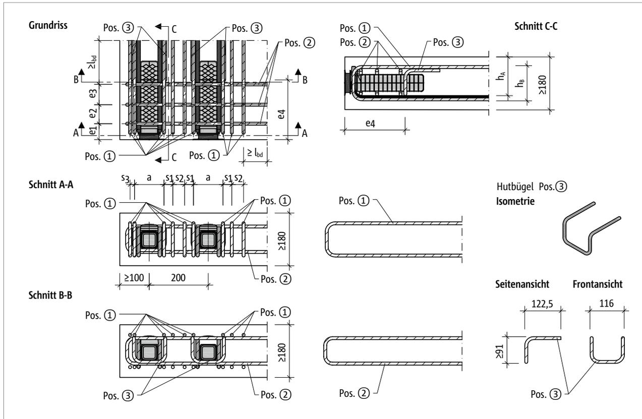
Abb. 26: Schöck Tronsole® Typ P: Bauseitige Bewehrung für die paarweise Anordnung
