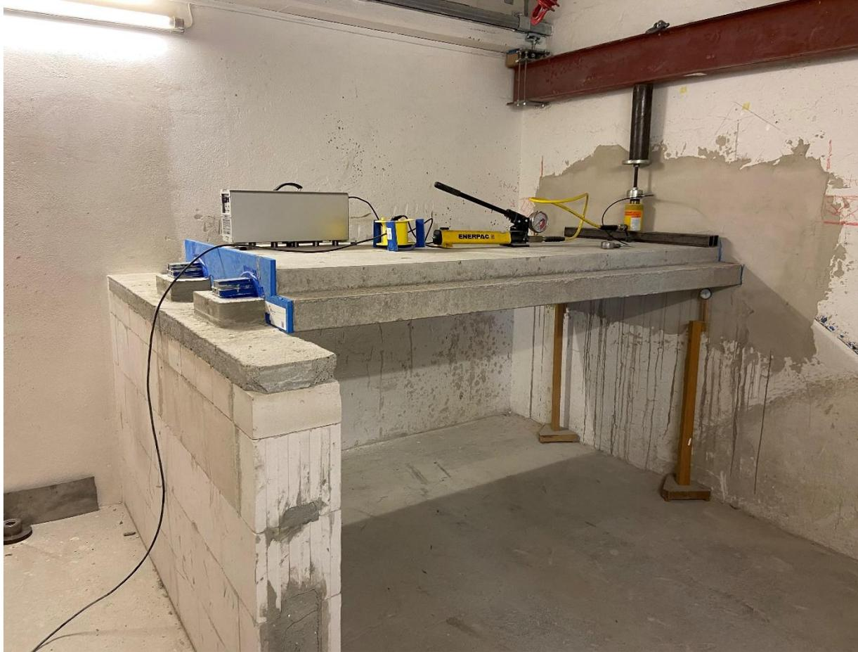
Abbildung 5 zeigt den gesamten Prüfaufbau. Die Schöck Tronsolen® wurden nach Aussage des Auftraggebers kurz vor Durchführung der Prüfung aus der Produktion der Schöck Bauteile GmbH entnommen und stellen somit aktuelle Serien-Elemente dar.
