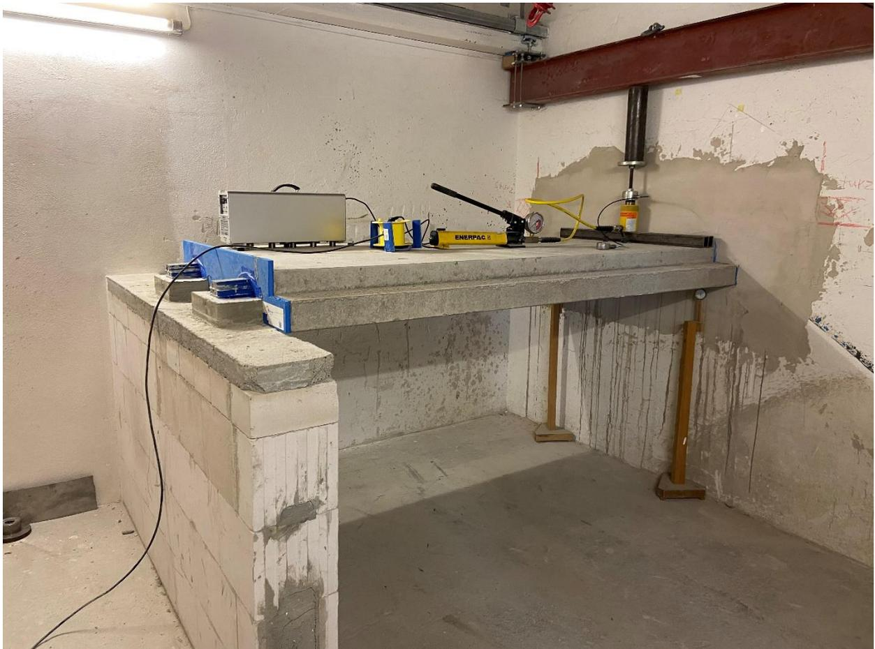
Abbildung 5: Entkoppeltes Referenztreppenpodest mit Schöck Tronsole Typ P-VH+VH. Gesamtansicht mit Hydraulikstempel zur Aufbringung der Zusatzlasten
