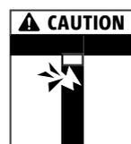
Défaillance du composant due à une perturbation de la zone en compression ! Ne faire passer aucun objet tel que des écarteurs, gaines et conduits, tubes, etc. au niveau du module de compression. Bien vibrer le béton.
