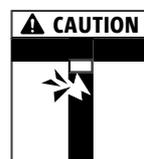
**CAUTION** Défaillance du composant due à une perturbation de la zone en compression ! Ne faire passer aucun objet tel que des écarteurs, gaines et conduits, tubes, etc. au niveau du module de compression. Bien vibrer le béton.
