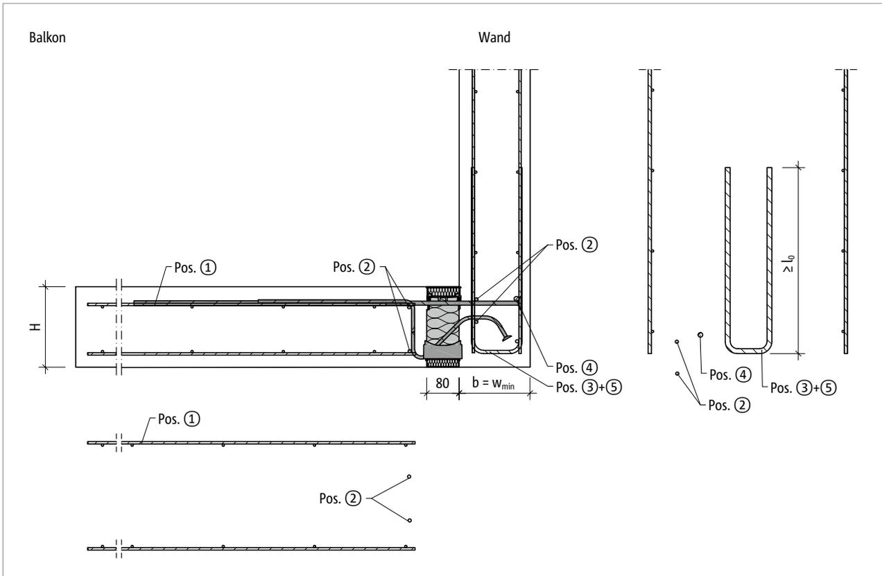
Abb. 83: Schöck Isokorb® T Typ KL-U: Bauseitige Bewehrung für Anschluss am Wandfuss mit minimaler Bauteilabmessung ( $w_{vorh} = w_{min}$ )
