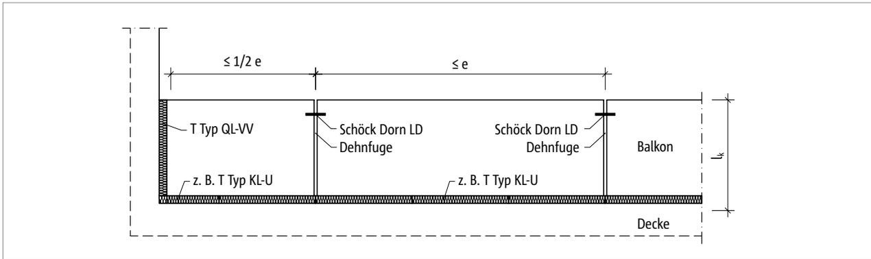
Abb. 72: Schöck Isokorb® T Typ KL-U: Dehnfugenanordnung
