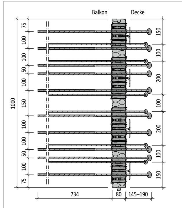
Abb. 80: Schöck Isokorb® T Typ KL-O-M4: Produktgrundriss
