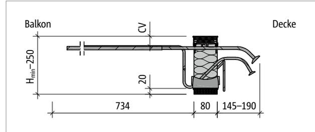
Abb. 78: Schöck Isokorb® T Typ KL-O-M4: Produktschnitt
