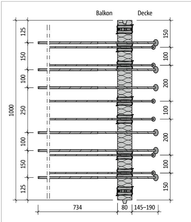
Abb. 79: Schöck Isokorb® T Typ KL-O-M2: Produktgrundriss
