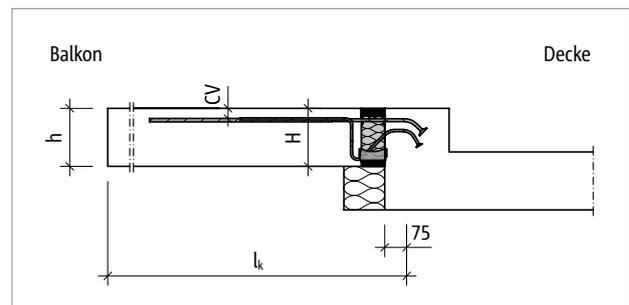
Abb. 67: Schöck Isokorb® T Typ KL-O: Statisches System
