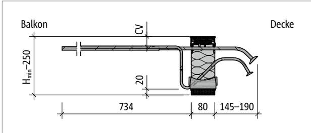
Abb. 77: Schöck Isokorb® T Typ KL-O-M2: Produktschnitt
