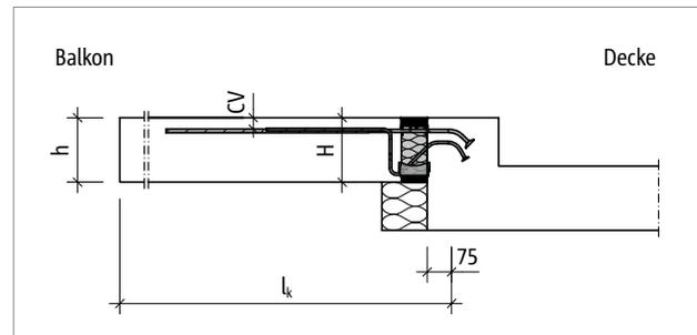
Abb. 69: Schöck Isokorb® T Typ KL-O: Statisches System
