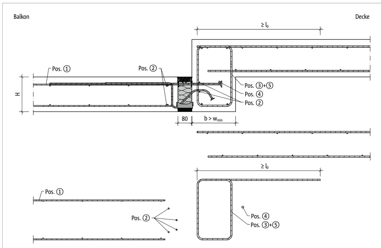
Abb. 82: Schöck Isokorb® T Typ KL-U: Bauseitige Bewehrung für Balkon mit Höhenversatz nach unten mit grösserer Bauteilabmessung ( $w_{vorh} > w_{min}$ )
