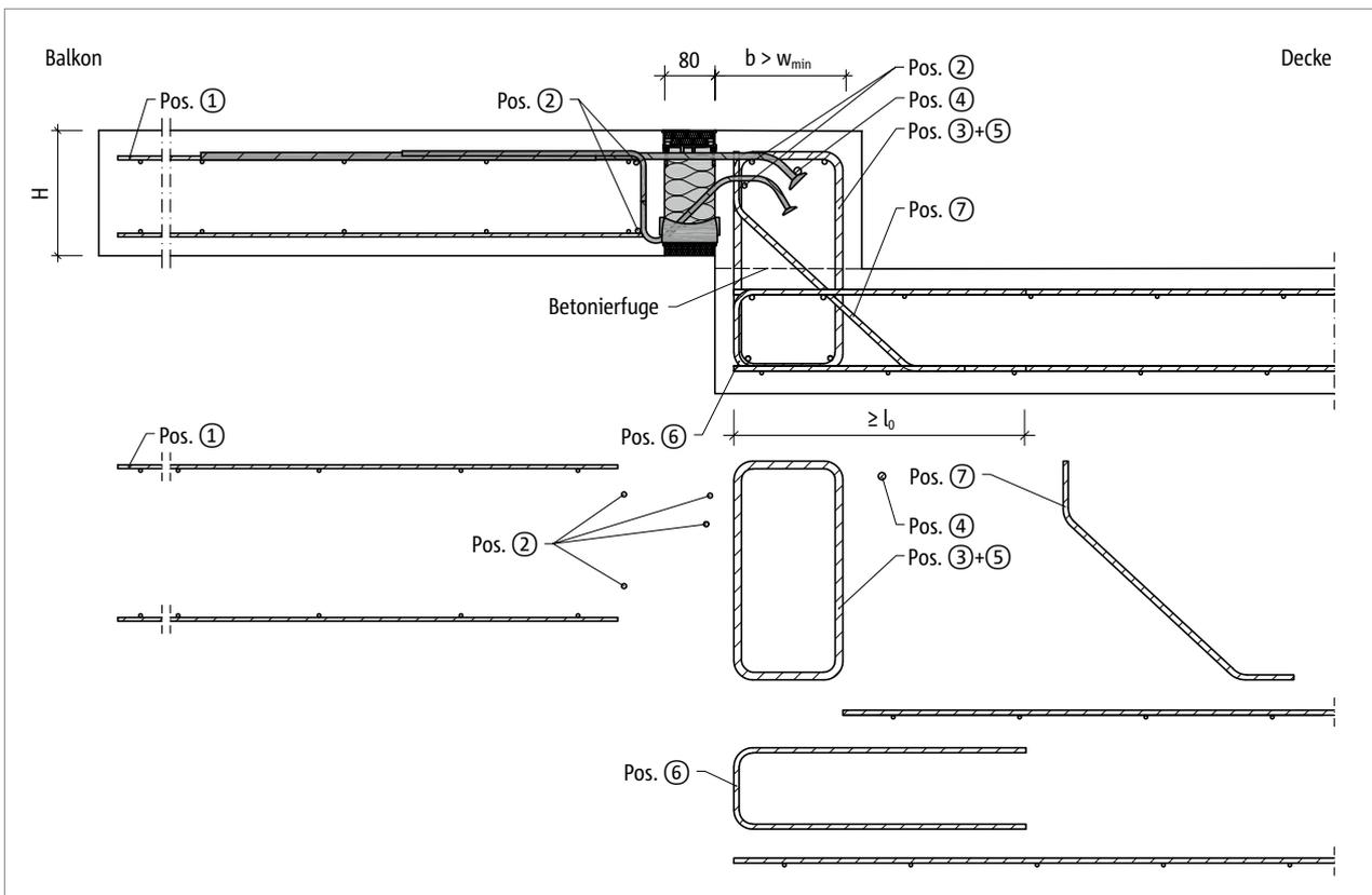
Abb. 86: Schöck Isokorb® T Typ KL-O: Bauseitige Bewehrung für Balkon mit Höhenversatz nach oben mit grösserer Bauteilabmessung ( $w_{vorh} > w_{min}$ )
