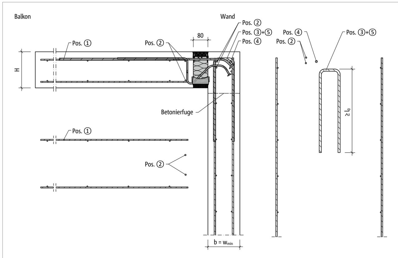
Abb. 87: Schöck Isokorb® T Typ KL-O: Bauseitige Bewehrung für Anschluss am Wandkopf mit minimaler Bauteilabmessung ( $w_{vorh} = w_{min}$ )
