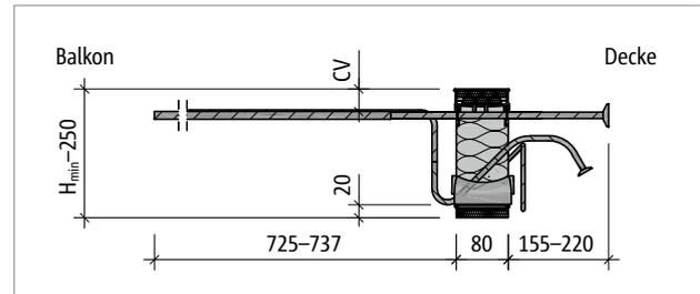
Abb. 74: Schöck Isokorb® T Typ KL-U-M4: Produktschnitt
