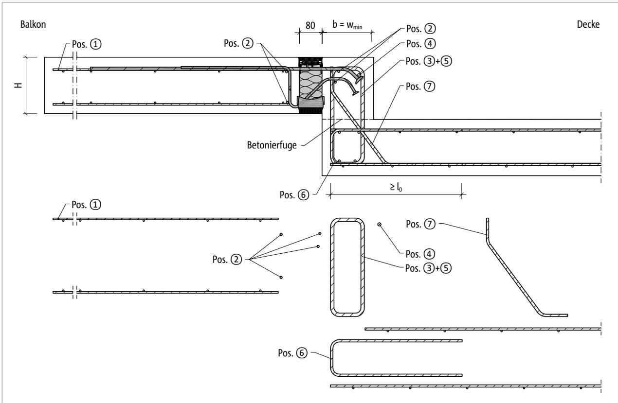
Abb. 85: Schöck Isokorb® T Typ KL-O: Bauseitige Bewehrung für Balkon mit Höhenversatz nach oben mit minimaler Bauteilabmessung ( $w_{vorh} = w_{min}$ )
