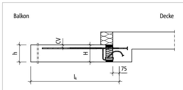
Abb. 66: Schöck Isokorb® T Typ KL-U: Statisches System
