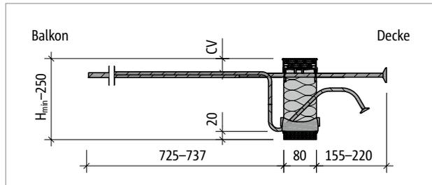
Abb. 73: Schöck Isokorb® T Typ KL-U-M2: Produktschnitt
