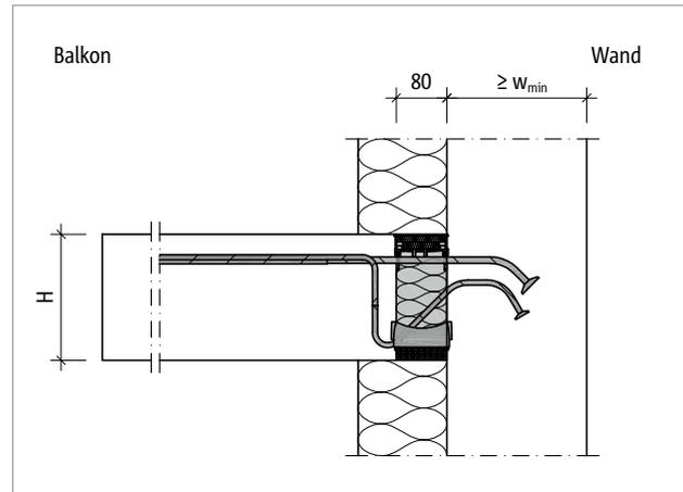
Abb. 63: Schöck Isokorb® T Typ KL-O: Wandanschluss nach unten bei Aussen-dämmung
