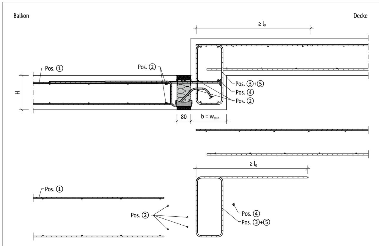
Abb. 81: Schöck Isokorb® T Typ KL-U: Bauseitige Bewehrung für Balkon mit Höhenversatz nach unten mit minimaler Bauteilabmessung ( $w_{vorh} = w_{min}$ )
