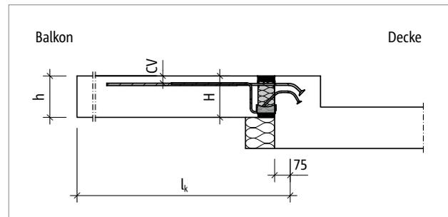
Abb. 71: Schöck Isokorb® T Typ KL-O: Statisches System
