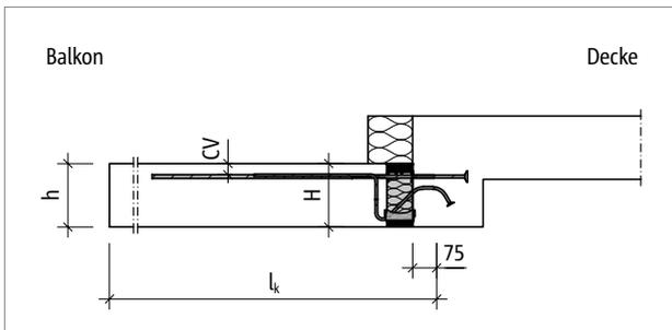
Abb. 68: Schöck Isokorb® T Typ KL-U: Statisches System
