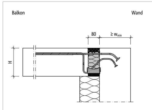
Abb. 65: Schöck Isokorb® T Typ KL-O: Anschluss am Wandkopf bei Aussen-dämmung
