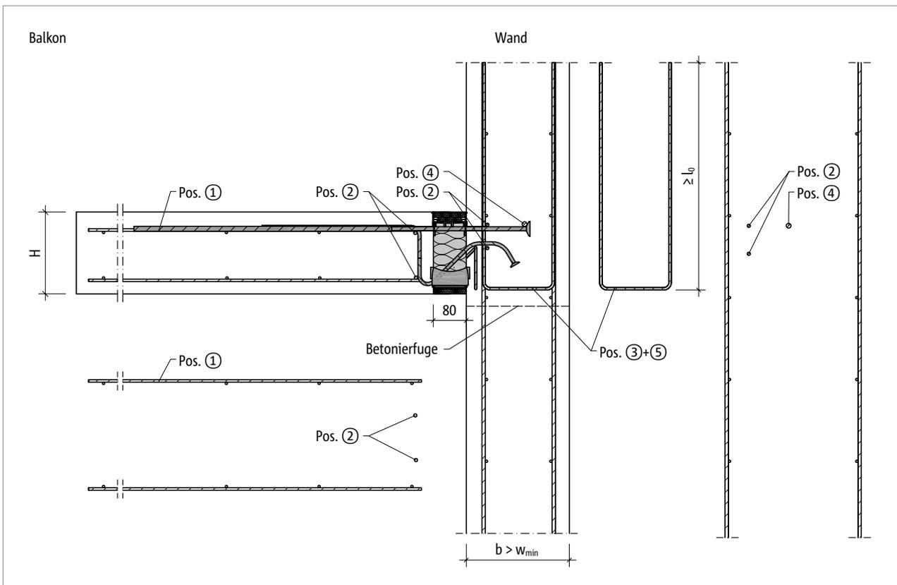
Abb. 84: Schöck Isokorb® T Typ KL-U: Bauseitige Armierung für Wandanschluss mit grösserer Bauteilabmessung ( $w_{vorh} > w_{min}$ )
