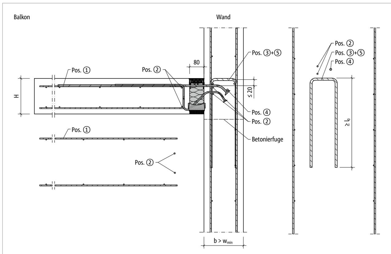
Abb. 88: Schöck Isokorb® T Typ KL-O: Bauseitige Bewehrung für Wandanschluss mit grösserer Bauteilabmessung ( $w_{vorh} > w_{min}$ )
