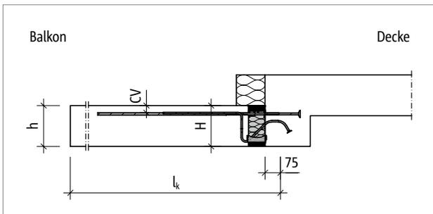
Abb. 70: Schöck Isokorb® T Typ KL-U: Statisches System
