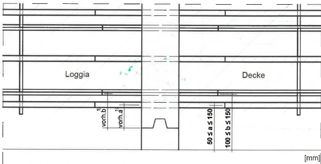
Bild 1-2: Rand- und Dehnfugenabstände der Zug-, Druck- und Querkraftstäbe (Schöck Isokorb® XT Typ D)
