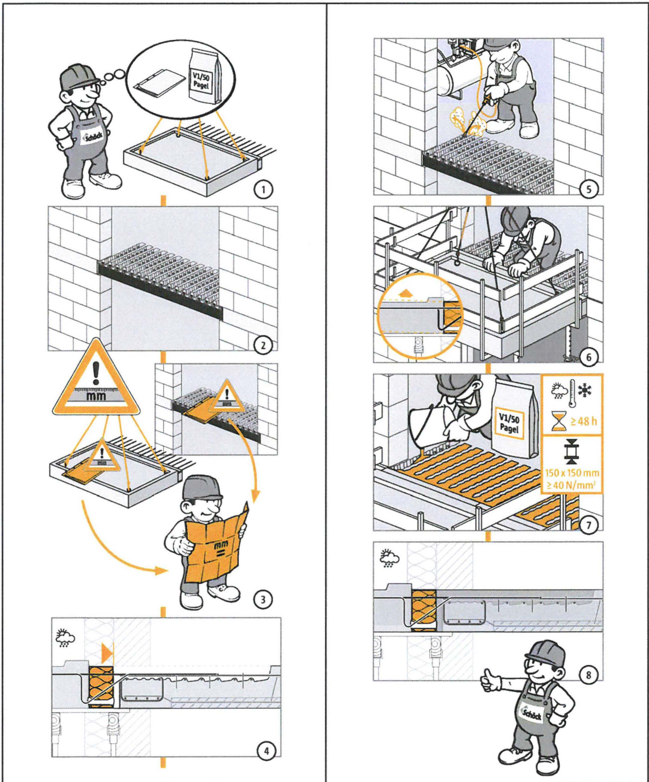
Schöck Isokorb zum nachträglichen Einbau Typ ID-239 und ID-240
