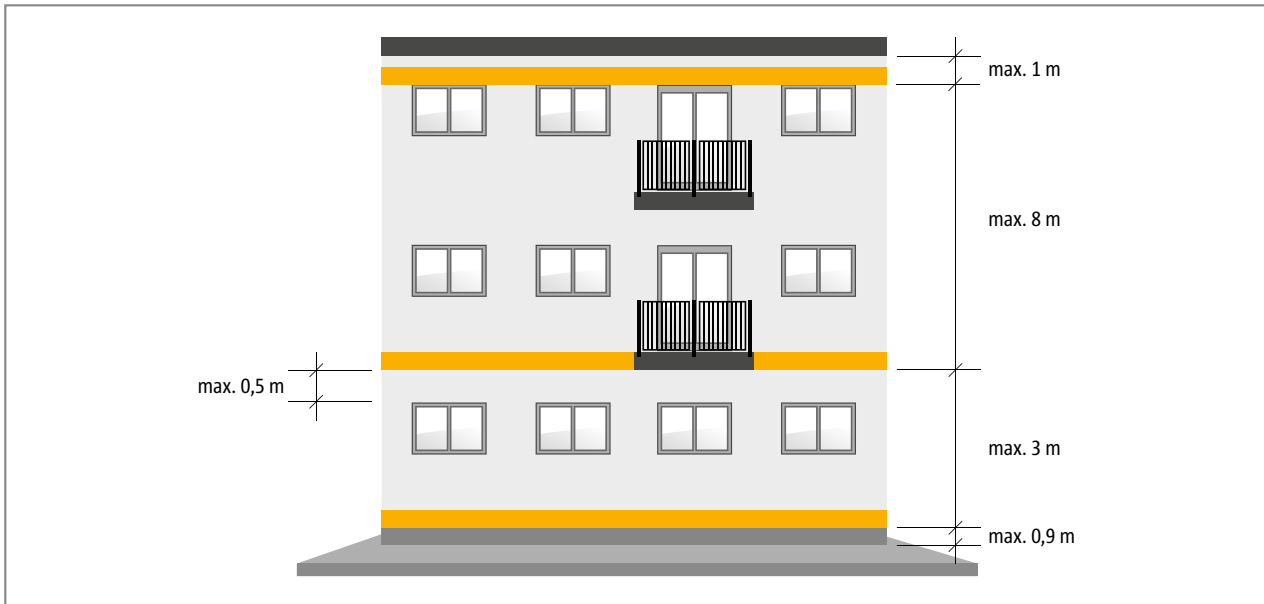
Abb. 1: Anordnung von Balkonen im Brandriegel
