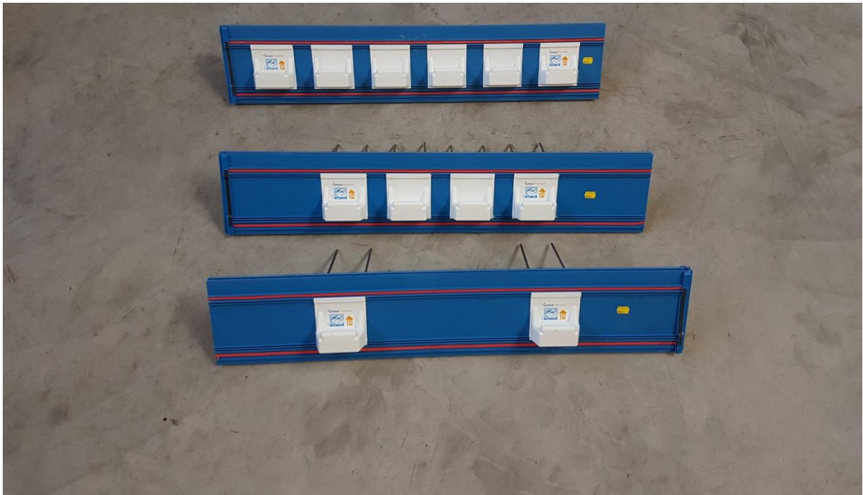
Abbildung 5: Geprüfte Schöck Tronsole® Typ T-V2-L1000, Schöck Tronsole® Typ T-V4-L1000 und Schöck Tronsole® Typ T-V6-L1000 (von unten nach oben)
