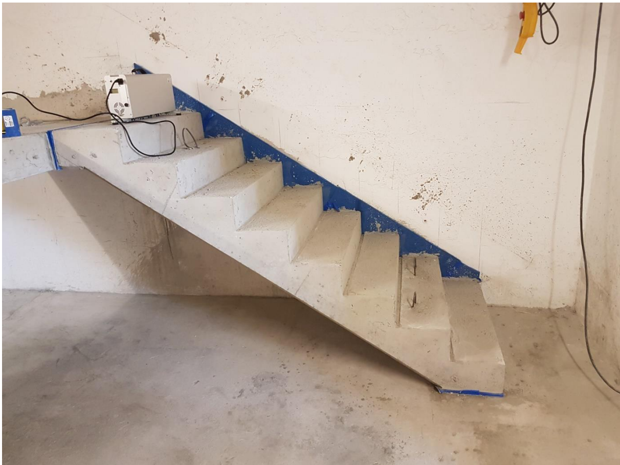
Abbildung 5: Geprüfte Schöck Tronsole® Typ T-V2-L1000, Schöck Tronsole® Typ T-V4-L1000 und Schöck Tronsole® Typ T-V6-L1000 (von unten nach oben)
