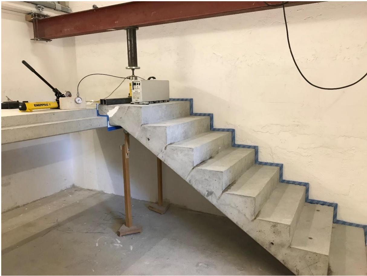
Abbildung 6: Entkoppelter Referenztreppenlauf mit Hydraulikpresse zur Aufbringung der Zusatzlasten
