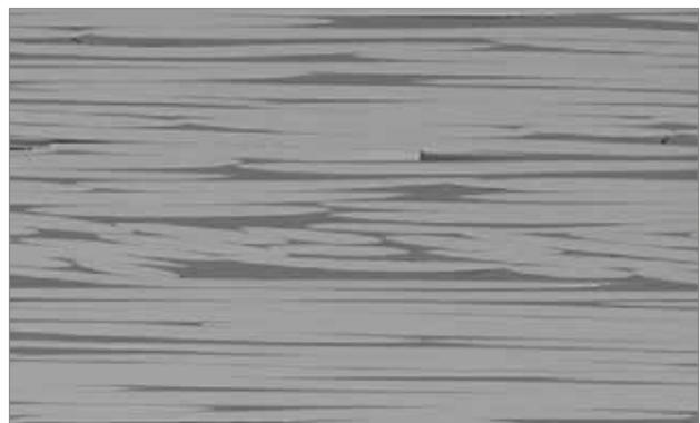
Abb. 4: Schöck Combar®: Längsschnitt durch den Stab
