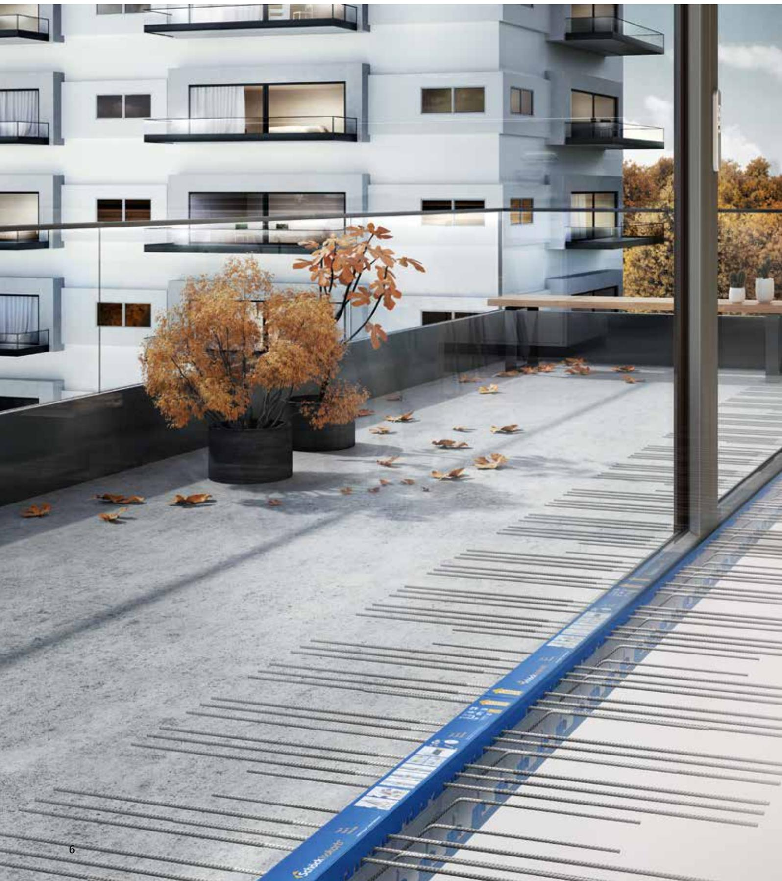
*Wärmebrücken an auskragenden Bauteilen sind häufig die Ursache für erhöhten Heizwärmeverlust und begünstigen kalte und feuchte Wände. Mit dem Schöck Isokorb® T haben wir ein wirksames Gegenmittel entwickelt. Als tragendes Wärmedämmelement vereint er zwei Funktionen: die thermische Trennung von Stahlbetonbauteilen und ihre statische Verbindung.*
