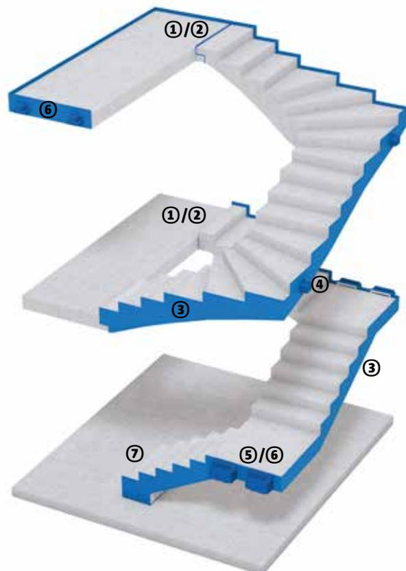
Sicherer Trittschallschutz funktioniert nur im System. Dabei müssen alle Komponenten und Anschlüsse im Treppenhaus berücksichtigt werden. Mit der Schöck Tronsole® können Sie sich auf exakt aufeinander abgestimmte Komponenten verlassen. Und damit auf eine ganzheitliche Lösung über unterschiedliche Gewerke hinweg.
