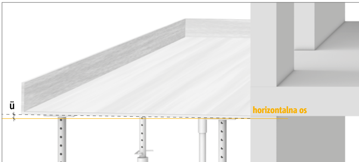
Nadvišenje kod betoniranja
