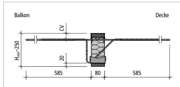
Abb. 36: Schöck Isokorb® T Typ K-M5 und K-M6: Produktschnitt
