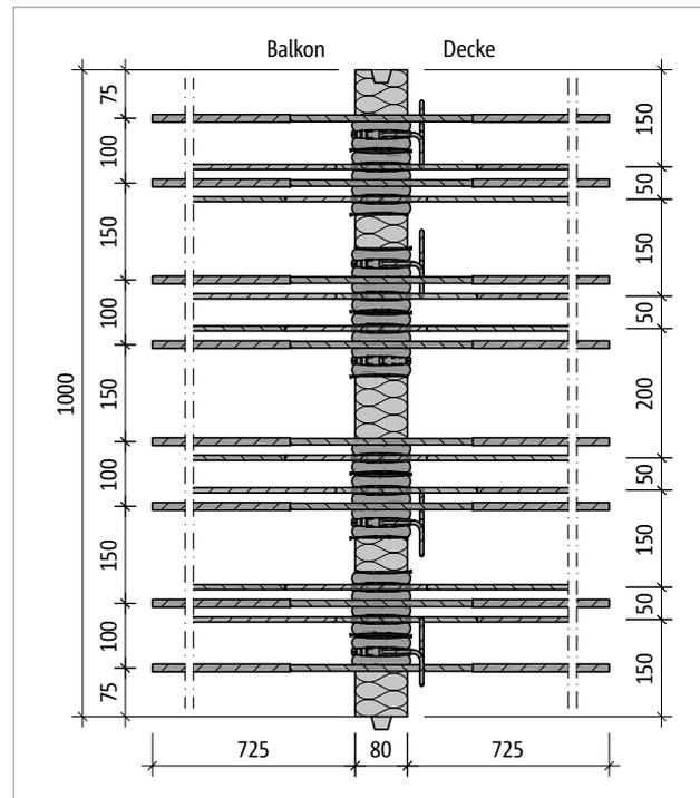
Abb. 42: Schöck Isokorb® T Typ K-M6-VV1: Produktgrundriss
