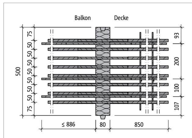
Abb. 48: Schöck Isokorb® T Typ K-M14-V3: Produktgrundriss
