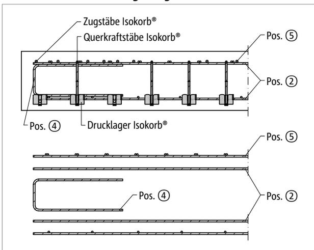
Abb. 51: Schöck Isokorb® T Typ K: Bauseitige Bewehrung balkonseitig im Schnitt A-A; Pos.4 = konstruktive Randeinfassung am freien Rand senkrecht zum Schöck Isokorb®
