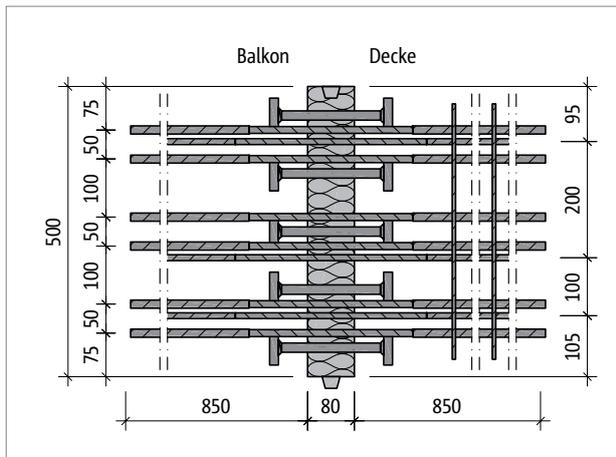
Abb. 45: Schöck Isokorb® T Typ K-M12-V1: Produktgrundriss
