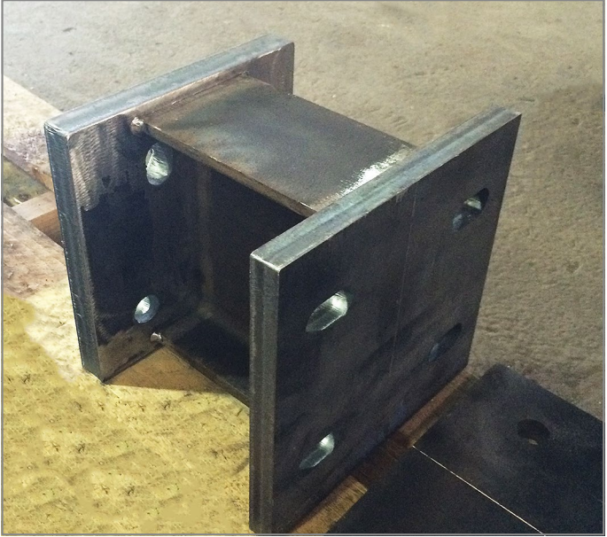
Abb. 48: Adapter mit horizontalen und vertikalen Langlöchern
