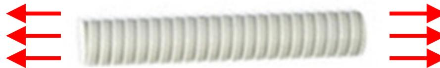
Der charakteristische Wert der Dauerzugfestigkeit wird für Außenbauteile in mitteleuropäischem Klima für eine Lebensdauer von 100 Jahren bestimmt.
