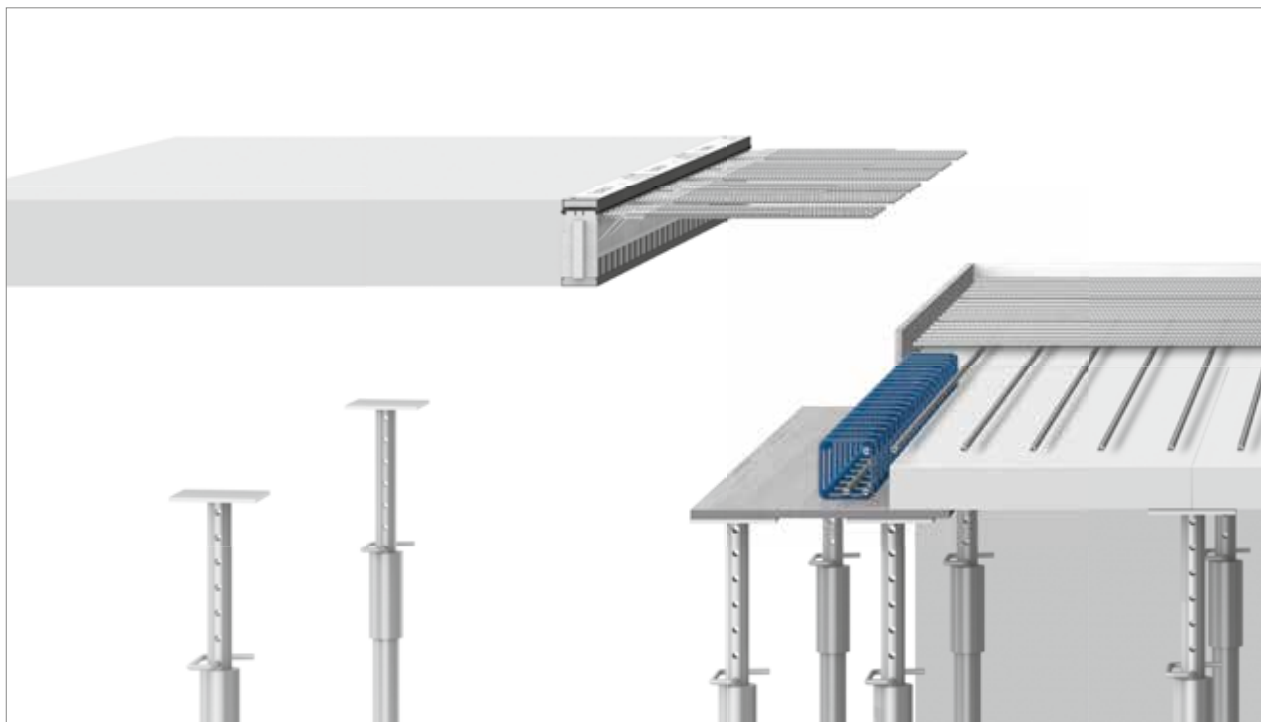
Obr. 36: Schöck Isokorb® T typ KL: Příprava bednění a výztuže pro montáž prefabrikované desky se zabetonovaným prvkem T typ KL
