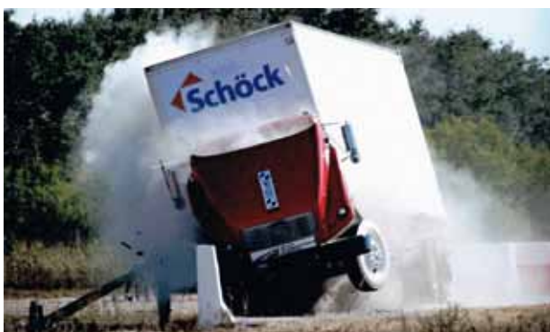
Успешный краш-тест отбойника PL-3, Хьюстон, США
