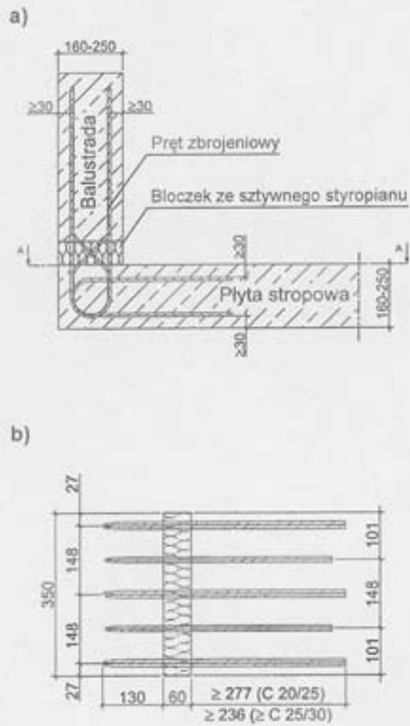
Rysunek 31. Połączenie wykonane z zastosowaniem łącznika w wersji A (a), łącznik w wersji A (b)
