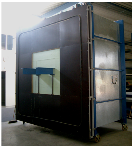
Bild 4.3: Warmseite Prüfstand mit eingebauten Prüfkörpern
