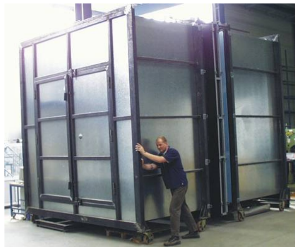
Bild 4.4: Prüfstand mit Kaltseite (links) und Warmseite (rechts)
