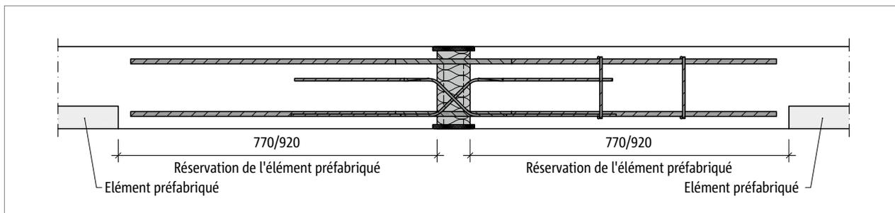
Ill. 103: Schöck Isokorb® T type DP : Dalle en éléments préfabriqués avec mise en œuvre de l'Isokorb® T type DP
