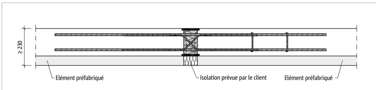
Ill. 104: Schöck Isokorb® T type DP : Dalle en éléments préfabriqués avec mise en œuvre de l'Isokorb® T type DP
