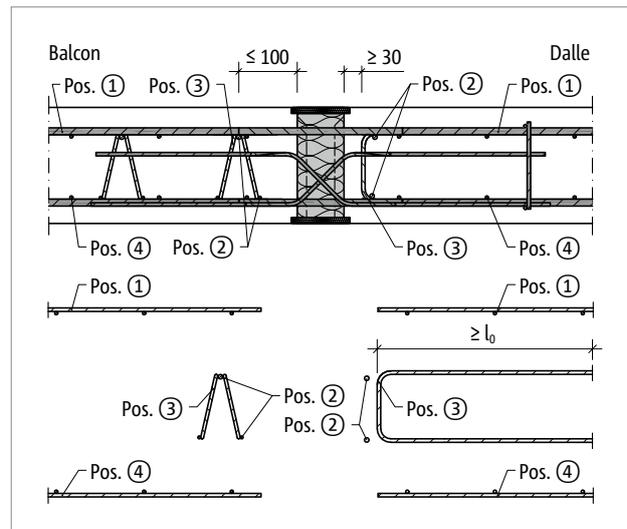
Ill. 102: Schöck Isokorb® T type DP : Armature sur chantier avec treillis raidisseurs
