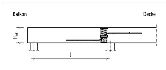
Abb. 147: Schöck Isokorb® T Typ Q: Statisches System (T Typ Q-V6 bis Q-V12)
