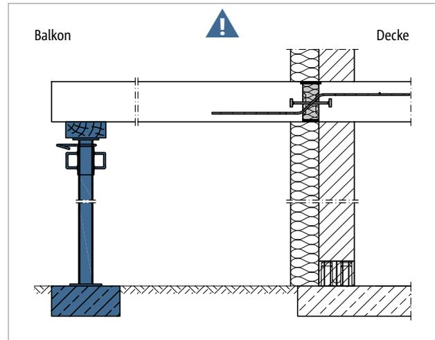
Abb. 221: Schöck Isokorb® T Typ Q-P: Stützung durchgängig erforderlich
