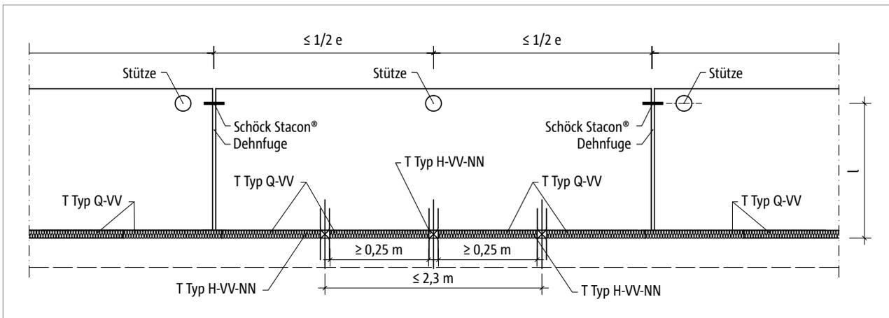
Abb. 253: Schöck Isokorb® T Typ H: Dehnfugenanordnung bei mehreren Typen H
