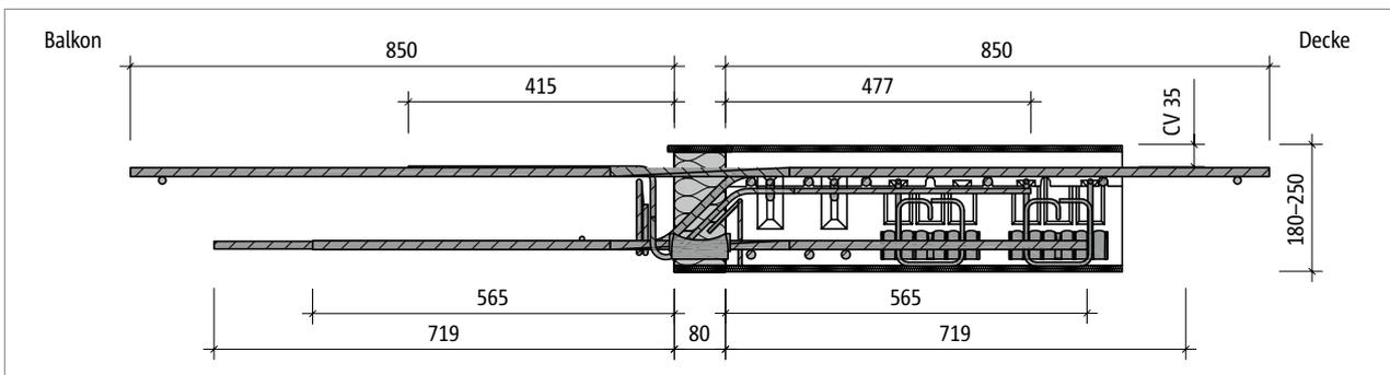
Abb. 232: Schöck Isokorb® T Typ C-M2: Produktschnitt
