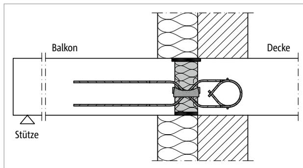
Abb. 140: Schöck Isokorb® T Typ Q-VV: Anschluss bei Wärmedämmverbundsystem (WDVS) (z. B. T Typ Q-VV1 bis Q-VV5)
