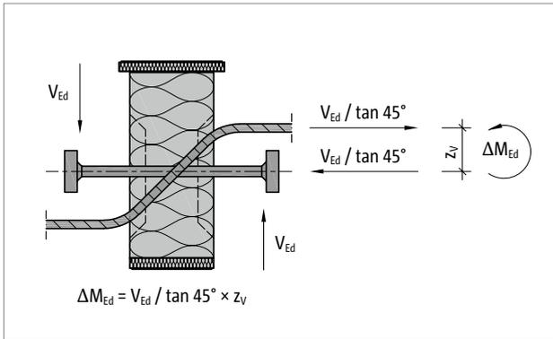
Abb. 192: Schöck Isokorb® T Typ Q-P: Momente aus exzentrischem Anschluss
