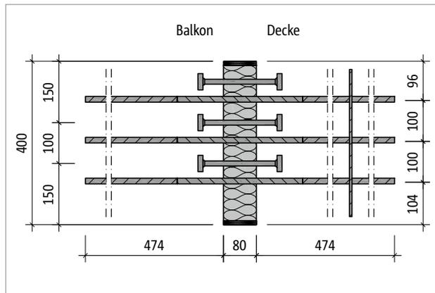
Abb. 206: Schöck Isokorb® T Typ Q-P-V9: Produktgrundriss
