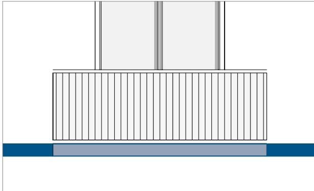
Abb. 3: Schöck Isokorb®: Als Ersatz für den Brandriegel
