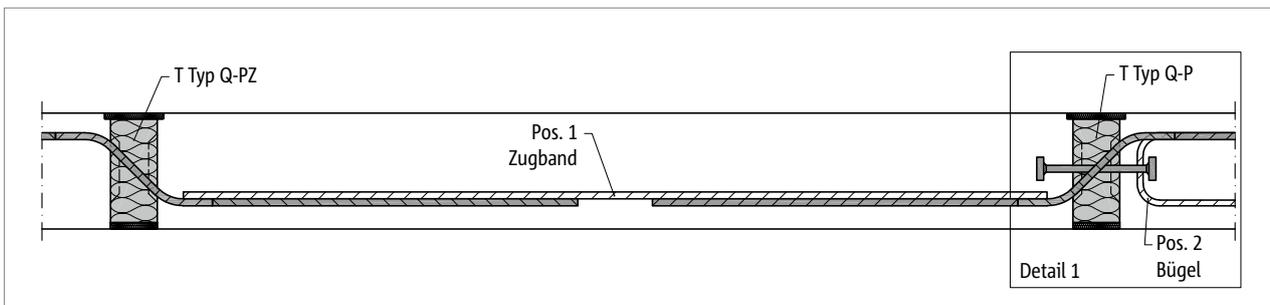
Abb. 217: Schöck Isokorb® T Typ Q-PZ, Q-P: Schnitt A-A; Bewehrungsanschluss Zugband
