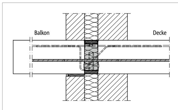
Abb. 248: Schöck Isokorb® T Typ K, H-NN: Mauerwerk mit Kerndämmung
