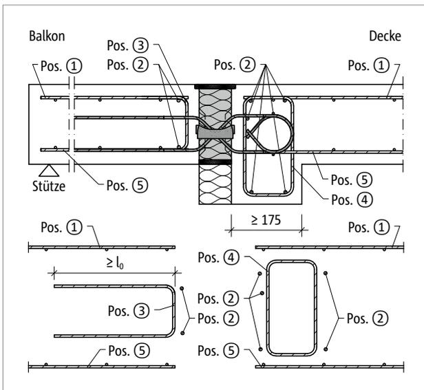
Abb. 173: Schöck Isokorb® T Typ Q-VV1 bis Q-VV5: Bauseitige Bewehrung in Unterzug
