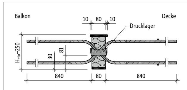
Abb. 160: Schöck Isokorb® T Typ Q-VV12: Produktschnitt
