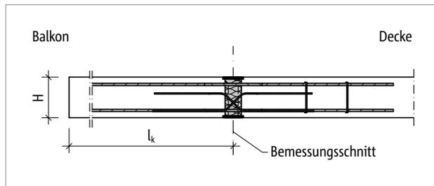
Abb. 279: Schöck Isokorb® T Typ D: Statisches System
