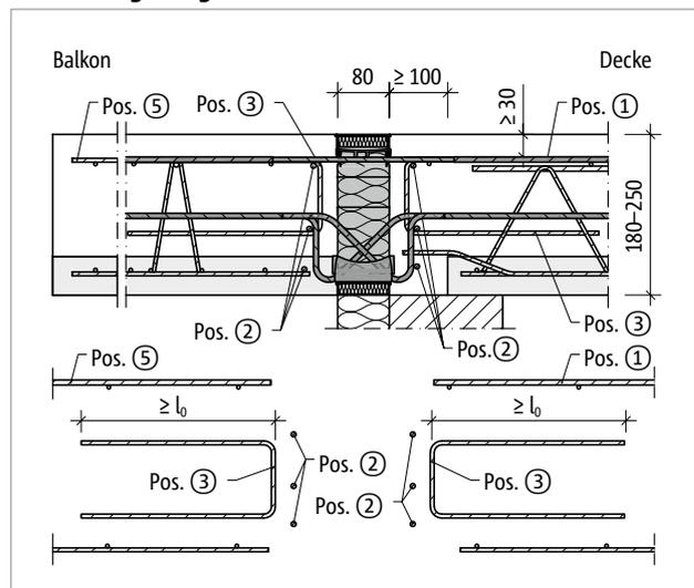
Abb. 72: Schöck Isokorb® T Typ K-F-VV: Bauseitige Bewehrung bei Balkonplattendicke  $h = 180-250$  mm; Variante mit Steckbügel
