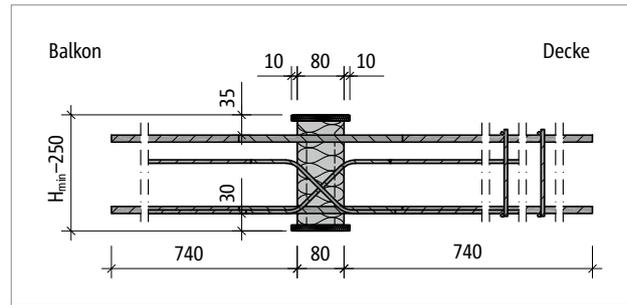
Abb. 281: Schöck Isokorb® T Typ D-MM1-VV1 bei CV35: Produktschnitt
