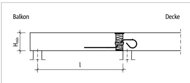
Abb. 146: Schöck Isokorb® T Typ Q: Statisches System (T Typ Q-V1 bis Q-V5)
