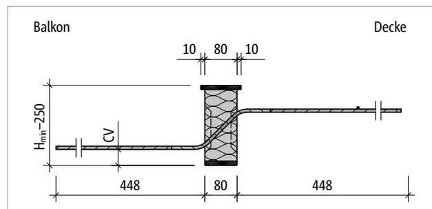
Abb. 203: Schöck Isokorb® T Typ Q-PZ-V1 bis Q-PZ-V3: Produktschnitt
