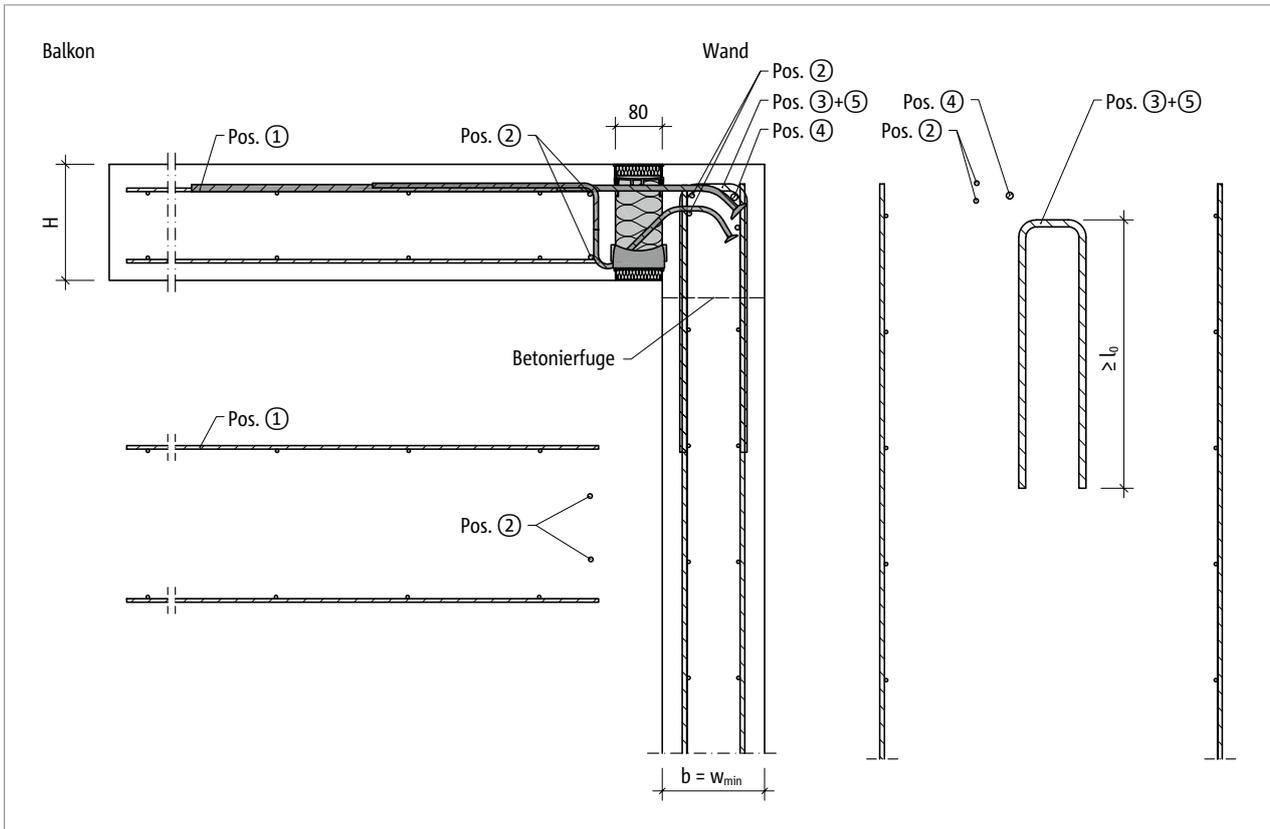
Abb. 119: Schöck Isokorb® T Typ K-O: Bauseitige Bewehrung für Wandanschluss nach unten mit minimaler Bauteilabmessung ( $w_{vorh} = w_{min}$ )
