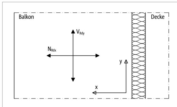
Abb. 251: Schöck Isokorb® T Typ H: Vorzeichenregel für die Bemessung
