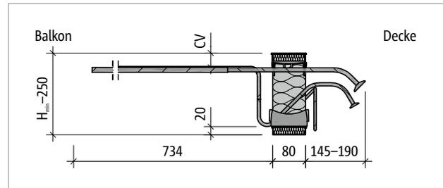
Abb. 109: Schöck Isokorb® T Typ K-O-M4: Produktschnitt
