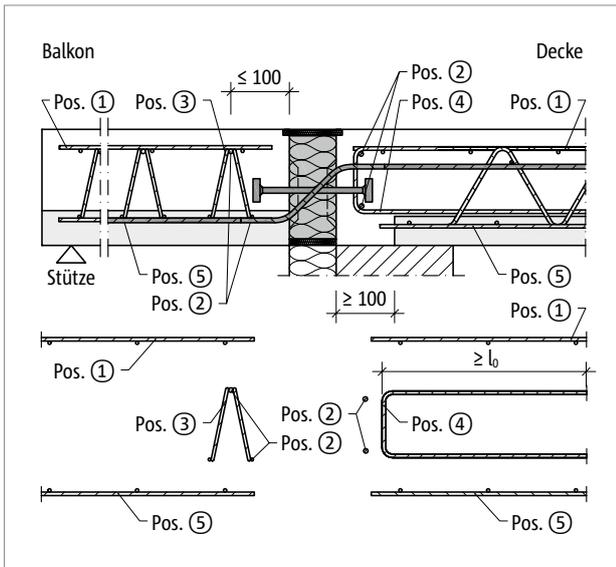
Abb. 209: Schöck Isokorb® T Typ Q-P: Bauseitige Bewehrung mit Gitterträger
