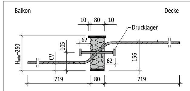
Abb. 197: Schöck Isokorb® T Typ Q-P-V6: Produktschnitt
