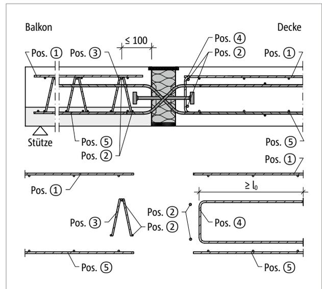
Abb. 214: Schöck Isokorb® T Typ Q-P-VV: Bauseitige Bewehrung, balkonseitig mit Gitterträger
