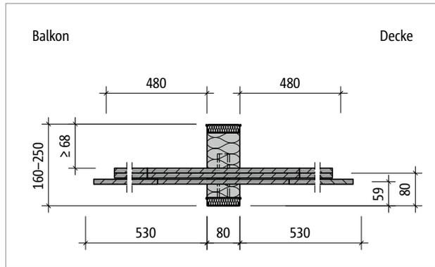
Abb. 260: Schöck Isokorb® T Typ H-VV2-NN1: Produktschnitt
