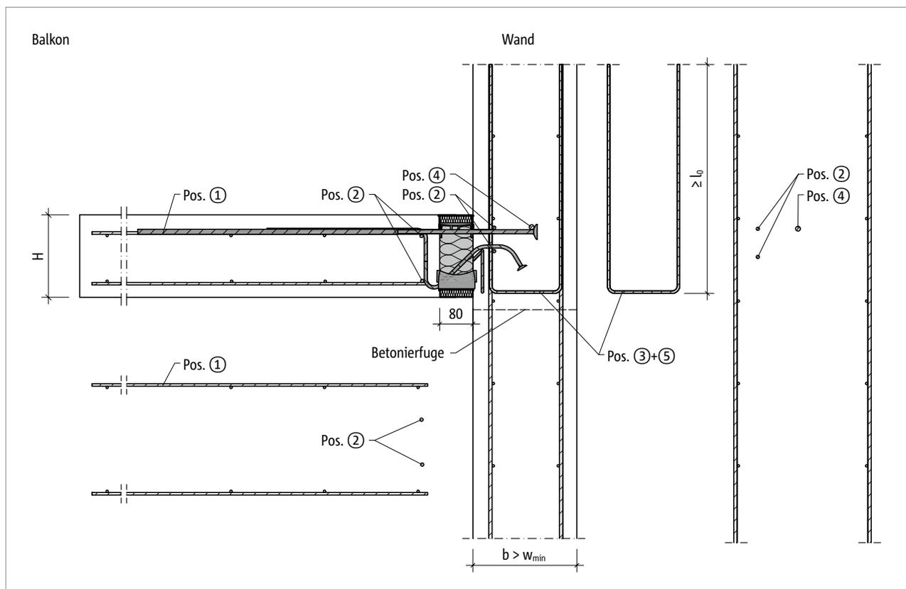
Abb. 116: Schöck Isokorb® T Typ K-U: Bauseitige Bewehrung für Wandanschluss nach oben mit größerer Bauteilabmessung ( $w_{vorh} > w_{min}$ )
