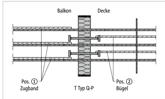
Abb. 216: Schöck Isokorb® T Typ Q-P: Detail 1; Bewehrungsanschluss Zugband
