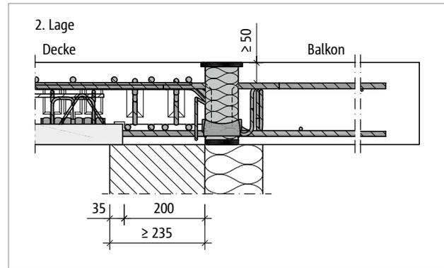
Abb. 241: Schöck Isokorb® T Typ C: Halbfertigteilplatte ohne Randunterstützung mit WDVS (Schnitt T Typ C-CV50-2. Lage, Ansicht T Typ C-CV35-1. Lage)
