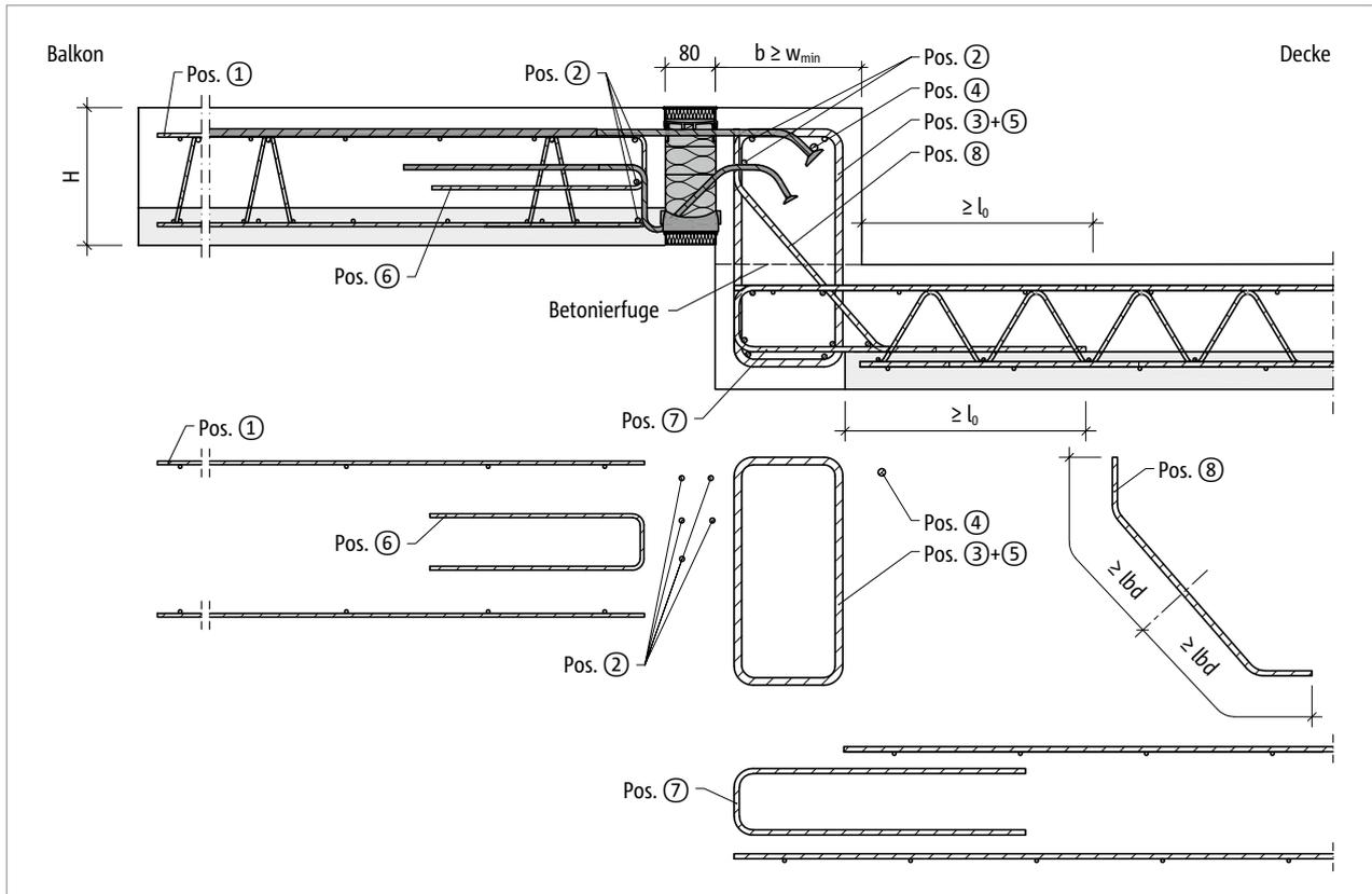
Abb. 131: Schöck Isokorb® T Typ K-O-F: Bauseitige Bewehrung für Balkon mit Höhenversatz nach oben
