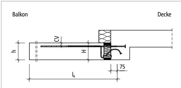
Abb. 101: Schöck Isokorb® T Typ K-U: Statisches System
