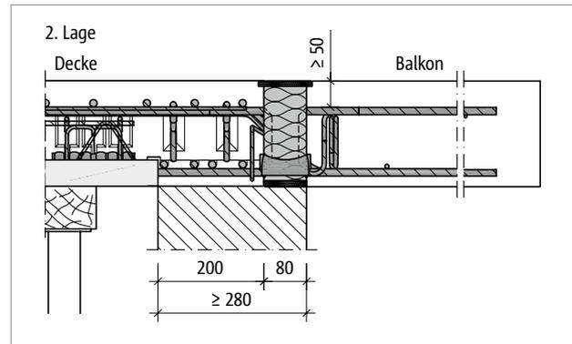
Abb. 243: Schöck Isokorb® T Typ C: Halbfertigteilplatte mit Randunterstützung mit wärmedämmendem Mauerwerk (Schnitt T Typ C-CV50-2. Lage, Ansicht T Typ C-CV35-1. Lage)
