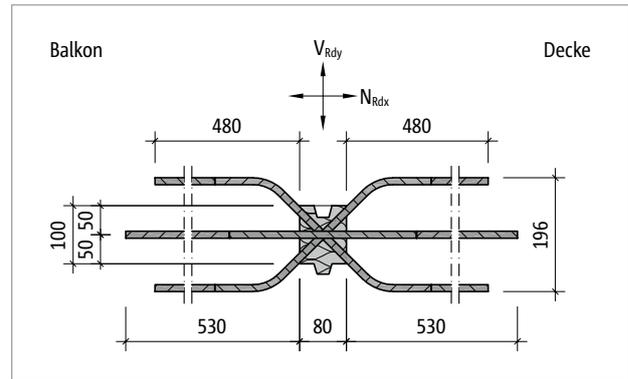
Abb. 261: Schöck Isokorb® T Typ H-VV2-NN1: Produktgrundriss
