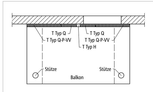
Abb. 185: Schöck Isokorb® T Typ Q-P-VV, Q: Balkon mit Stützenlagerung, Anschluss bei unterschiedlichen Auflagersteifigkeiten; optional mit T Typ H
