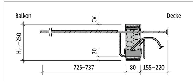
Abb. 105: Schöck Isokorb® T Typ K-U-M4: Produktschnitt
