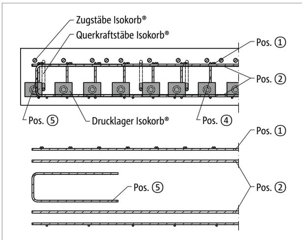
Abb. 57: Schöck Isokorb® T Typ K-M12: Bauseitige Bewehrung balkonseitig im Schnitt A-A; Pos.5 = konstruktive Randeinfassung am freien Rand
