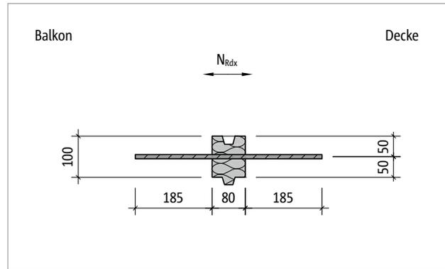
Abb. 255: Schöck Isokorb® T Typ H-NN1: Produktgrundriss
