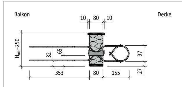
Abb. 158: Schöck Isokorb® T Typ Q-VV1 bis Q-VV5: Produktschnitt
