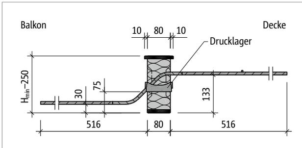
Abb. 155: Schöck Isokorb® T Typ Q-V7 und Q-V8: Produktschnitt
