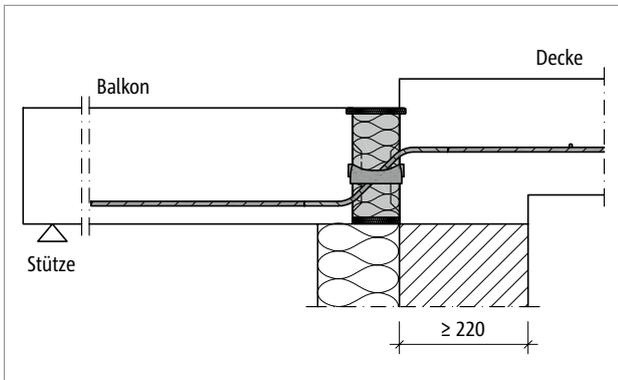
Abb. 144: Schöck Isokorb® T Typ Q: Einbausituation mit kleinem Höhenversprung (z. B. T Typ Q-V6 bis Q-V12)
