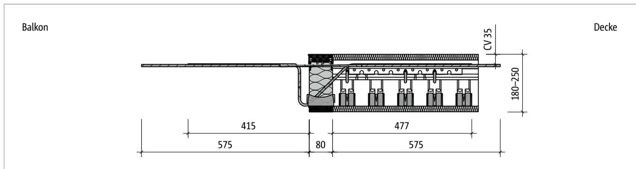
Abb. 229: Schöck Isokorb® T Typ C-M1: Produktschnitt
