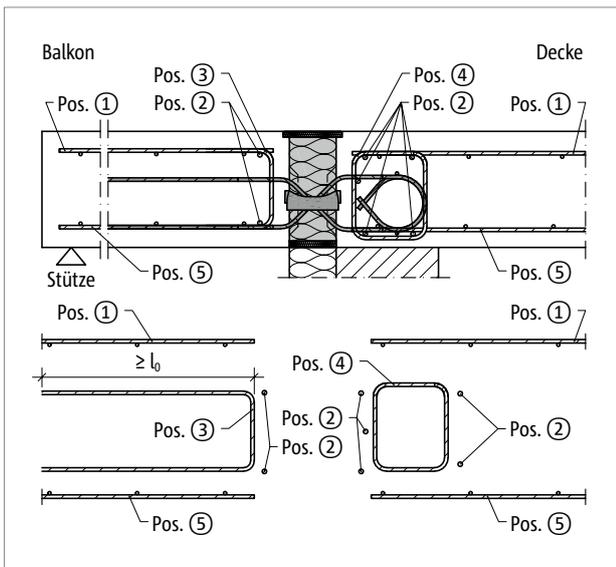
Abb. 167: Schöck Isokorb® T Typ Q-VV1 bis Q-VV5: Bauseitige Bewehrung
