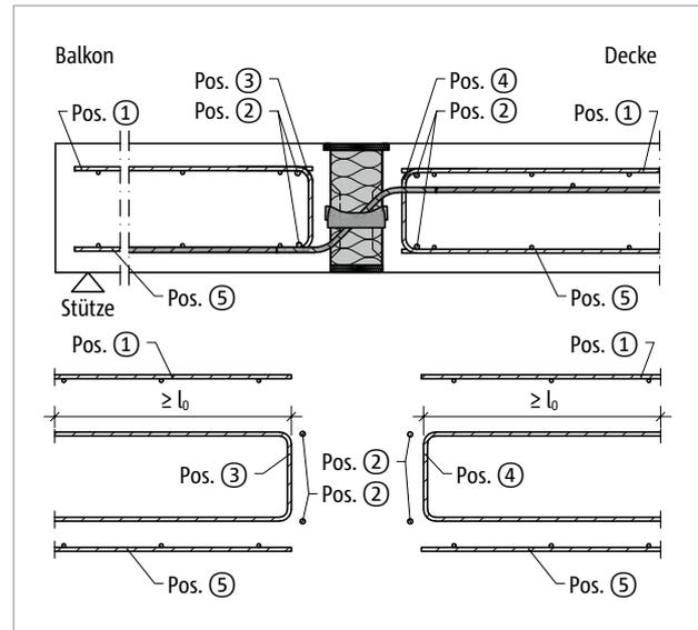
Abb. 172: Schöck Isokorb® T Typ Q-V6 bis Q-V12: Bauseitige Bewehrung
