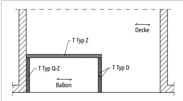
Abb. 273: Schöck Isokorb® T Typ D, Q-Z, Z: Decke einachsig gespannt
