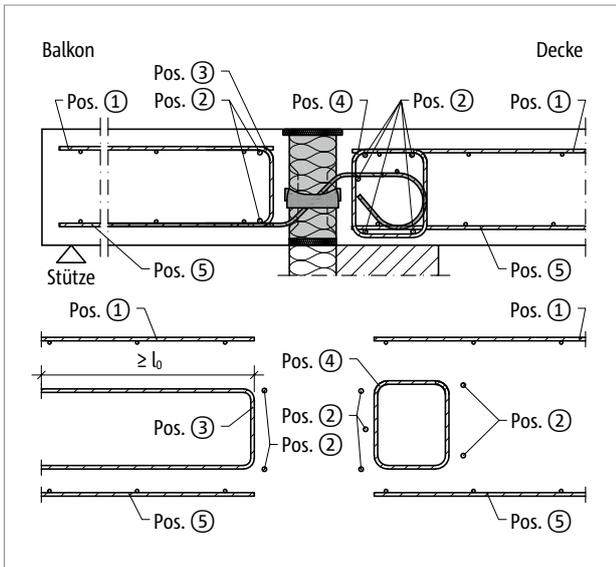
Abb. 165: Schöck Isokorb® T Typ Q-V1 bis Q-V5: Bauseitige Bewehrung
