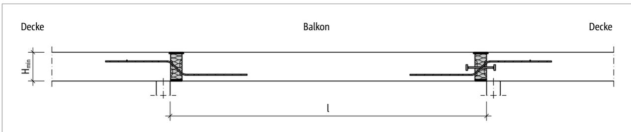
Abb. 190: Schöck Isokorb® T Typ Q-PZ, Q-P: Statisches System
