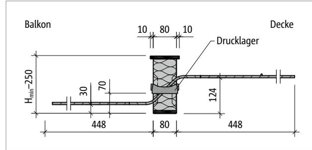
Abb. 154: Schöck Isokorb® T Typ Q-V6: Produktschnitt
