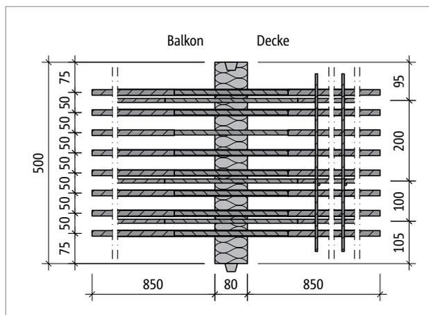
Abb. 47: Schöck Isokorb® T Typ K-M14-V1: Produktgrundriss
