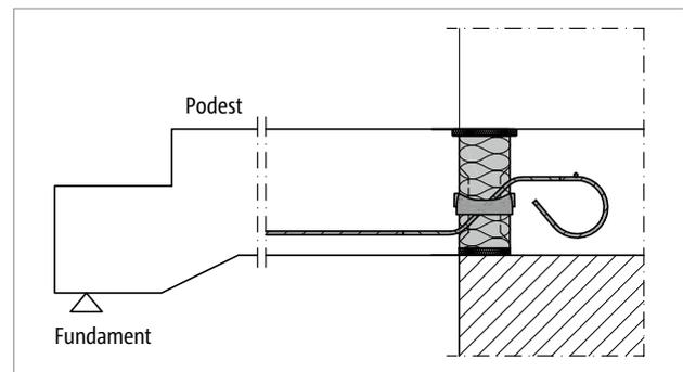
Abb. 141: Schöck Isokorb® T Typ Q: Anschluss Treppenlauf bei einschaligem, wärmedämmendem Mauerwerk (z. B. T Typ Q-V1 bis Q-V5)
