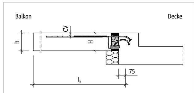
Abb. 97: Schöck Isokorb® T Typ K-O: Statisches System
