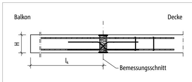
Abb. 278: Schöck Isokorb® T Typ D: Statisches System
