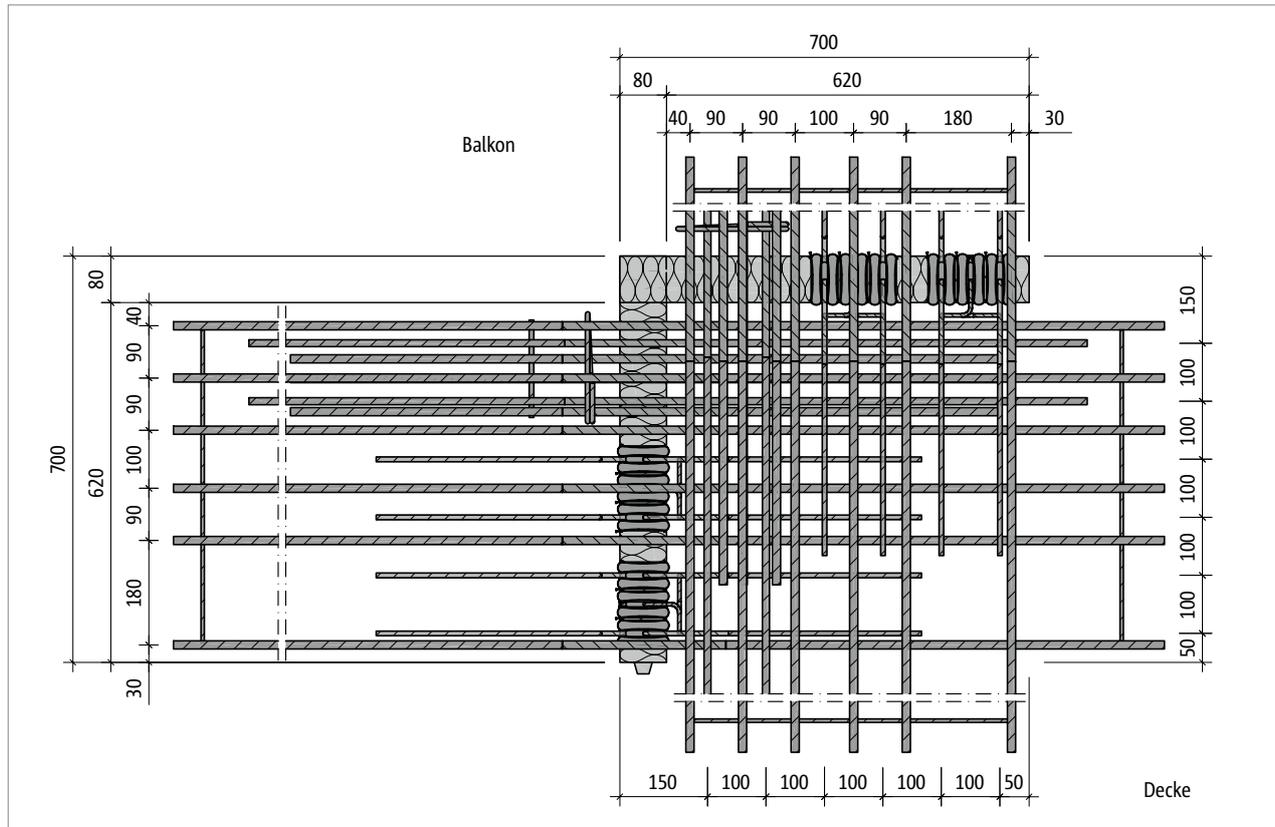
Abb. 234: Schöck Isokorb® T Typ C-M3: Produktgrundriss
