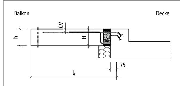
Abb. 100: Schöck Isokorb® T Typ K-O: Statisches System
