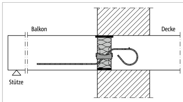
Abb. 138: Schöck Isokorb® T Typ Q: Anschluss bei einschaligem, wärmedämmendem Mauerwerk (z. B. T Typ Q-V1 bis T Typ Q-V5)
