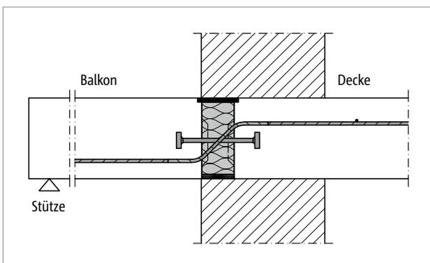
Abb. 187: Schöck Isokorb® T Typ Q-P: Anschluss gestützter Balkon bei einschaligem, wärmedämmendem Mauerwerk
