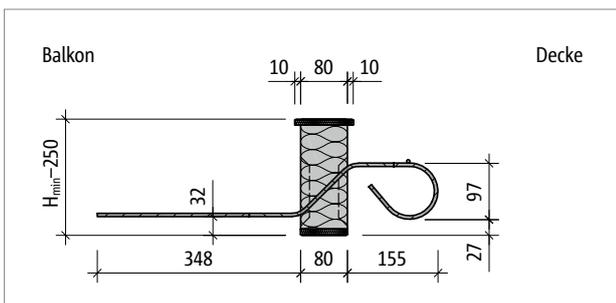
Abb. 161: Schöck Isokorb® T Typ Q-Z-V1 bis Q-Z-V5: Produktschnitt
