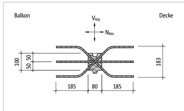
Abb. 259: Schöck Isokorb® T Typ H-VV1-NN1: Produktgrundriss
