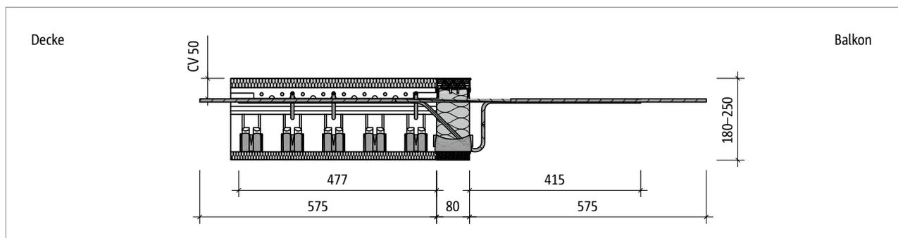
Abb. 230: Schöck Isokorb® T Typ C-M1: Produktschnitt
