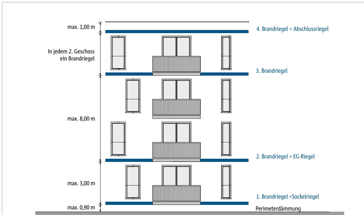
Abb. 2: Mögliche Anordnung von Brandriegeln im WDVS
