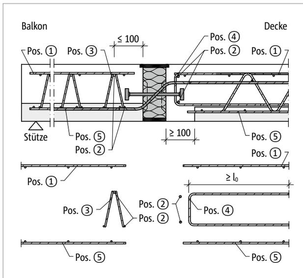
Abb. 213: Schöck Isokorb® T Typ Q-P: Bauseitige Bewehrung mit Gitterträger
