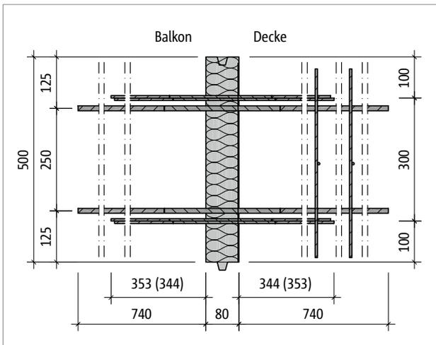
Abb. 283: Schöck Isokorb® T Typ D-MM1-VV1: Grundriss
