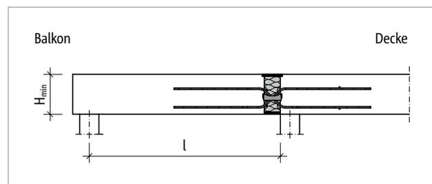
Abb. 150: Schöck Isokorb® T Typ Q-VV: Statisches System (T Typ Q-VV6 bis Q-VV12)
