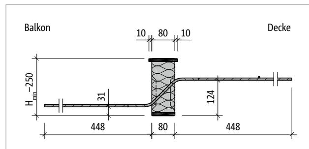
Abb. 162: Schöck Isokorb® T Typ Q-Z-V6: Produktschnitt
