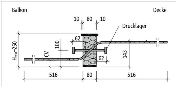
Abb. 196: Schöck Isokorb® T Typ Q-P-V5: Produktschnitt
