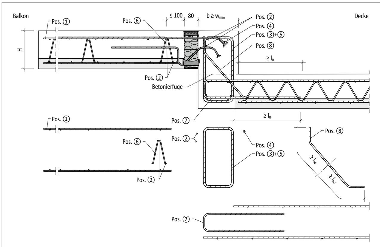
Abb. 132: Schöck Isokorb® T Typ K-O-F: Bauseitige Bewehrung für Balkon mit Höhenversatz nach oben
