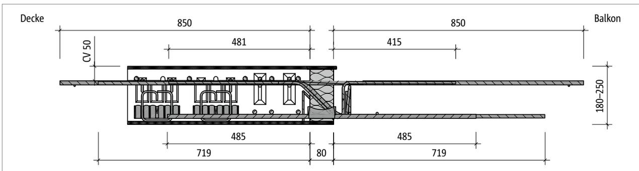
Abb. 233: Schöck Isokorb® T Typ C-M2: Produktschnitt
