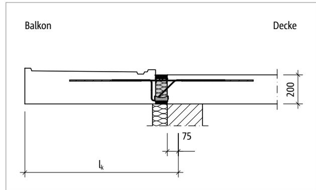
Abb. 64: Schöck Isokorb® T Typ K: Statisches System
