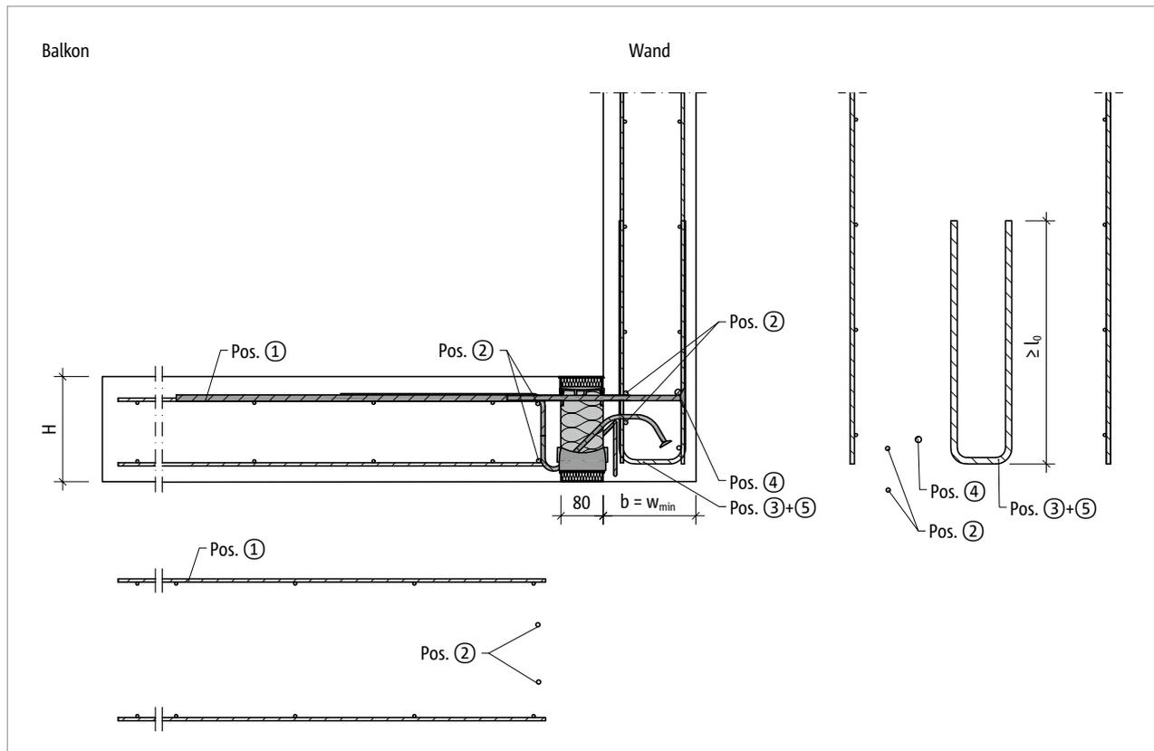
Abb. 115: Schöck Isokorb® T Typ K-U: Bauseitige Bewehrung für Wandanschluss mit minimaler Bauteilabmessung ( $w_{vorh} = w_{min}$ )
