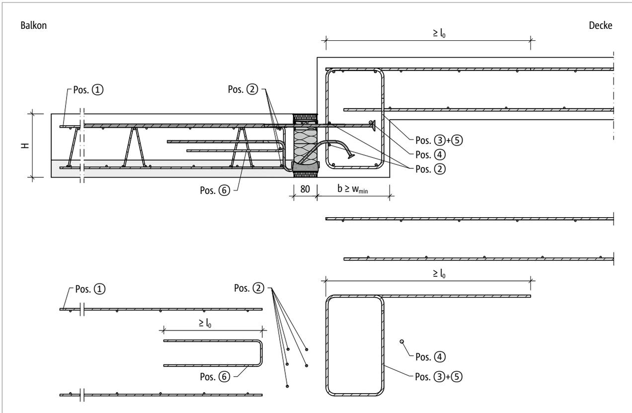
Abb. 127: Schöck Isokorb® T Typ K-U-F: Bauseitige Bewehrung für Balkon mit Höhenveratz nach unten
