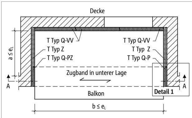
Abb. 215: Schöck Isokorb® T Typ Q-PZ, Q-P: Grundriss Loggia
