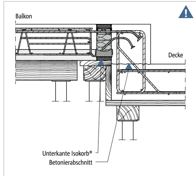
Abb. 134: Schöck Isokorb® T Typ K-O-F: Halbfertigteilbalkon mit Höhenversatz nach oben
