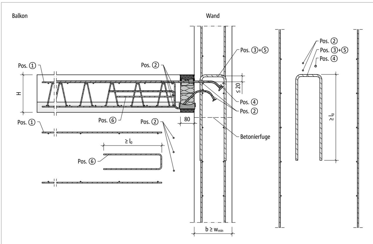
Abb. 130: Schöck Isokorb® T Typ K-O-F: Bauseitige Bewehrung für Wandanschluss nach unten
