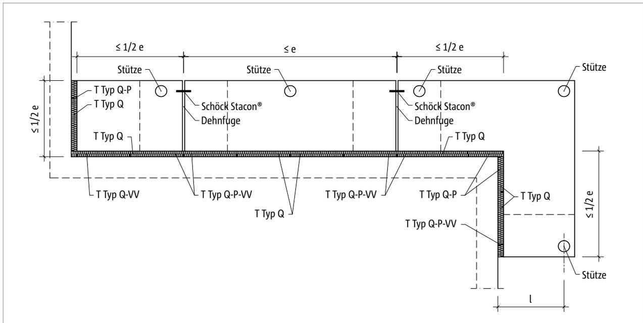
Abb. 193: Schöck Isokorb® T Typ Q-P, Q-P-VV: Dehnfugenanordnung
