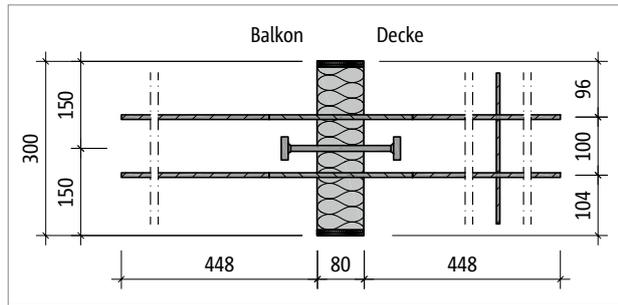
Abb. 204: Schöck Isokorb® T Typ Q-P-V1: Produktgrundriss
