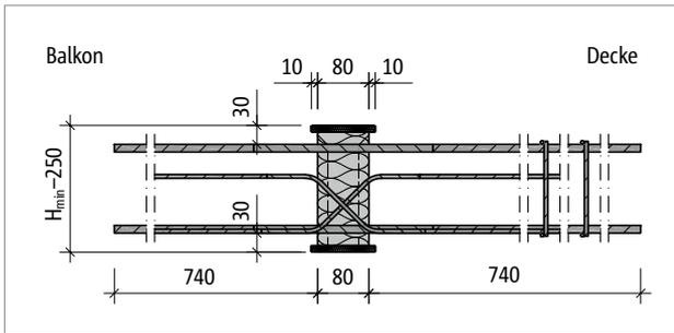
Abb. 280: Schöck Isokorb® T Typ D-MM1-VV1 bei CV30: Produktschnitt
