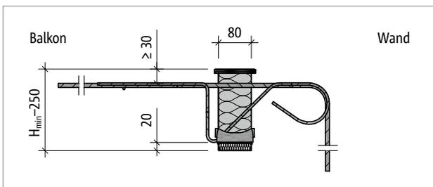
Abb. 84: Schöck Isokorb® T Typ K-WU: Produktschnitt
