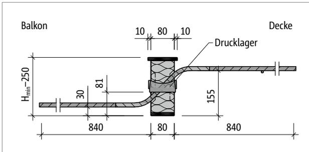
Abb. 157: Schöck Isokorb® T Typ Q-V12: Produktschnitt
