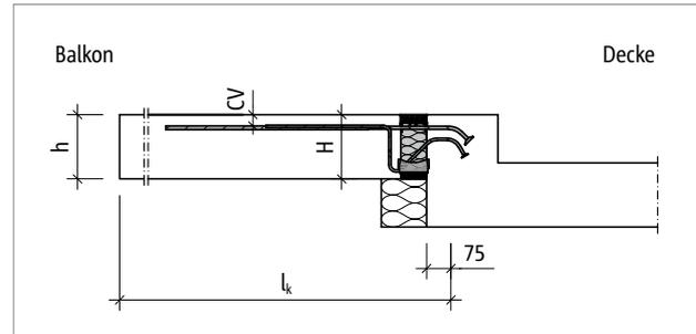
Abb. 102: Schöck Isokorb® T Typ K-O: Statisches System
