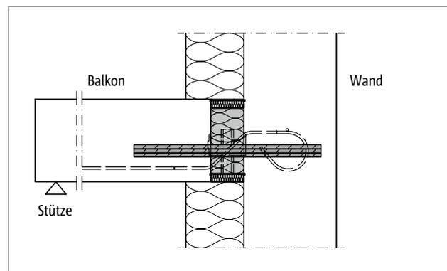
Abb. 249: Schöck Isokorb® T Typ Q, H-VV-NN: Anschluss an einer Stahlbetonwand mit Außendämmung
