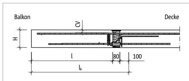
Abb. 226: Schöck Isokorb® T Typ C: Statisches System
