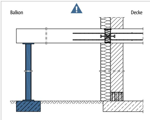
Abb. 220: Schöck Isokorb® T Typ Q-P-VV: Stützung durchgängig erforderlich
