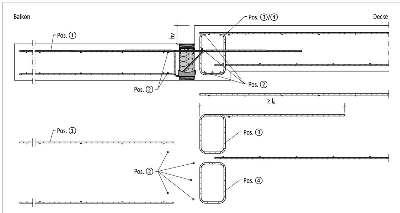
Abb. 112: Schöck Isokorb® T Typ K: Bauseitige Bewehrung für kleinen Höhenversatz
