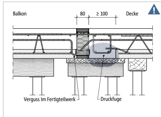
Abb. 77: Schöck Isokorb® T Typ K-F: Einbau in Verbindung mit Halffertigteilplatten (hier:  $h \leq 170$  mm), indirekte Lagerung, Druckfuge deckenseitig
