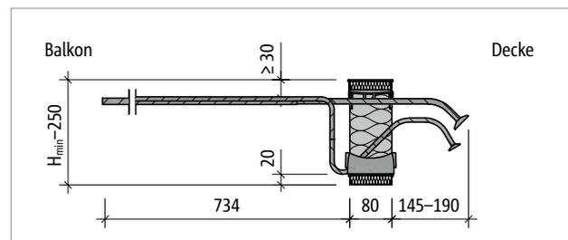
Abb. 83: Schöck Isokorb® T Typ K-O: Produktschnitt
