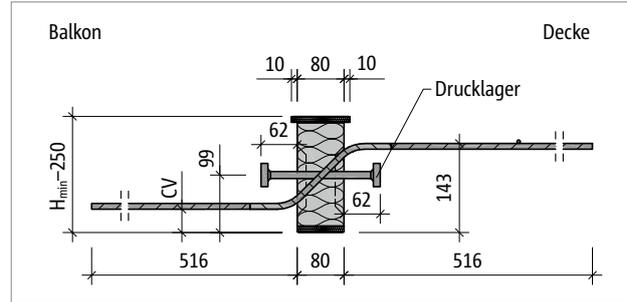
Abb. 195: Schöck Isokorb® T Typ Q-P-V4: Produktschnitt
