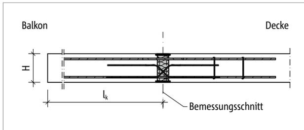
Abb. 277: Schöck Isokorb® T Typ D: Statisches System
