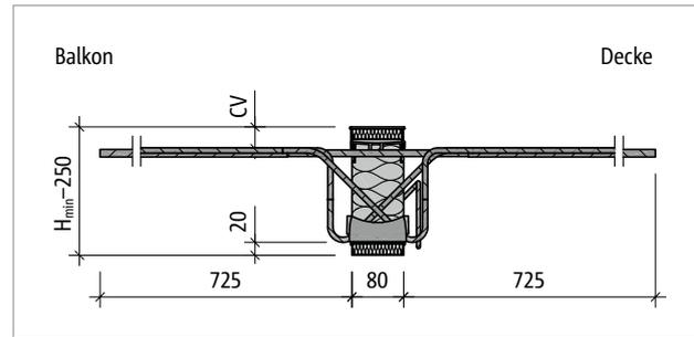
Abb. 40: Schöck Isokorb® T Typ K-M6-VV1: Produktschnitt
