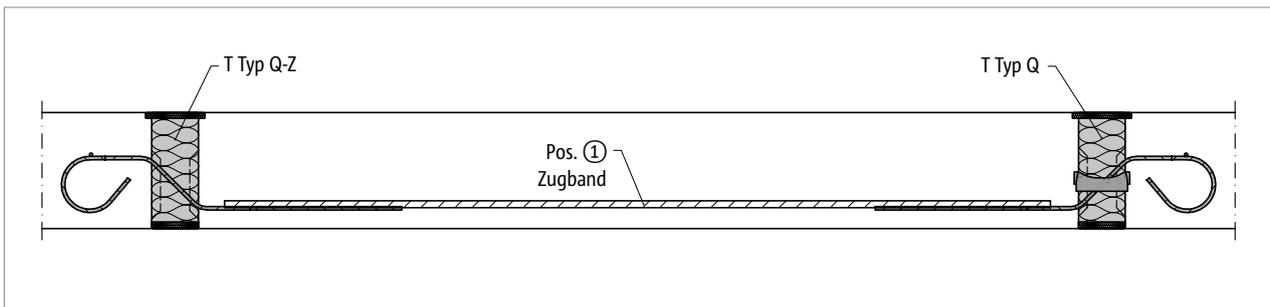
Abb. 178: Schöck Isokorb® T Typ Q-Z-V1 bis Q-Z-V5, Q-V1 bis Q-V5: Schnitt A-A; einachsig gespannte Stahlbetonplatte
