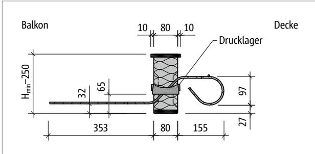
Abb. 153: Schöck Isokorb® T Typ Q-V1 bis Q-V5: Produktschnitt
