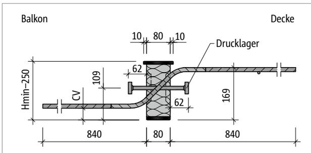
Abb. 200: Schöck Isokorb® T Typ Q-P-VV8 bis Q-P-VV9: Produktschnitt
