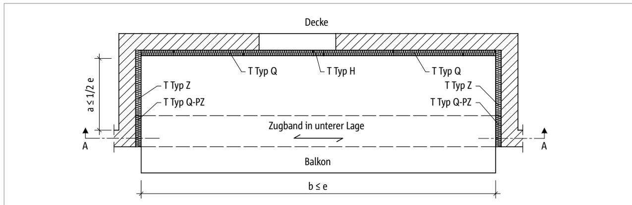
Abb. 218: Schöck Isokorb® T Typ Q-PZ, Q: Grundriss Loggia
