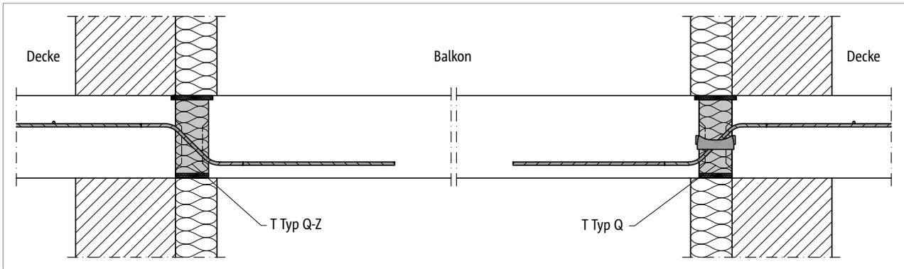
Abb. 145: Schöck Isokorb® T Typ Q-Z, Q: Anwendungsfall einachsig gespannte Stahlbetonplatte
