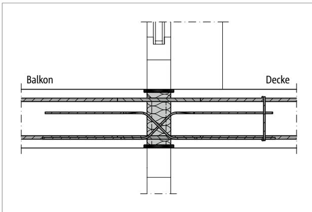
Abb. 275: Schöck Isokorb® T Typ D: Einbauschnitt; einachsig gespannte Decke
