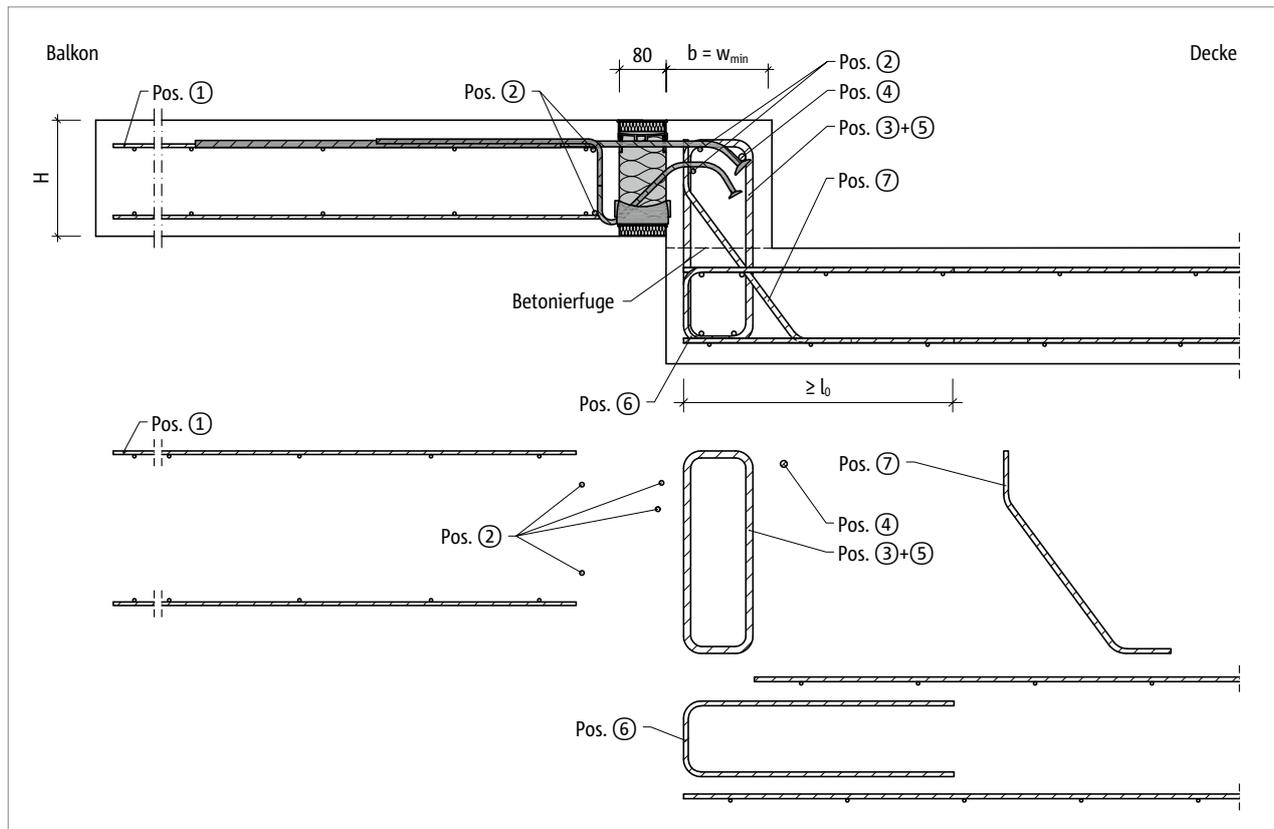
Abb. 117: Schöck Isokorb® T Typ K-O: Bauseitige Bewehrung für Balkon mit Höhenversatz nach oben mit minimaler Bauteilabmessung ( $w_{vorh} = w_{min}$ )
