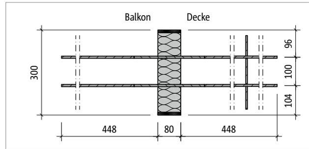
Abb. 205: Schöck Isokorb® T Typ Q-PZ-V1: Produktgrundriss
