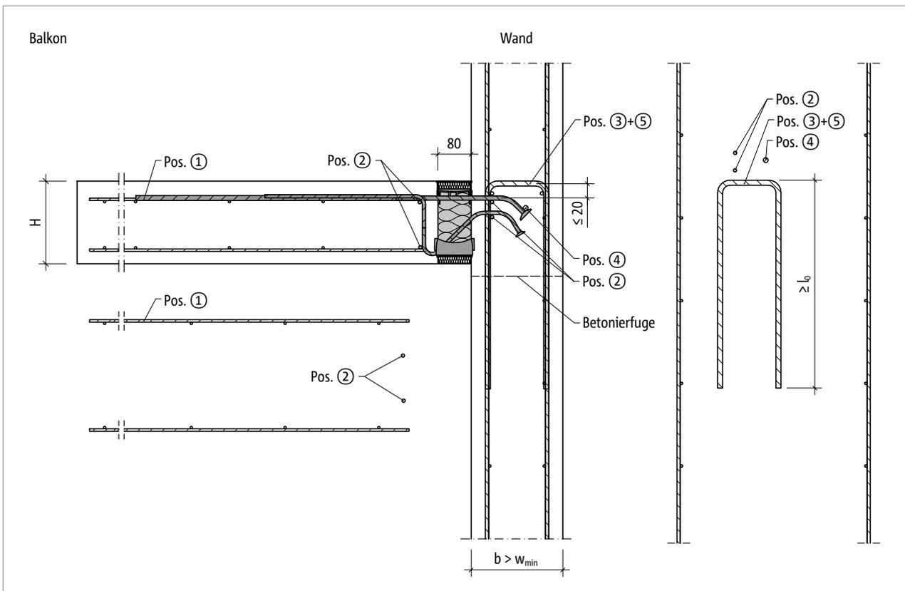
Abb. 120: Schöck Isokorb® T Typ K-O: Bauseitige Bewehrung für Wandanschluss mit größerer Bauteilabmessung ( $w_{vorh} > w_{min}$ )
