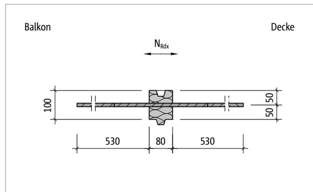
Abb. 257: Schöck Isokorb® T Typ H-NN2: Produktgrundriss
