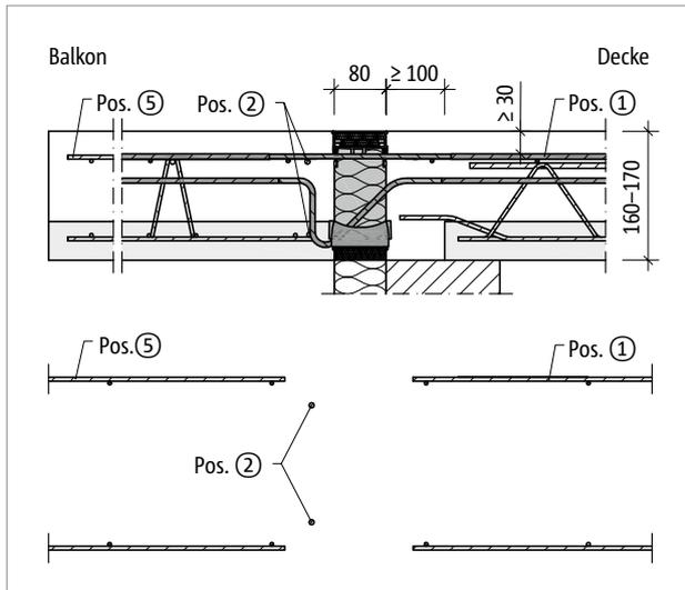
Abb. 69: Schöck Isokorb® T Typ K-F: Bauseitige Bewehrung bei Balkonplattendicke  $h = 160-170$  mm
