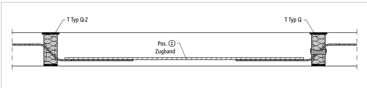
Abb. 179: Schöck Isokorb® T Typ Q-Z-V6 bis Q-Z-V12, Q-V6 bis Q-V12: Schnitt A-A; einachsig gespannte Stahlbetonplatte
