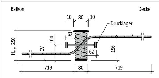
Abb. 198: Schöck Isokorb® T Typ Q-P-V7: Produktschnitt
