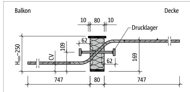
Abb. 199: Schöck Isokorb® T Typ Q-P-V8 bis Q-P-V9: Produktschnitt
