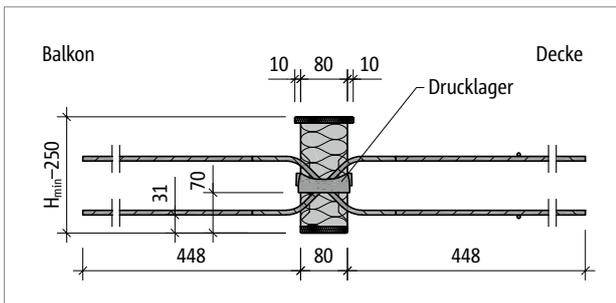
Abb. 159: Schöck Isokorb® T Typ Q-VV6: Produktschnitt
