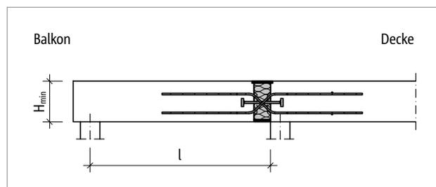
Abb. 191: Schöck Isokorb® T Typ Q-P-VV: Statisches System
