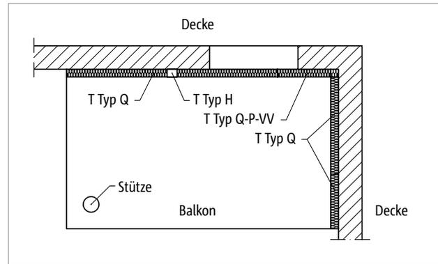
Abb. 183: Schöck Isokorb® T Typ Q, Q-P-VV: Balkon zweiseitig gelagert mit Stütze und abhebenden Querkräften
