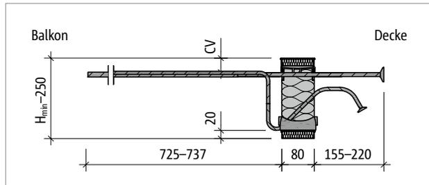
Abb. 104: Schöck Isokorb® T Typ K-U-M2: Produktschnitt
