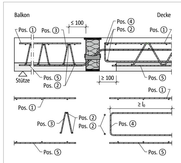
Abb. 176: Schöck Isokorb® T Typ Q-V6 bis Q-V12: Bauseitige Bewehrung mit Gitterträger
