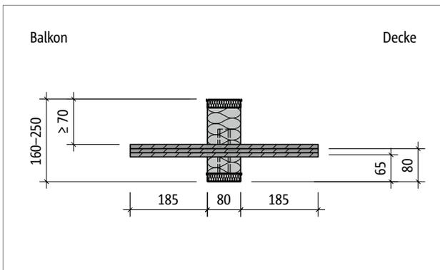
Abb. 258: Schöck Isokorb® T Typ H-VV1-NN1: Produktschnitt
