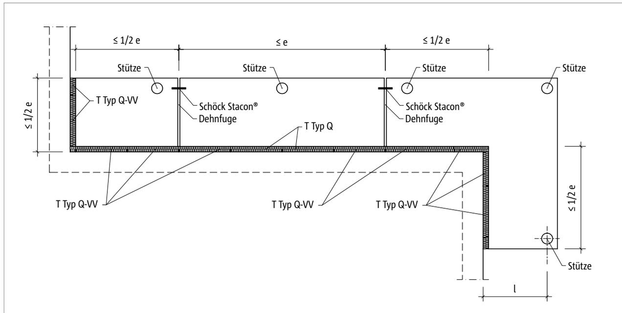
Abb. 152: Schöck Isokorb® T Typ Q, Q-VV: Dehnfugenanordnung
