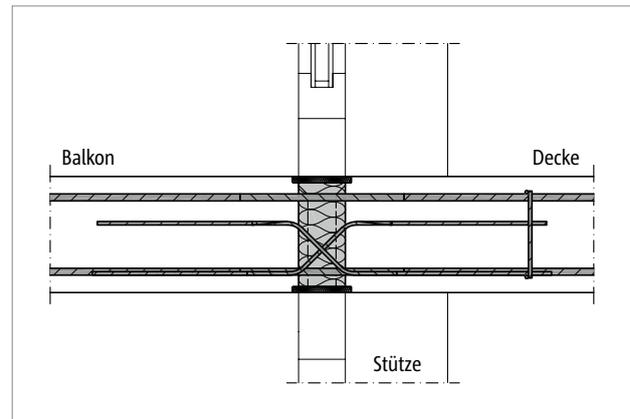
Abb. 276: Schöck Isokorb® T Typ D: Einbauschnitt; Flachdecke
