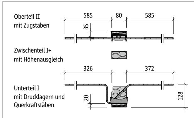
Abb. 65: Schöck Isokorb® T Typ K-F-M1-V1-CV35 bis K-F-M6-V1-CV35
