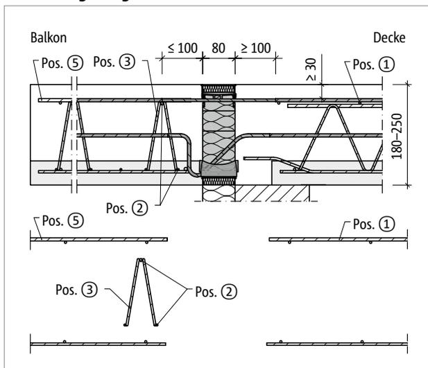
Abb. 71: Schöck Isokorb® T Typ K-F: Bauseitige Bewehrung bei Balkonplattendicke  $h = 180-250$  mm (Pos.2:  $2\phi 8$ ); Variante mit Gitterträger
