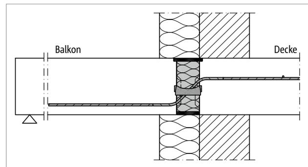
Abb. 139: Schöck Isokorb® T Typ Q: Anschluss bei Wärmedämmverbundsystem (WDVS) (z. B. T Typ Q-V6 bis Q-V12)
