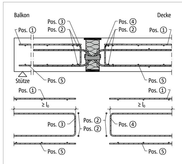
Abb. 174: Schöck Isokorb® T Typ Q-VV6 bis Q-VV12: Bauseitige Bewehrung
