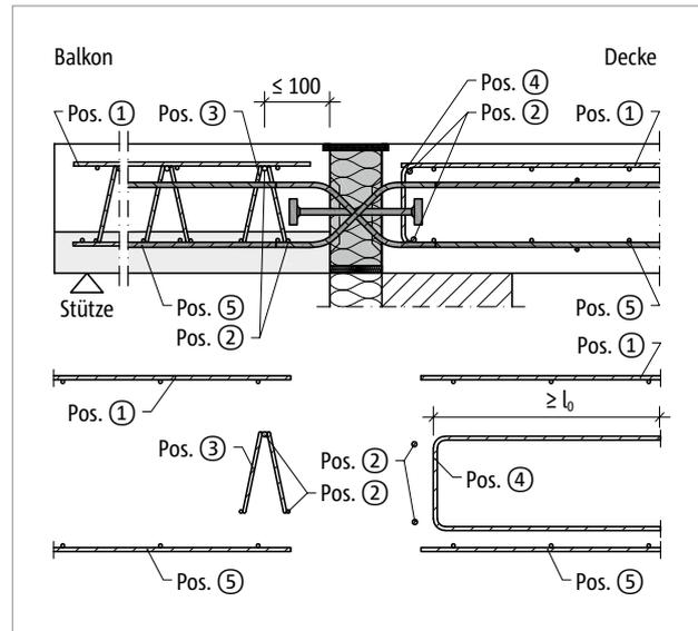
Abb. 210: Schöck Isokorb® T Typ Q-P-VV: Bauseitige Bewehrung, balkonseitig mit Gitterträger
