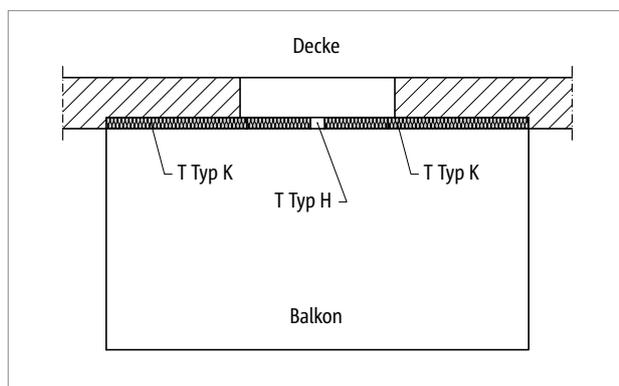
Abb. 246: Schöck Isokorb® T Typ H: Balkon frei auskragend
