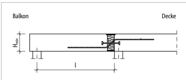
Abb. 189: Schöck Isokorb® T Typ Q-P: Statisches System
