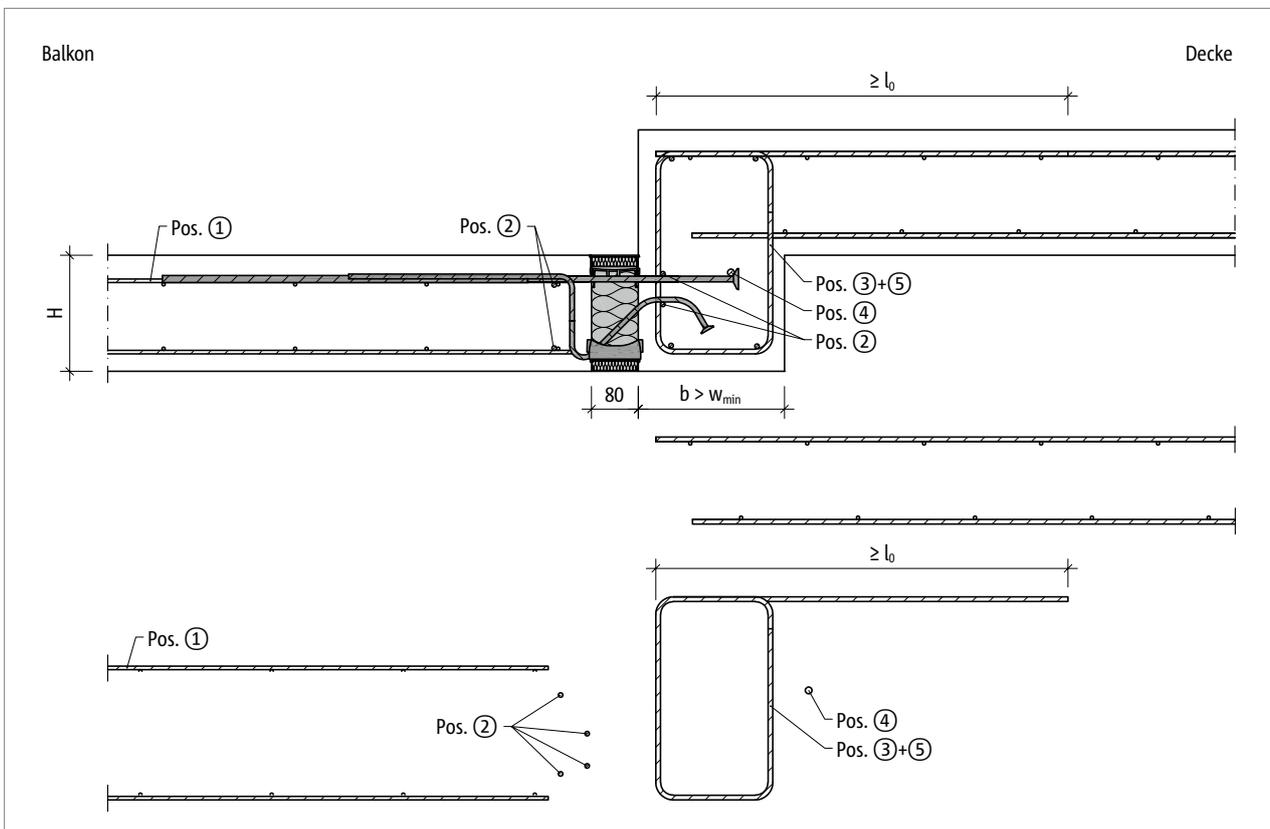
Abb. 114: Schöck Isokorb® T Typ K-U: Bauseitige Bewehrung für Balkon mit Höhenversatz nach unten mit größerer Bauteilabmessung ( $w_{vorh} > w_{min}$ )
