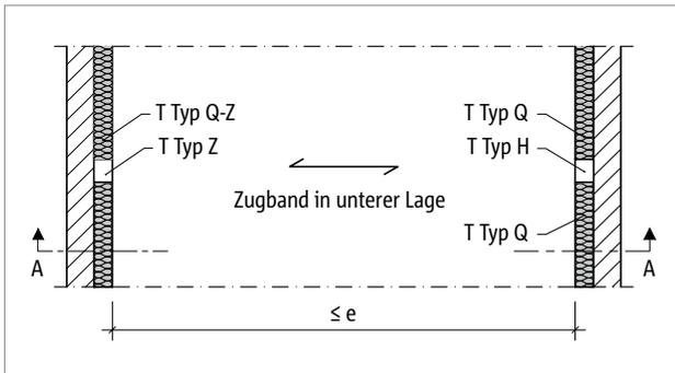
Abb. 177: Schöck Isokorb® T Typ Q-Z, Q, Z: Einachsig gespannte Stahlbetonplatte
