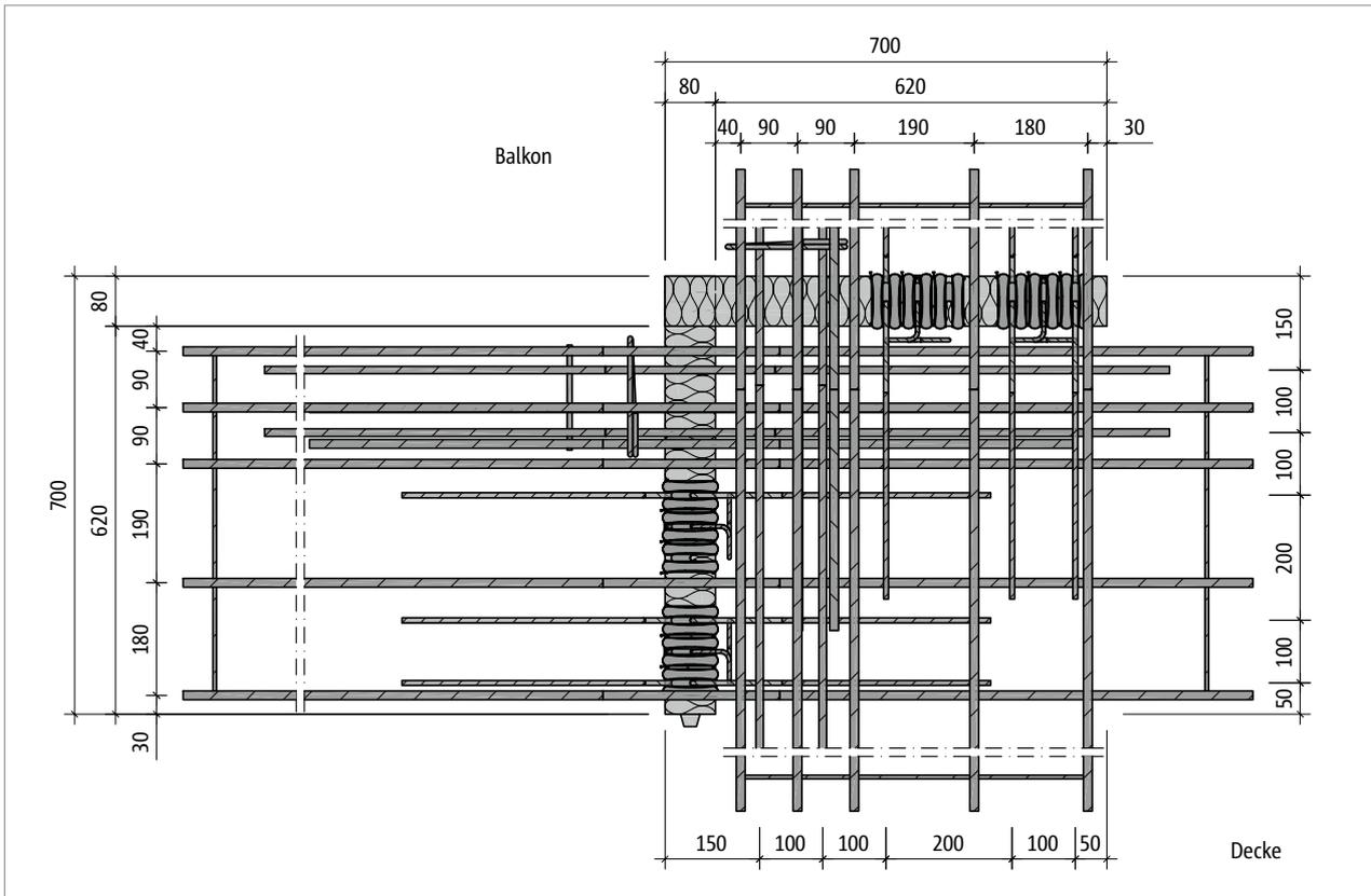
Abb. 231: Schöck Isokorb® T Typ C-M2: Produktgrundriss
