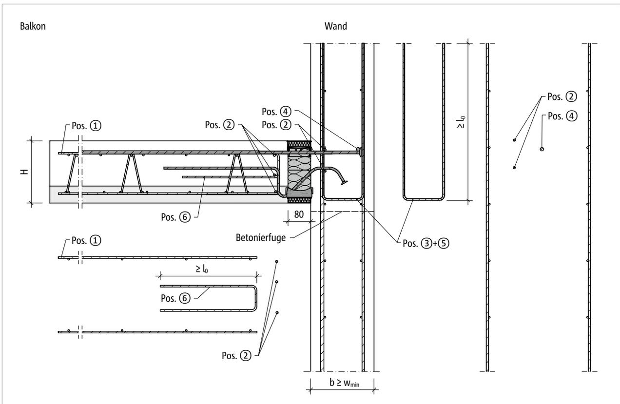
Abb. 128: Schöck Isokorb® T Typ K-U-F: Bauseitige Bewehrung für Wandanschluss nach oben
