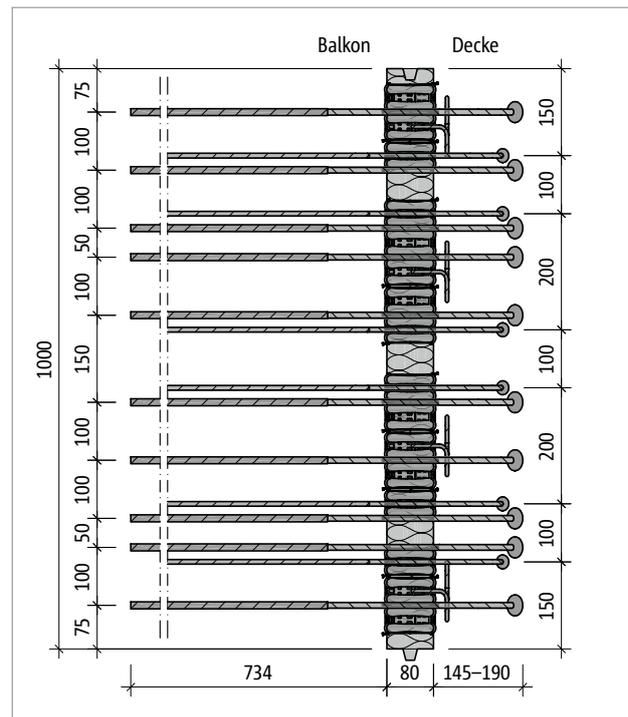
Abb. 111: Schöck Isokorb® T Typ K-O-M4: Produktgrundriss
