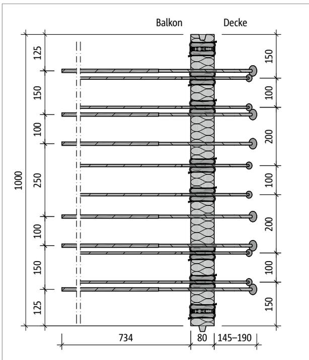
Abb. 110: Schöck Isokorb® T Typ K-O-M2: Produktgrundriss
