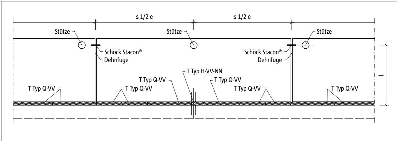
Abb. 252: Schöck Isokorb® T Typ H: Dehnfugenanordnung bei einem Typ H
