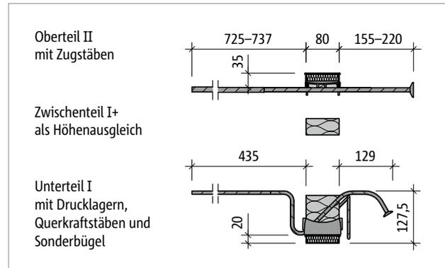
Abb. 124: Schöck Isokorb® T Typ K-U-F-M3-V1-CV35 bis K-U-F-M4-V1-CV35
