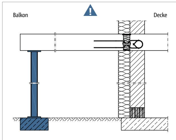
Abb. 180: Schöck Isokorb® T Typ Q-VV: Stützung durchgängig erforderlich
