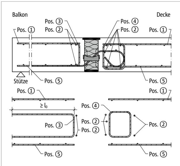
Abb. 171: Schöck Isokorb® T Typ Q-V1 bis Q-V5: Bauseitige Bewehrung
