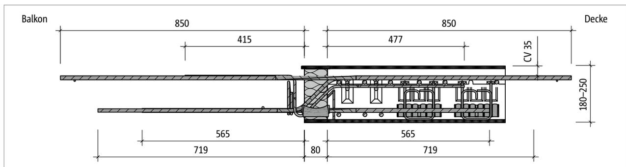
Abb. 235: Schöck Isokorb® T Typ C-M3: Produktschnitt
