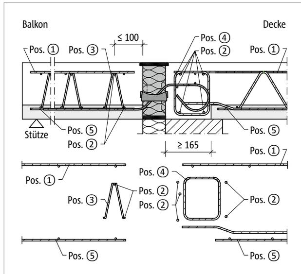
Abb. 169: Schöck Isokorb® T Typ Q-V1 bis Q-V5: Bauseitige Bewehrung mit Gitterträger
