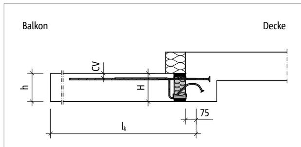
Abb. 96: Schöck Isokorb® T Typ K-U: Statisches System
