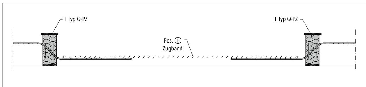
Abb. 219: Schöck Isokorb® T Typ Q-PZ: Schnitt A-A; Bewehrungsanschluss Zugband
