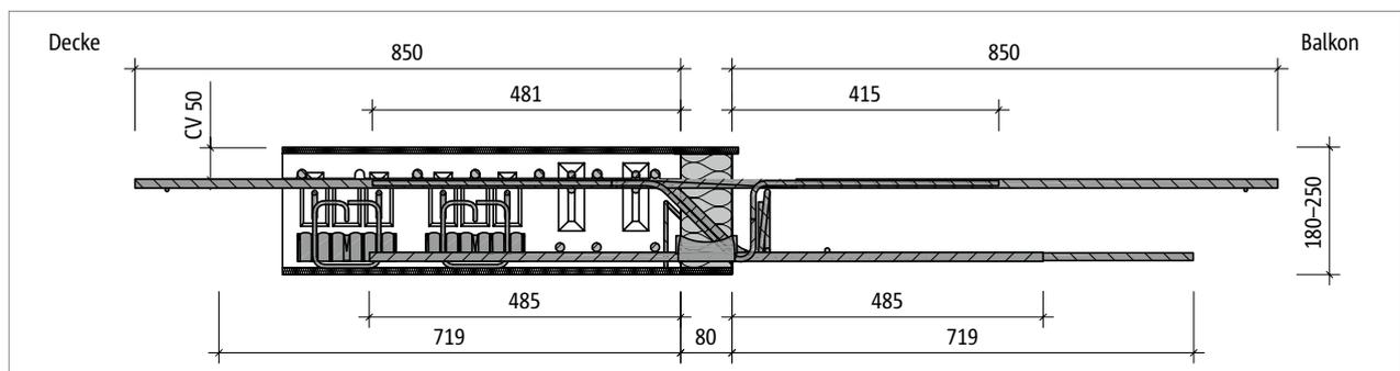
Abb. 236: Schöck Isokorb® T Typ C-M3: Produktschnitt
