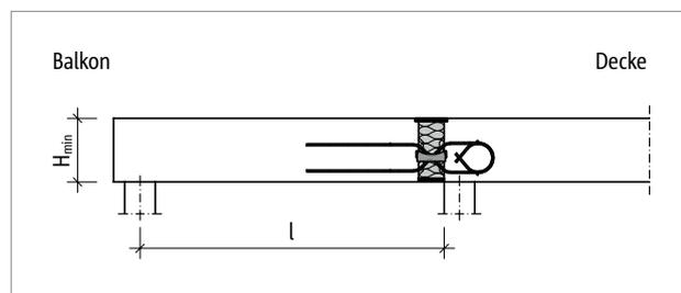
Abb. 149: Schöck Isokorb® T Typ Q-VV: Statisches System (T Typ Q-VV1 bis Q-VV5)
