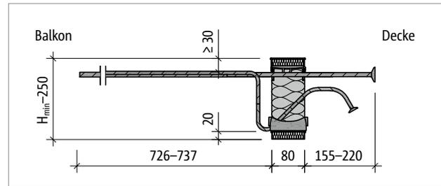
Abb. 80: Schöck Isokorb® T Typ K-U: Produktschnitt
