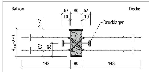
Abb. 201: Schöck Isokorb® T Typ Q-P-VV1 bis Q-P-VV3: Produktschnitt
