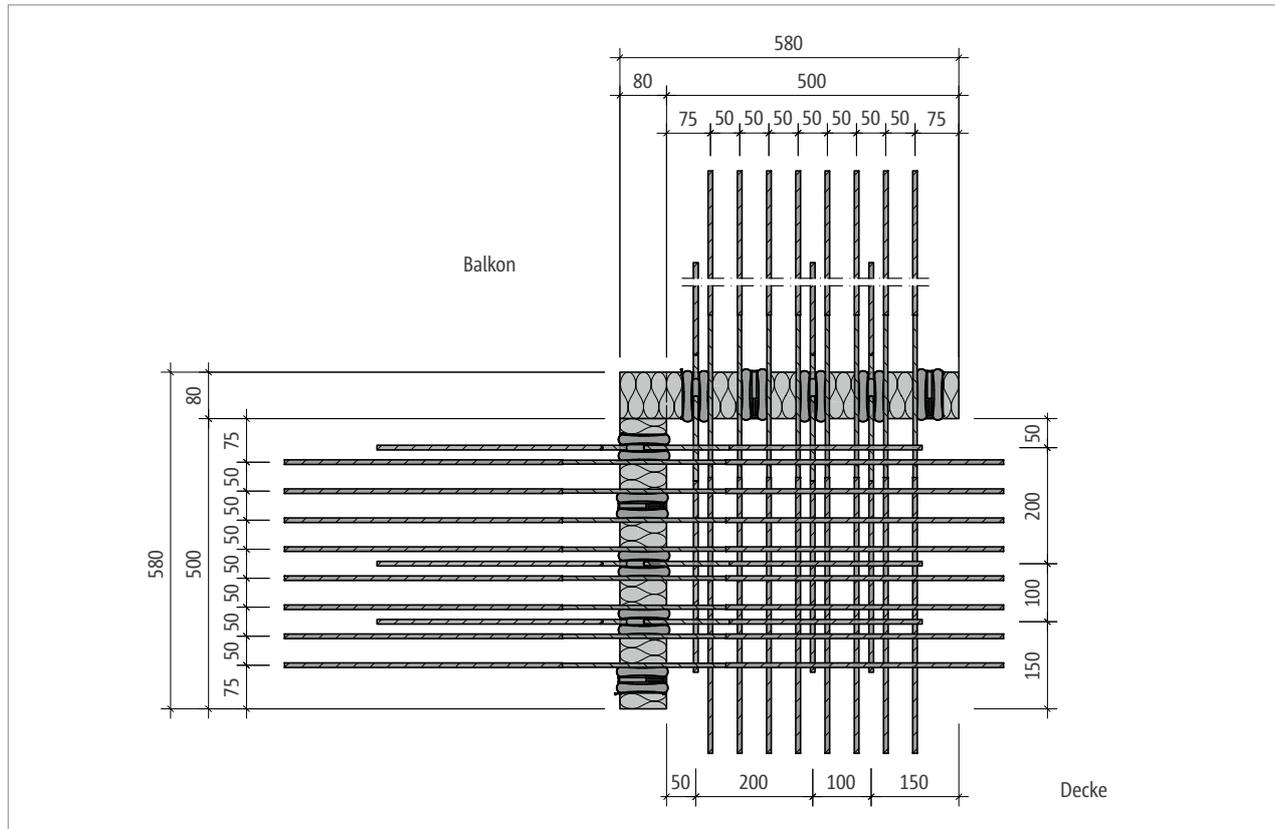
Abb. 228: Schöck Isokorb® T Typ C-M1: Produktgrundriss
