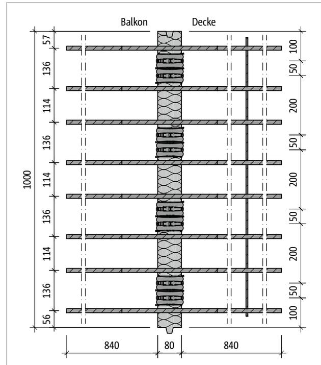
Abb. 164: Schöck Isokorb® T Typ Q-V12: Produktgrundriss
