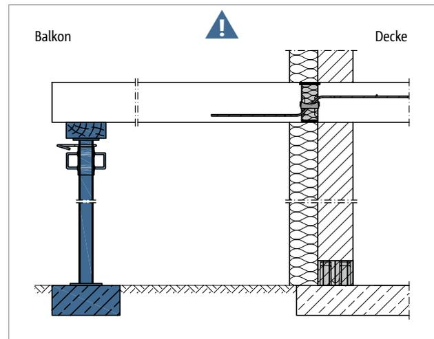
Abb. 181: Schöck Isokorb® T Typ Q: Stützung durchgängig erforderlich
