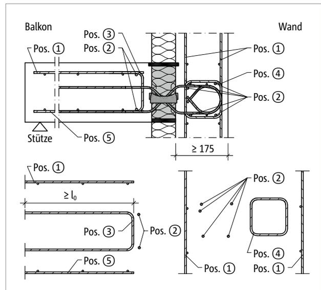
Abb. 168: Schöck Isokorb® T Typ Q-VV1 bis Q-VV5: Bauseitige Bewehrung in Wand
