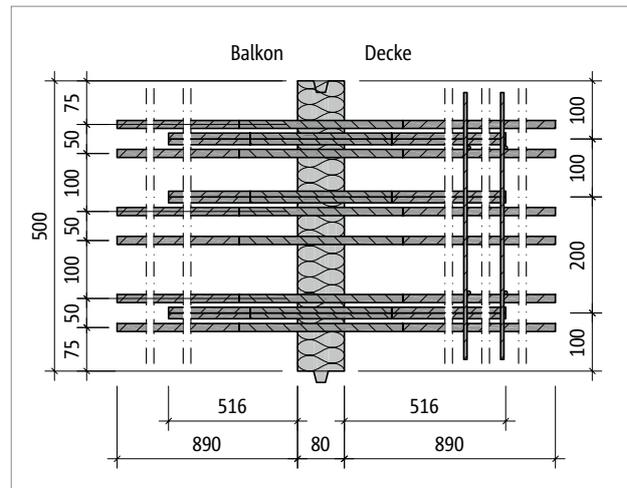
Abb. 284: Schöck Isokorb® T Typ D-MM6-VV3: Grundriss
