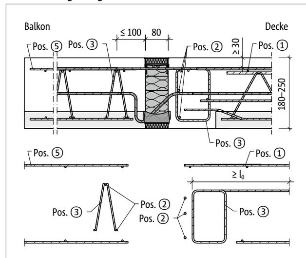
Abb. 75: Schöck Isokorb® T Typ K-F: Bauseitige Bewehrung bei Balkonplattendicke  $h = 180\text{--}250\text{ mm}$  (Pos.2:  $5\varnothing 8$ ); Variante mit Gitterträger
