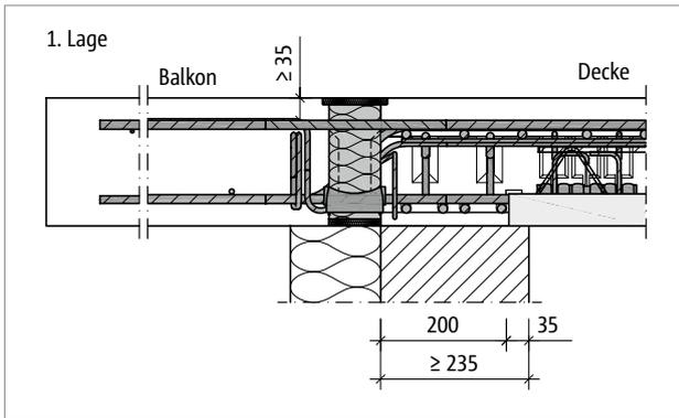
Abb. 240: Schöck Isokorb® T Typ C: Halbfertigteilplatte ohne Randunterstützung mit WDVS (Schnitt T Typ C-CV35-1. Lage, Ansicht T Typ C-CV50-2. Lage)
