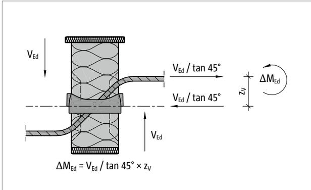
Abb. 151: Schöck Isokorb® T Typ Q: Momente aus exzentrischem Anschluss
