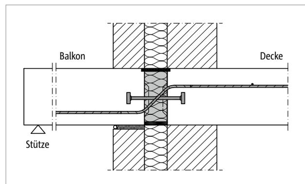
Abb. 188: Schöck Isokorb® T Typ Q-P: Anschluss gestützter Balkon bei zweisechaligem Mauerwerk mit Kerndämmung
