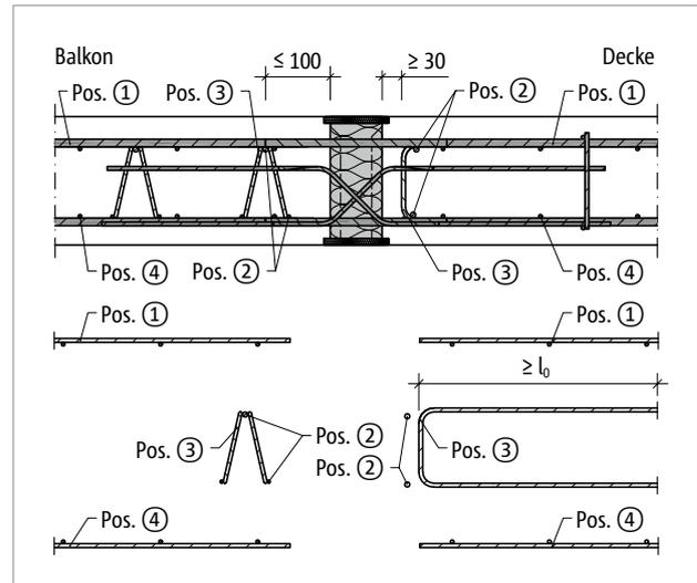
Abb. 286: Schöck Isokorb® T Typ D: Bauseitige Bewehrung mit Gitterträger
