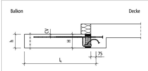
Abb. 99: Schöck Isokorb® T Typ K-U: Statisches System
