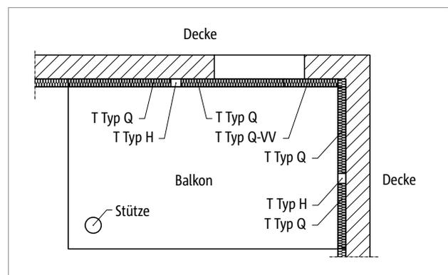
Abb. 247: Schöck Isokorb® T Typ H: Balkon zweiseitig aufliegend mit Stütze
