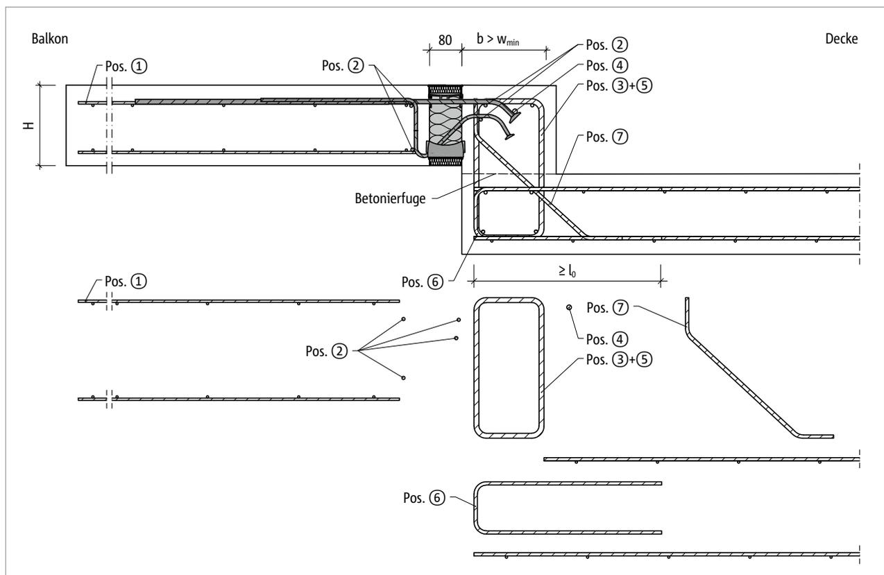
Abb. 118: Schöck Isokorb® T Typ K-O-F: Bauseitige Bewehrung für Balkon mit Höhenversatz nach oben mit größerer Bauteilabmessung ( $w_{vorh} > w_{min}$ )
