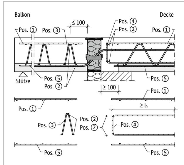
Abb. 170: Schöck Isokorb® T Typ Q-V6 bis Q-V12: Bauseitige Bewehrung mit Gitterträger
