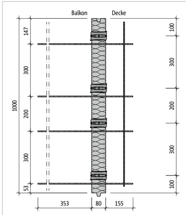
Abb. 163: Schöck Isokorb® T Typ Q-V1: Produktgrundriss
