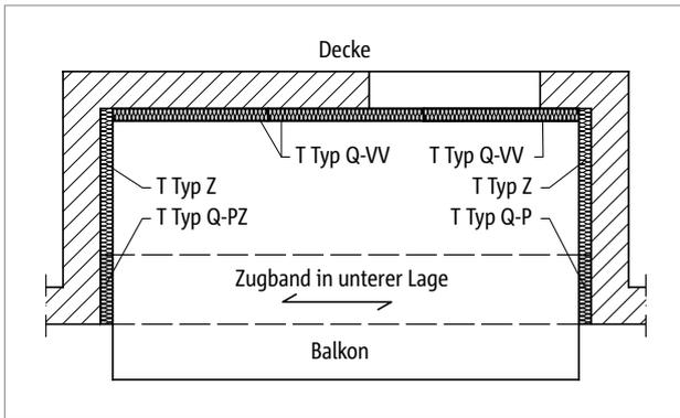
Abb. 182: Schöck Isokorb® T Typ Q-VV, Q-P, Q-PZ: Dreiseitig gelagerte Loggia mit Zugband
