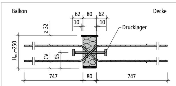
Abb. 202: Schöck Isokorb® T Typ Q-P-VV8 bis Q-P-VV9: Produktschnitt
