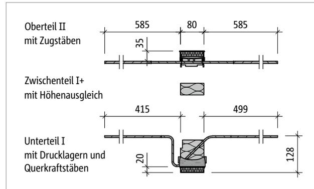
Abb. 66: Schöck Isokorb® T Typ K-F-M1-V2-CV35 bis K-F-M6-V2-CV35
