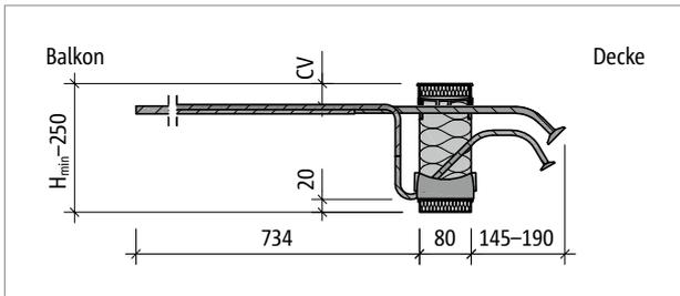
Abb. 108: Schöck Isokorb® T Typ K-O-M2: Produktschnitt
