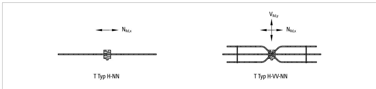
Abb. 250: Schöck Isokorb® T Typ H: Typenauswahl
