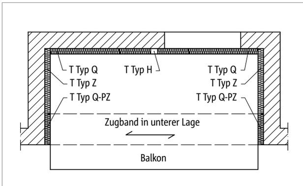
Abb. 184: Schöck Isokorb® T Typ Q, Q-PZ: Dreiseitig gelagerte Loggia - symmetrisch mit Zugband
