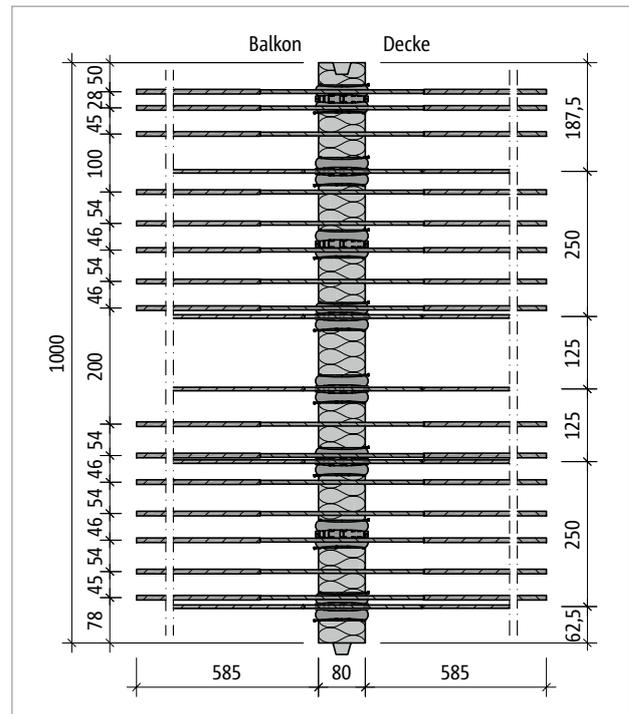
Abb. 38: Schöck Isokorb® T Typ K-M6-V1: Produktgrundriss
