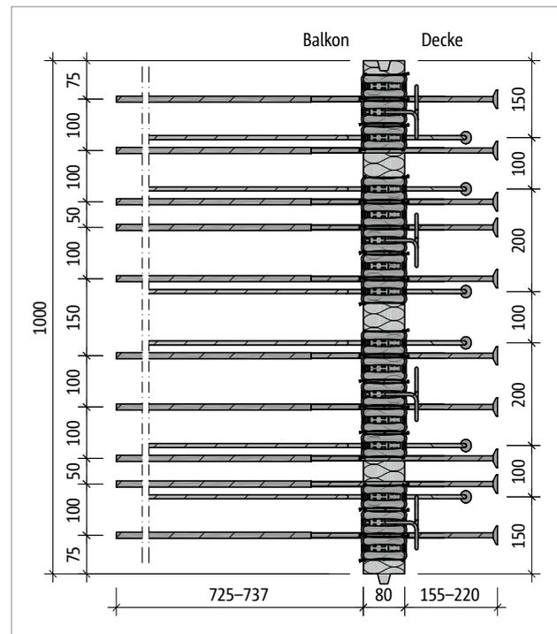
Abb. 107: Schöck Isokorb® T Typ K-U-M4: Produktgrundriss
