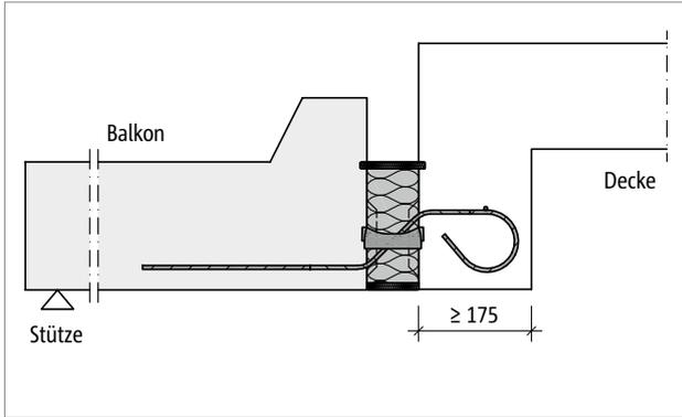
Abb. 142: Schöck Isokorb® T Typ Q: Einbausituation „Balkonplatte als Fertigteil“ (z. B. T Typ Q-V1 bis Q-V5)
