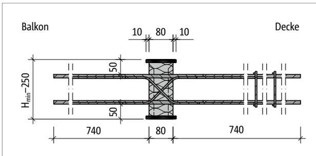
Abb. 282: Schöck Isokorb® T Typ D-MM1-VV1 bei CV50: Produktschnitt
