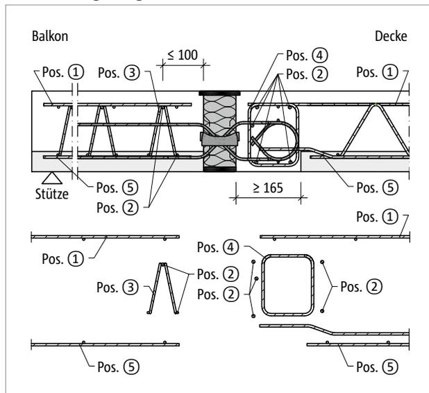
Abb. 175: Schöck Isokorb® T Typ Q-VV1 bis Q-VV5: Bauseitige Bewehrung mit Gitterträger
