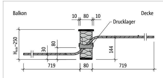
Abb. 156: Schöck Isokorb® T Typ Q-V9 bis Q-V11: Produktschnitt
