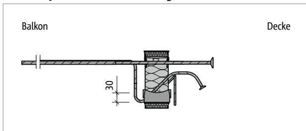
Abb. 8: Schöck Isokorb® T Typ K-U-M4: Produktschnitt
