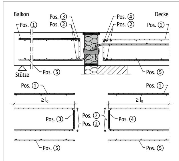
Abb. 166: Schöck Isokorb® T Typ Q-V6 bis Q-V12: Bauseitige Bewehrung
