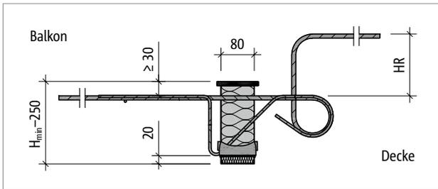
Abb. 79: Schöck Isokorb® T Typ K-HV: Produktschnitt
