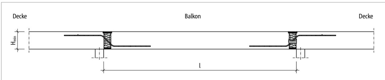
Abb. 148: Schöck Isokorb® T Typ Q-Z, Q: Statisches System (T Typ Q-Z-V6 bis Q-Z-V12, Q-V6 bis Q-V12)
