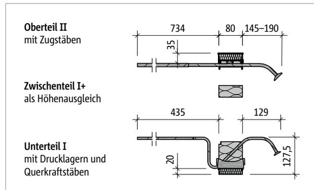
Abb. 125: Schöck Isokorb® T Typ K-O-F-M1-V1-CV35 bis K-O-F-M3-V1-CV35
