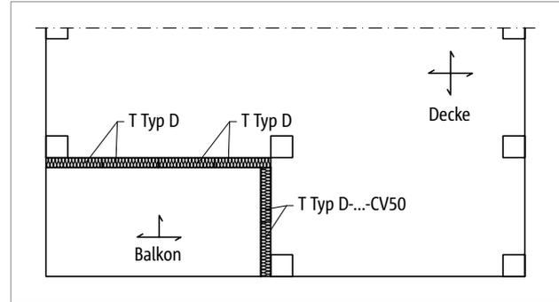
Abb. 274: Schöck Isokorb® T Typ D: Einsatz in Flachdecken
