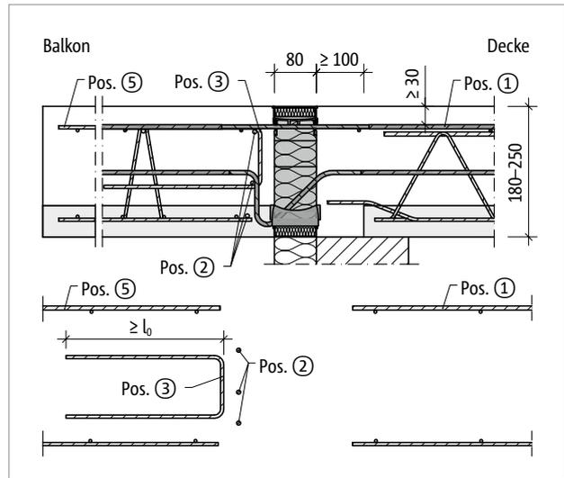
Abb. 70: Schöck Isokorb® T Typ K-F: Bauseitige Bewehrung bei Balkonplattendicke  $h = 180-250$  mm; Variante mit Steckbügel
