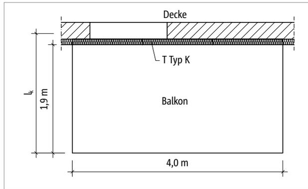
Abb. 63: Schöck Isokorb® T Typ K: Grundriss
