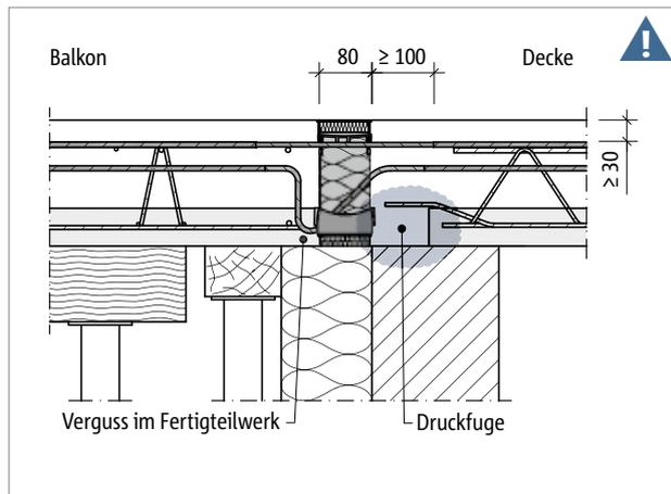
Abb. 76: Schöck Isokorb® T Typ K-F: Einbau in Verbindung mit Halffertigteilplatten (hier:  $h \leq 170$  mm), direkte Lagerung, Druckfuge deckenseitig
