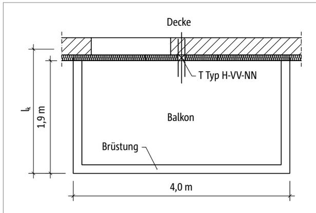
Abb. 262: Schöck Isokorb® T Typ K, H: Grundriss
