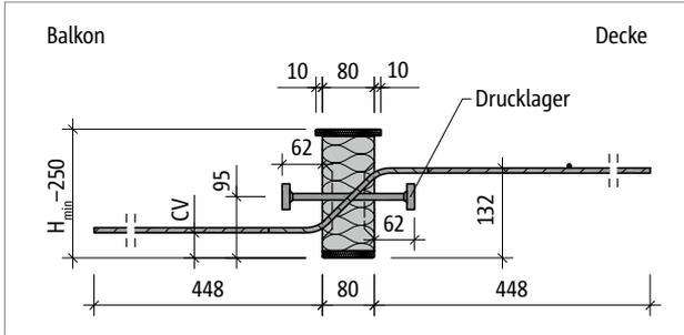
Abb. 194: Schöck Isokorb® T Typ Q-P-V1 bis Q-P-V3: Produktschnitt
