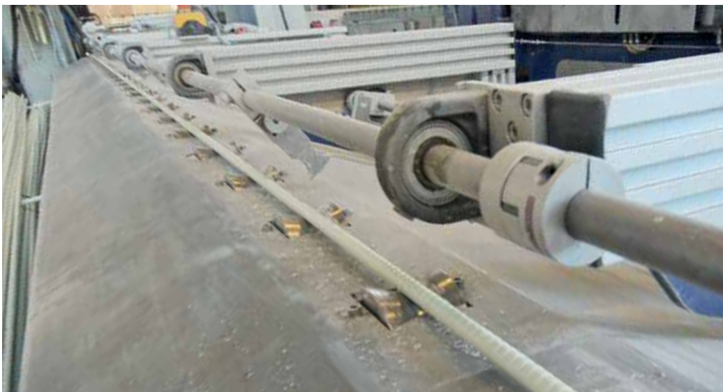
„Schöck Combar®“ gamybos procesas, kuris optimizuotas taip, kad būtų išpildyti armatūros strypams keliami reikalavimai, leidžia sukurti išskirtinių savybių turinčią armatūrinę medžiagą.
