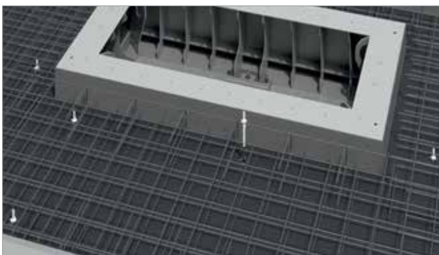
4. Paigaldage Schöcki Isolink® tüüp C-SH eelpuuritud soojusisolatsioonikihti
