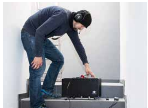
Mesure du bruit de choc au moyen d'un broyeur à marteaux standard.
