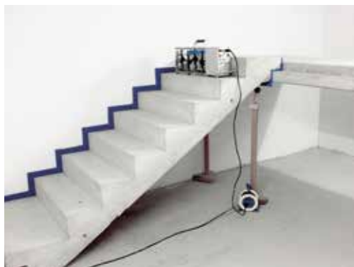
Configuration de test proche de la réalité et conforme selon la norme DIN 7396.
