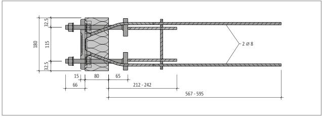
Fig. 81: Schöck Isokorb® T type SQ-V1: Plan view
