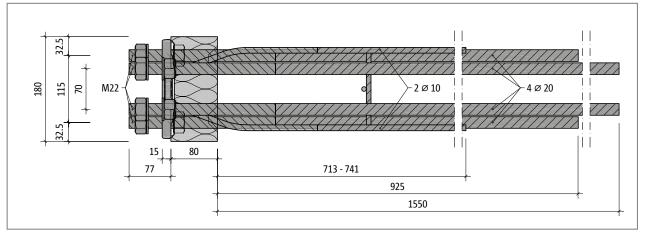
Fig. 33: Schöck Isokorb® T type SK-MM2-VV1: Plan view
