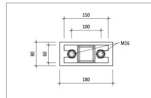
Fig. 119: Schöck Isokorb® T type S-V-D16: Product elevation
