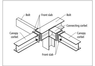
Fig. 100: Schöck Isokorb® T type S: Outer corner
