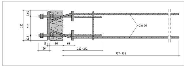
Fig. 82: Schöck Isokorb® T type SQ-V2: Plan view
