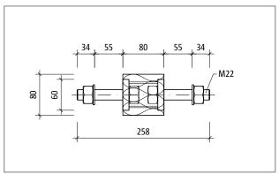
Fig. 118: Schöck Isokorb® T type S-V-D22: Cross-section
