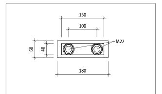
Fig. 114: Schöck Isokorb® T type S-N-D22: Product elevation
