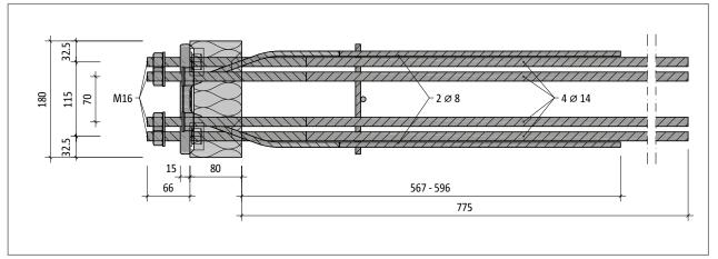
Fig. 32: Schöck Isokorb® T type SK-MM1-VV1: Plan view
