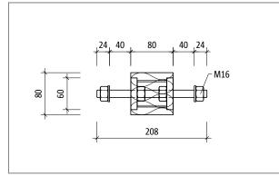
Fig. 117: Schöck Isokorb® T type S-V-D16: Cross-section
