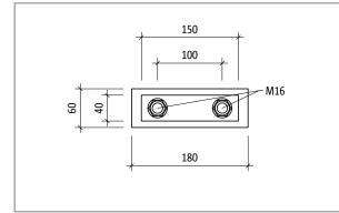
Fig. 113: Schöck Isokorb® T type S-N-D16: Product elevation
