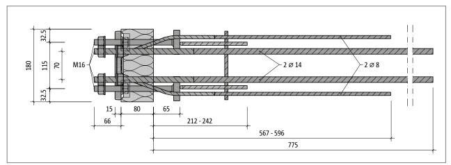
Fig. 31: Schöck Isokorb® T type SK-M1-V1: Plan view
