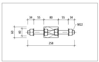
Fig. 112: Schöck Isokorb® T type S-N-D22: Cross-section
