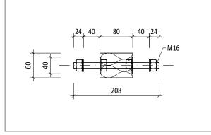
Fig. 111: Schöck Isokorb® T type S-N-D16: Cross-section
