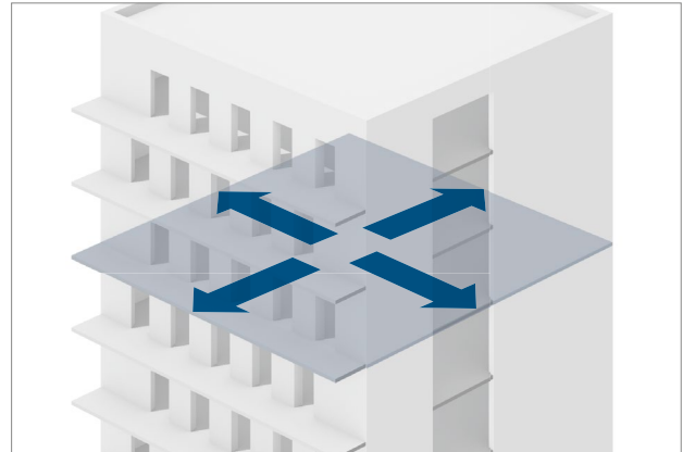
Abb. 11: Bewegungsrichtungen eines Gebäudes bei einem Erdbeben
