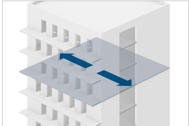
Abb. 13: Bewegungsrichtung parallel zur Dämmfuge
