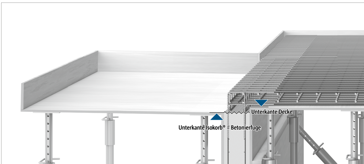
Abb. 39: Schöck Isokorb® T Typ KL: Schalungs- und Bewehrungsvorbereitung für das Betonieren. Betonierfuge Wand = Unterkante Schalung Balkon!
