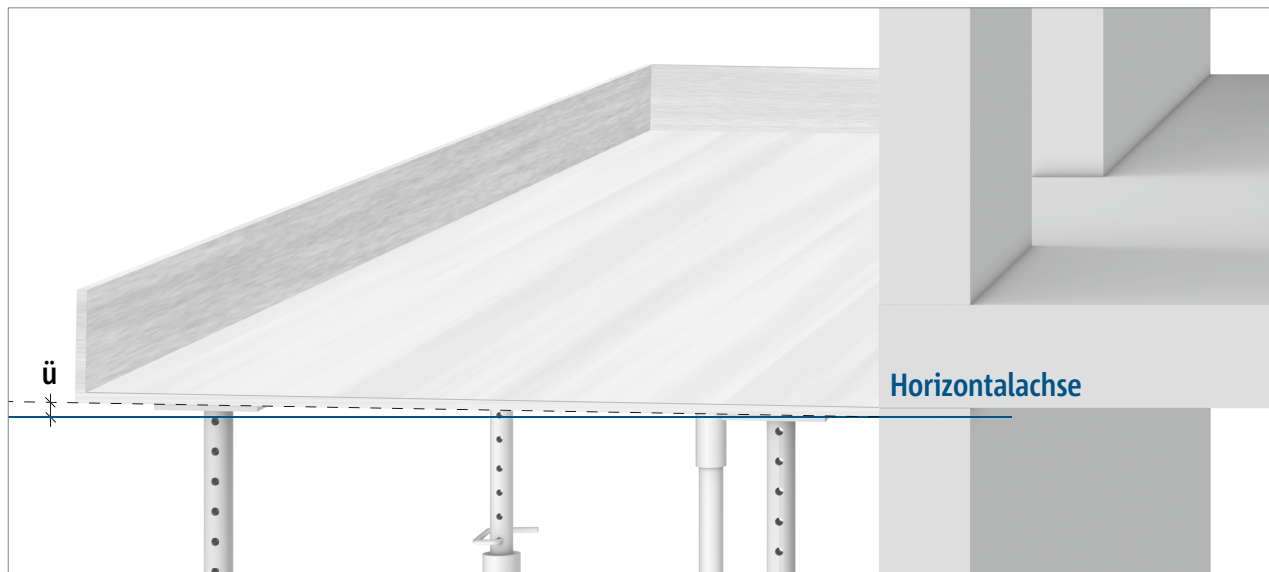
Abb. 20: Überhöhung der Schalung beim Betonieren
