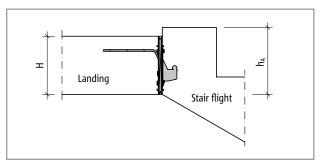
Fig. 47: Schöck Tronsole® type T: Connection height hA
