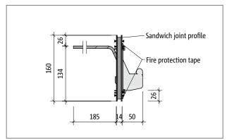
Fig. 31: Schöck Tronsole® type T: Product section T...-H160
