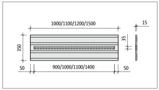
Fig. 176: Schöck Tronsole® type B-V2-L...-B350: Product layout
