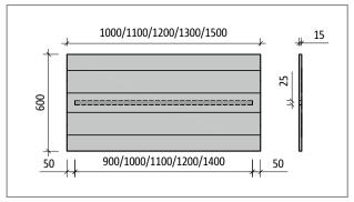
Fig. 177: Schöck Tronsole® type B-V1-L...-B600: Product layout
