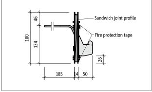
Fig. 32: Schöck Tronsole® type T: Product section T...-H180
