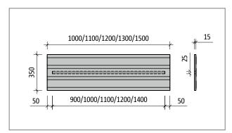
Fig. 175: Schöck Tronsole® type B-V1-L...-B350: Product layout
